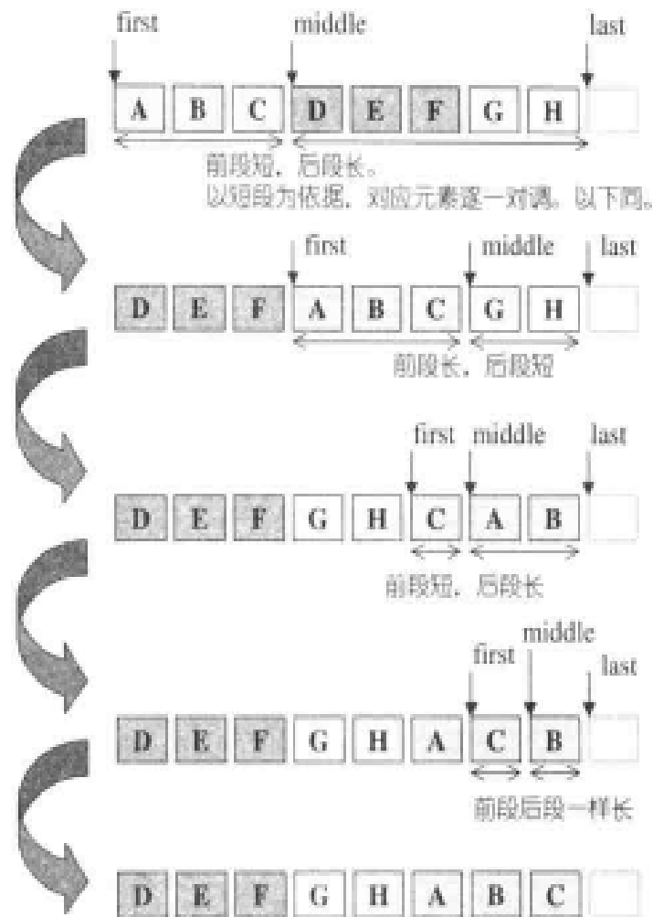
图 6-6h rotate forward iterator 版操作示意
