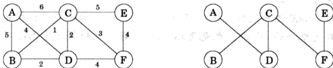
图 5-1 基于 Kruskal 算法得到的最小生成树
