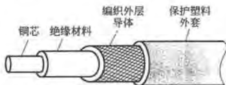
图 2-4 同轴电缆示意图
