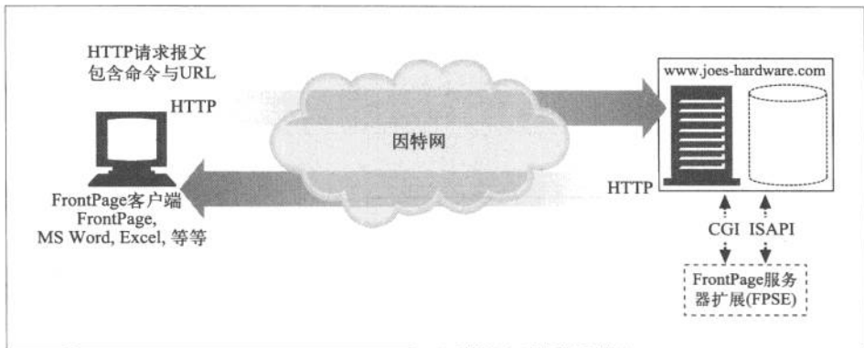
图 19-1 FrontPage 发布系统体系结构
