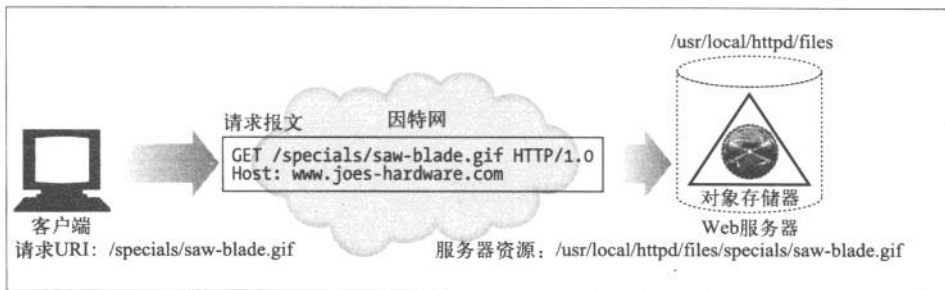
图 5-8 将请求 URI 映射为本地 Web 服务器上的资源
