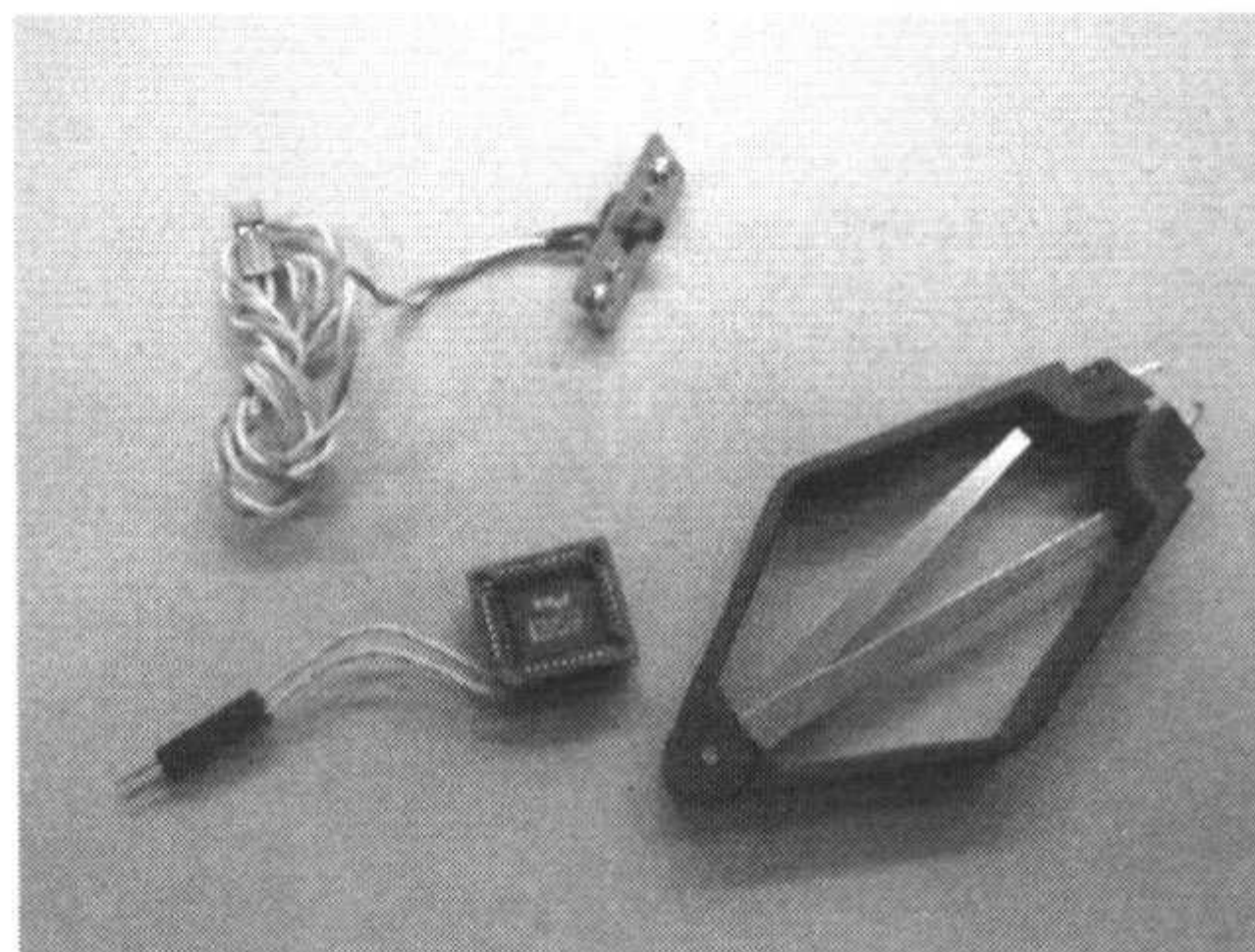
图 32.2 BIOS Saviour 从运行中的主板上移走芯片
