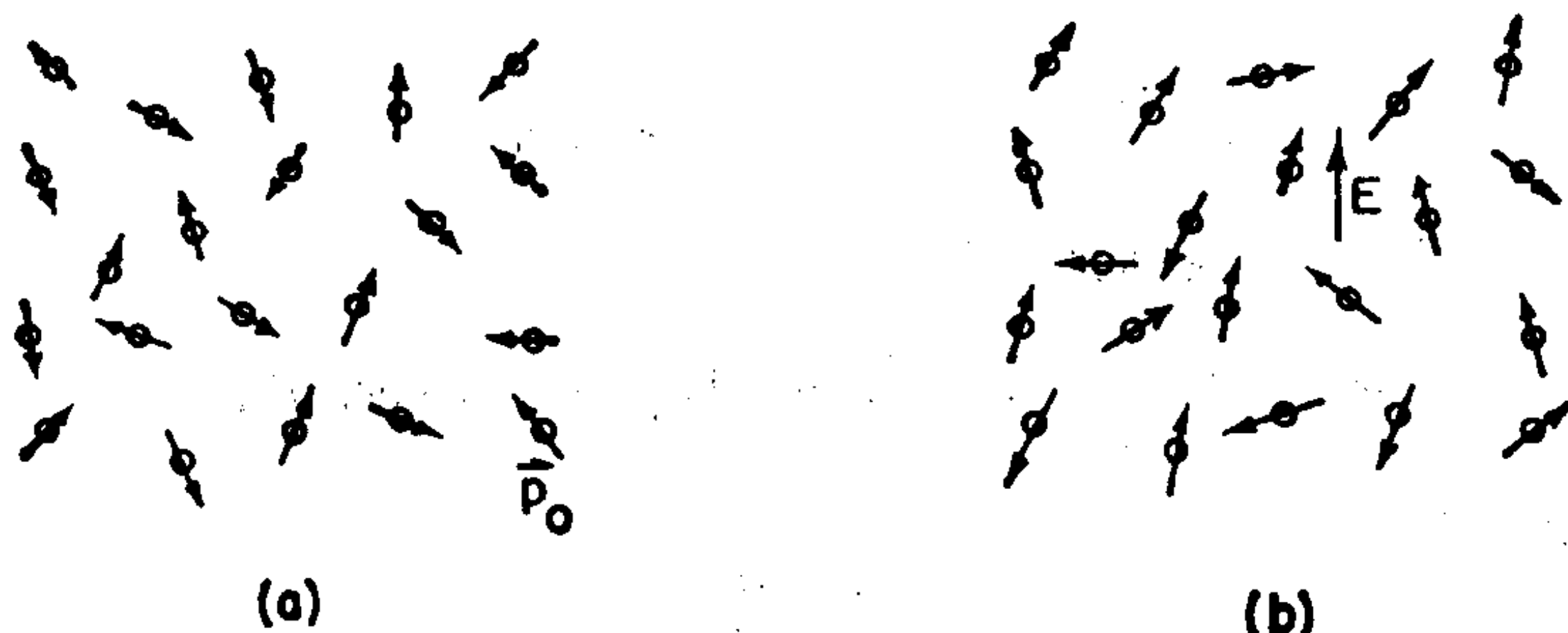
图 11-2 (a)在有极分子的气体中,各别偶极矩无规取向,在一小体积里的平均矩为零; (b)当有电场时,分子们就有某种平均取向了
