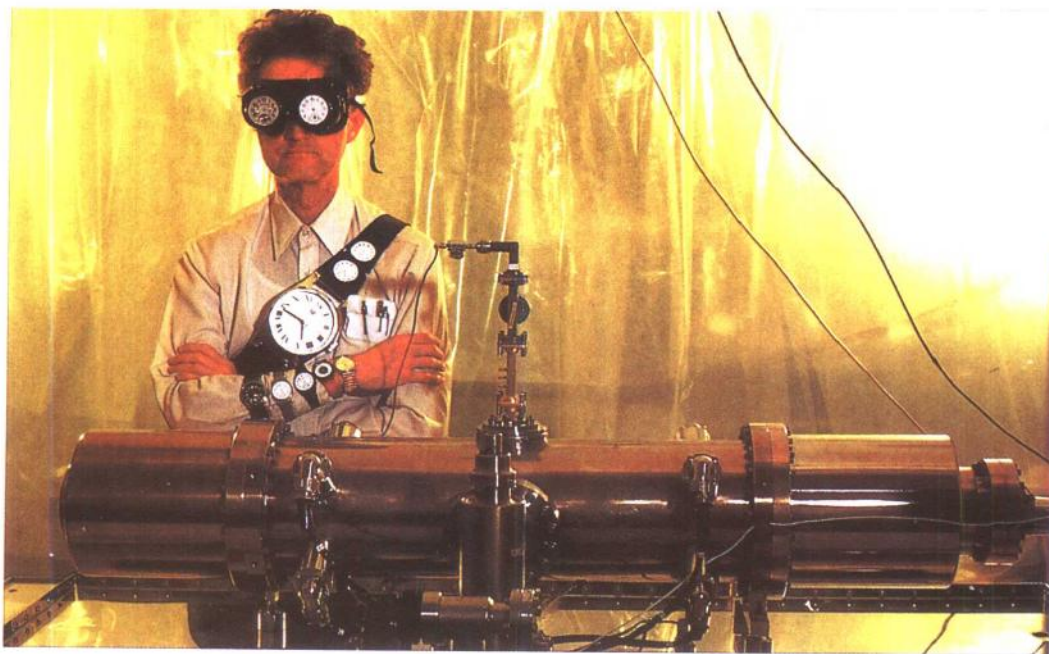
上图：美国铯钟的管理人 标准秒是基于两个磁铁之间的蒸发的铯 133 原子的振动的计数 对面图：能足够精确计算经度的第一架经线仪,1735 年
