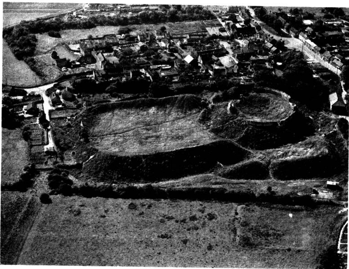
图 11.1 城堡旧址 英格兰 这座城堡在 1066 年之后很快就开始建造，在斯蒂芬的无政府时期完成。城堡本身位于右边的高地上。左边的大片“城堡外庭”(bailey)里可以容纳马厩、仓棚和其他未加防护的建筑。从图上可以看出，对城堡来说，土木工事和居高临下的视角跟坚固的防护墙一样重要。
