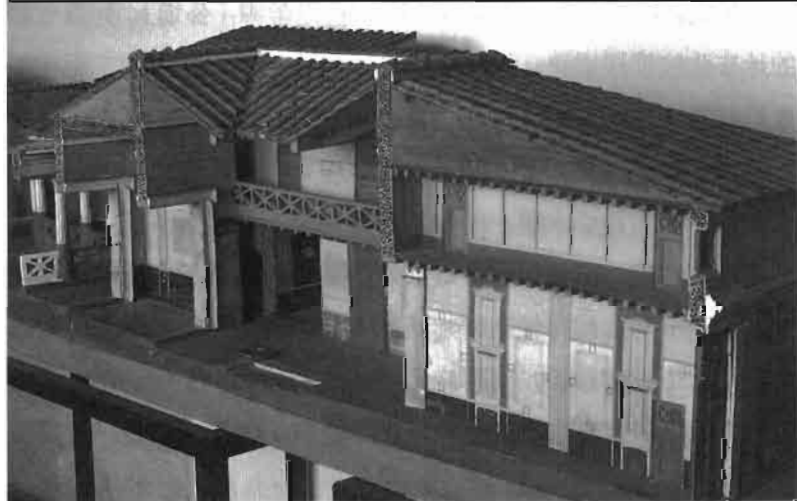
Domus 的雨水利用法。上為剖面圖、中為平面圖（引用自 J. P. Adam, “La construction romaine. Matériaux et techniques”），而下為 Domus 的復原模型（中間向內側傾斜的屋頂下可見到雨水槽）
