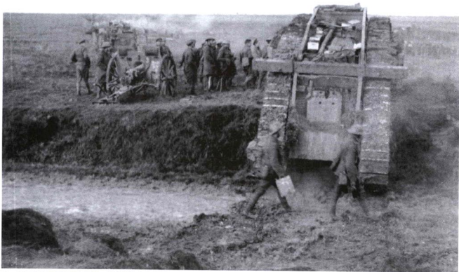
■ 一輛正準備開動的英軍坦克，從造型上看應該屬於馬克II型，因為車體尾部沒有導向輪。
