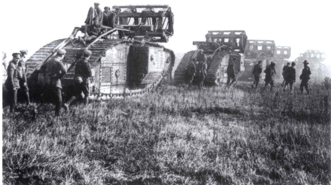
■ 在陣地上排成進攻隊列的英軍馬克IV型坦克攻擊集群，車頂上攜帶的木質構建是提供給坦克用來突破大型壕溝的「腳蹠」——先導坦克在駛到壕溝前投下水架然後側轉，後續坦克便可借助這一支撐穿過而過。
