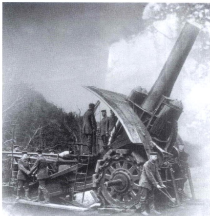
■ 德國克魯伯公司的產品，專門為了突破列日要塞這類堅固堡壘的重型攻城砲，其實質上是世紀攻城臼砲的延伸——只是更大更具破壞力。
