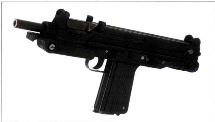
PM-84 (Glauberyt) 采用枪机后坐式自动方式，由金属冲压件制成。机匣上方有适合左右手使用的拉机柄，护手盘上安装一个可折叠的前握把。该枪装备一个双支柱金属枪托，不用时可将其放在机匣旁边。与乌齐冲锋枪一样，弹匣槽位于手枪握把内，据说这种设计旨在方便晚间靠触觉装弹。该枪最初使用 9×18 毫米马卡洛夫手枪弹，但改进型 PM-98 发射更常用的 9×19 毫米枪弹。PM-98 装备的是单边拉机柄，护手盘前面有一个胶壳，用于安装战术灯。
