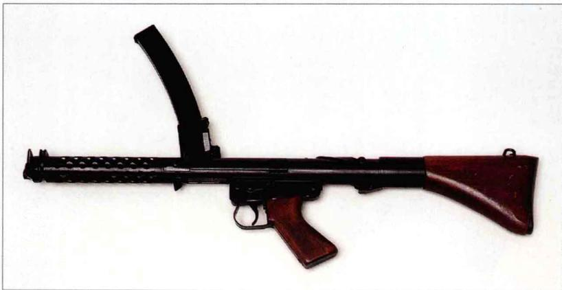
欧文冲锋枪虽然深受军方欢迎，但到 20 世纪 60 年代开始显得有些落伍，因此 1962 年设计并生产了新枪 X3。X3 有很多斯特林枪的特征，尤其是内部结构，可以说是斯特林枪的澳大利亚版，但板机装置明显不同，且拉机柄位于左侧。该枪的照门采用特殊设计，并根据军方要求，保留了欧文冲锋枪将弹匣装在机匣上方的设计。一个有趣的特征是，枪托的狭小部分与机匣巧妙连接，只有这种方式才可能适合 X3 枪的直线设计。作为一种简单而有效的武器，该枪在越南的丛林战中表现卓著，随后被正式采纳，称为 9 毫米冲锋枪 F1。20 世纪 80 年代末，随着 AUG 冲锋枪的问世，F1 冲锋枪停产。
