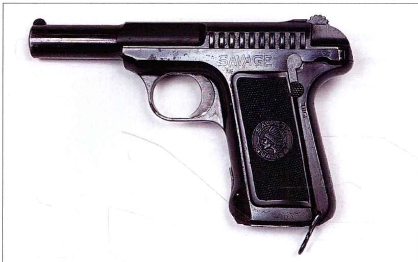
所有萨维奇手枪外形都非常相似，有3种不同的型号：采用锯齿状击锤和锯齿花纹套筒设计的1907型；采用锯齿状花纹套筒、握把保险装置和无击锤设计的1915型；采用扳齿击锤、楔形握把的1915型。20世纪50年代，大量1915型（美国商业产品）被葡萄牙军队购买，因此在南欧被广泛使用，极为常见。
