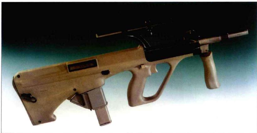
该枪外观与 AGU 突击步枪相似，但枪托和机匣采用聚合材料，且抛壳口只能位于右侧，而不像 AGU 突击步枪那样可通过改装放到左侧。它采用新型 9 毫米口径枪管和枪机，并采用弹匣节套以使用 MPi69 弹匣。该枪的自动方式为枪机后坐式，而不像步枪那样采用导气式。由于枪管较长，因此精确度极高，且比使用同种枪弹的其他枪支拥有更高的初速。斯太尔是最早将突击步枪改装成可发射 9 毫米枪弹武器的制造商之一，这使得生产冲锋枪所需的新部件较少，到目前为止，斯太尔在这方面是最成功的。该公司还曾销售一系列零部件，可用于将任何 AUG 步枪都改装成冲锋枪。
