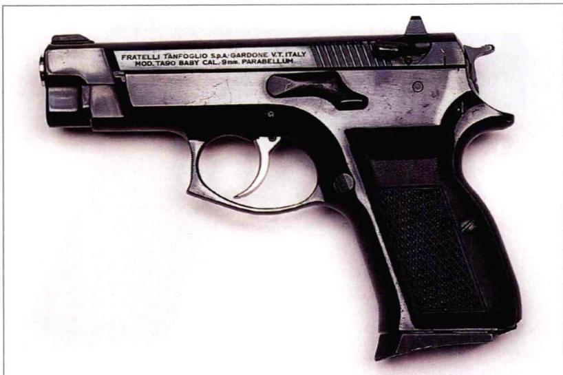
该枪基于 CZ-75 的设计理念，但经过改进和变型，现已成为独创设计。最早出现的是标准型，战斗型与标准型唯一的区别在于保险装置的设计，战斗型可在“待击和闭锁”状态下携带。还有紧凑型标准型和紧凑型战斗型，它们比原型枪短 25 毫米，采用 9 发弹匣。该枪除使用 9×19 毫米巴拉贝鲁姆手枪弹外，还可使用 9 毫米 IMI 手枪弹、0.40 英寸史密斯-韦森手枪弹、0.41 英寸快枪弹、10 毫米自动手枪弹和 0.45 英寸 ACP 手枪弹。
