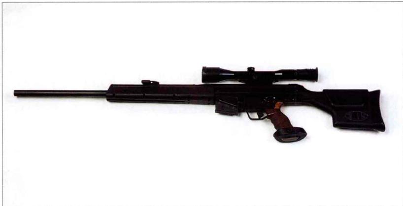
PSG1 是一款高精度狙击步枪，采用赫克勒-科赫公司标准滚柱延迟闭锁系统，枪管特制加长、加重。扳机组件可从手枪握把处取出，扳机力可调，枪托可根据个人需求在各种方向进行调节。该枪未装备机械瞄具，而在机匣上方装有符合北约标准的瞄具座，但通常装备带标尺分划的  $6\times 42$  瞄准镜。该枪精度超众，在 300 米（984.3 英尺）射程发射 50 发比赛弹时，其散布圆直径为 80 毫米（3.1 英寸）。
