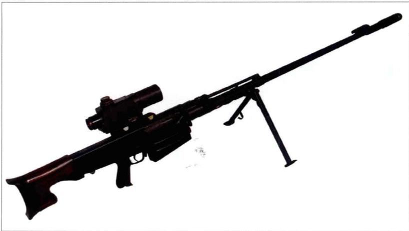
该枪是一款大口径自动装弹步枪，可用作反器材步枪或远距离狙击步枪，使用特制的比赛级枪弹。大型枪口制退器包含多个缓冲板，可降低射击时的后坐力。为缩短长度以方便携带，机匣和枪身通过后膛和机匣的接头相连，而机匣可折叠到枪管的右边。将两脚架折叠后，提把将位于重心处。配备机械瞄具供紧急情况下使用，但该步枪通常使用远距离光学瞄准镜或夜视瞄准设备。最初的型号 OSV-96 也称为 V-94。
