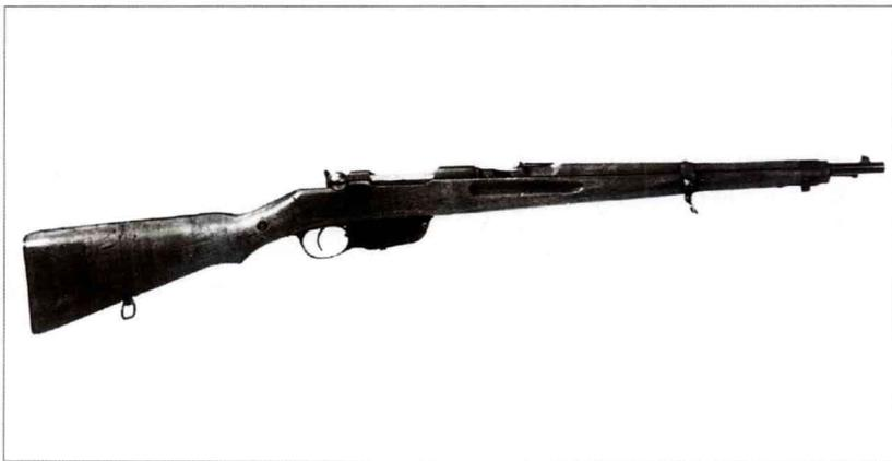
曼利夏步枪采用的直拉式枪机有两种。第一种是枪机下有个楔子，拉机柄运动时将带动它向下，奥地利 M1886 步枪使用的就是这种枪机。第二种是使用带螺旋槽的套筒，套筒内的枪栓有突笋，后拉与套筒相连的拉机柄时，套筒内的螺旋槽促使枪栓旋转并解锁，奥地利 M1895 制式步枪采用的就是这种枪机。这两种设计都可确保枪机没有完全闭锁时，击针将无法向前运动。
