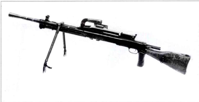
RP-46 是 DPM 的现代化改进型，旨在用作连属支援武器使用。该枪保留了 DPM 的基本构造，主要的改进是增加了弹链供弹系统以提供持续的火力支援。然而，必要时仍可使用 47 发 DP 机枪弹盘，因此 RP-46 仍可作为班用自动武器使用。同样，根据持续火力支援的需要加重了枪管。在前苏联军队中，RP-46 最终被 RPD 所取代，后者由 DP 机枪改进而来。
