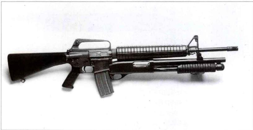
Ceiner Ultimate 融常规军用步枪和霰弹枪功能于一身，其中的霰弹枪通常发射非致命性枪弹，用于防暴或类似情况，而步枪只在真正需要时才用。霰弹枪部件还提供极具价值的近距离防卫功能。Ceiner Ultimate 的步枪部分属于 M16 步枪系列：基本上是将雷明顿 M870P 霰弹枪的机匣和枪管安装在 M16 步枪枪管的下方，而步枪枪管的枪口有用于安装刺刀的凸耳；霰弹枪部分的填装和发射方式与雷明顿 M870P 霰弹枪完全相同。生产的组合很多，还有很多变型枪，这里只提供该系列枪的基本信息。
