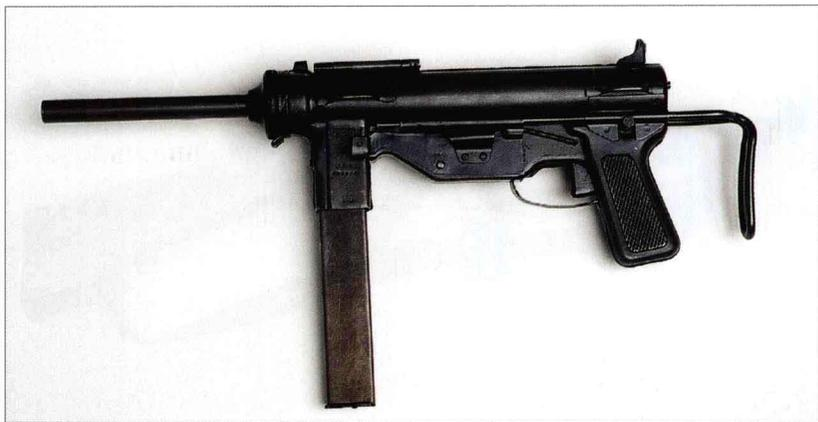
该枪是美国对司登冲锋枪做出的反应，因为美国对司登冲锋枪进行测试后，要求使用简洁而廉价的武器取代汤普森冲锋枪。该枪由乔治·海德设计，并得到一位通用汽车公司的金属锻压专家的协助。M3可更换枪机、枪管和弹匣，以发射9毫米口径的子弹，但在战场上很少进行这样的改装。实践表明，最初的枪机拉杆不可靠，因此改为在枪机上增加大型凸起，用于手动闭锁枪机。
