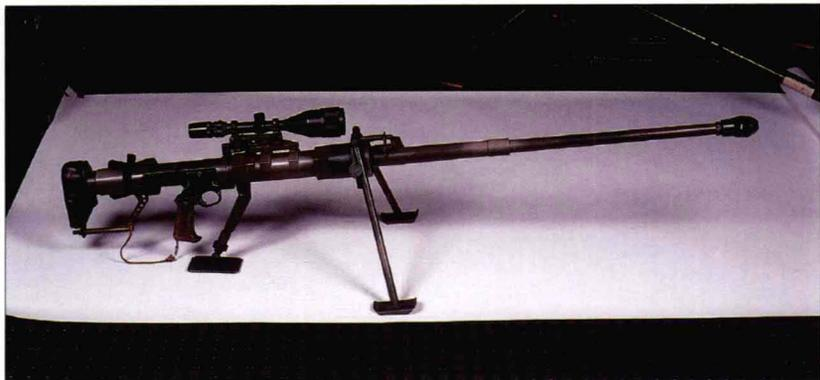
该枪属于单发反器材步枪，发射俄罗斯12.7毫米枪弹。枪管位于加强套筒中，套筒上还安装了两脚架，而枪管节套卡在枪托底板内。手枪握把用作枪机柄，装弹时，向上旋转握把将双卡笋重型枪机解锁，此时可将握把取下。枪弹进膛后向下旋转握把，进入闭锁状态。此时握把中的击锤呈待击状态，扣动扳机即可发射子弹。瞄准时使用12倍光学瞄准镜，距离600米进行射击时，子弹散布不超过300毫米，而使用穿甲弹时可击穿15毫米的装甲。
