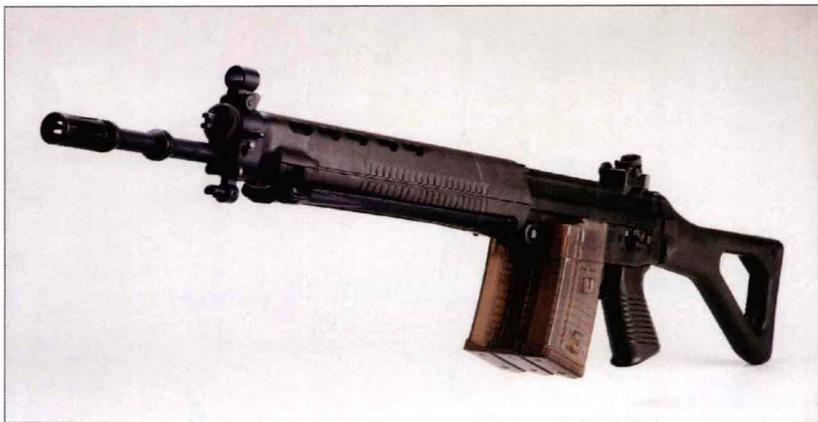
该枪是1984年西格公司为满足瑞士陆军需求而从SG 540改进而来的。西格公司最终在竞争中获得了胜利，并定型号为Stgw 90，取代Stgw 57成为新的瑞士军用步枪。该枪还有民用型，但不能进行连发射击。该枪一个独特之处是塑料弹匣上有螺丝与螺母，可并排安装两三个弹匣。其中一个弹匣插入弹匣口，射击完枪弹后，可迅速卸下弹匣，换上并排安装的其他弹匣。
