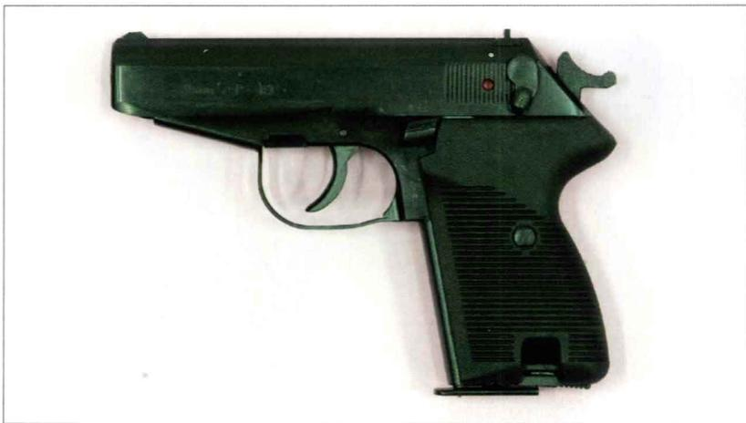
该枪于 20 世纪 70 年代末开始研制，旨在替代当时在波兰军队中服役的 P-64 式手枪。为降低制造成本，该枪大量使用金属冲压、焊接和锻造部件，但仍采用固定枪管后坐系统。扳机可单动和双动，外置保险杆处于保险状态时将释放待发击锤，同时将击针尾部放下，使其无法撞击枪膛中的子弹。套筒后部左侧有子弹上膛指示器，可通过观察和触摸感知。其变型枪 P-83G 可发射空包弹，还可安装枪口配件以发射气弹。还有一种民用型号，它发射 9×17 毫米子弹（9 毫米短弹）。
