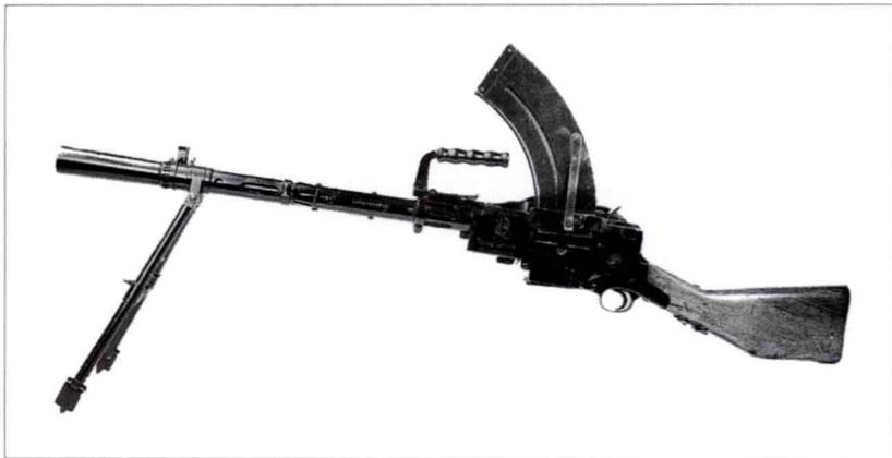
据说麦德森机枪的卓越之处不在于性能优良而在于其实用性。其枪机机构实际上是 Mart 英寸 i 枪机的改进型，凸轮在枪管后坐力的驱动下上下移动枪机。由于没有枪栓推动枪弹上膛，因此设计一个独立的推弹杆。枪弹上膛时，实际上是沿曲线运动，这在理论上几乎不可能。然而，该枪是第一款实用的轻机枪，并开创了弹匣上方供弹的先河。19 世纪 90 年代丹麦海军采用了该枪，首次投入实战是随俄国士兵参加 1904 年的日俄战争。从此以后，经过细微改进的型号生产了长达 50 年之久，在世界各地广泛应用于陆地、坦克和飞机上，却没有成为任何国家的制式武器。
