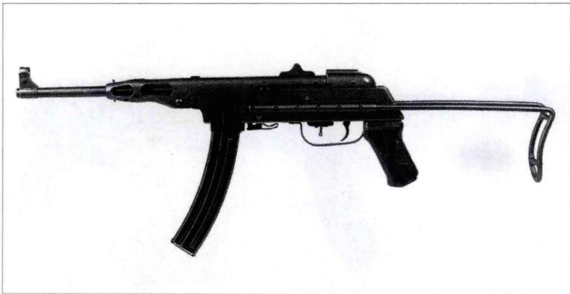
越南根据中国的50式冲锋枪重新设计和生产，成为K-50M。主要改动是去掉了可折叠枪托，取而代之为可伸缩枪托，缩短了枪管套筒，去掉枪口制退器，并增加了手握把。弯曲式弹匣与中国制造的50式冲锋枪型号相同。上述改进使其成为了一款独特的武器，很难与其他枪型混淆。但就原理而言，它还是与前苏联的PPSh十分相似。
