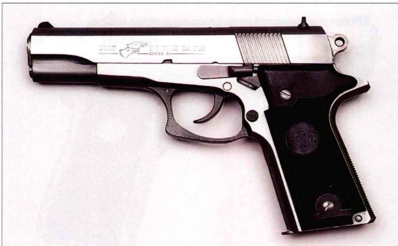
该枪基于政府型 M1911A1 设计，但增加了双动发射装置。双鹰型外型呈流线型，采用反向弧状扳机护圈，可双手射击。变型枪有“战斗指挥者”型和“军官型”，其中前者更紧凑，枪管长 114 毫米，还可使用 0.40 英寸史密斯-韦森枪弹，而后者枪管长 89 毫米，只能使用 0.45 英寸枪弹。
