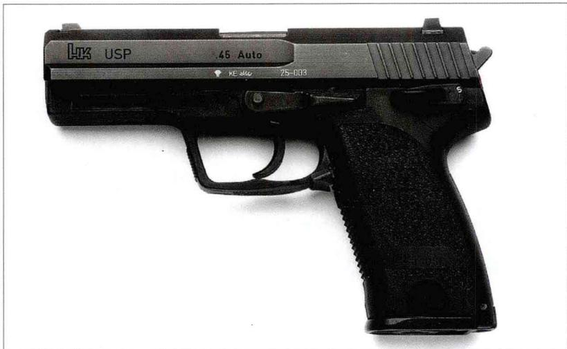
USP(通用自动装填手枪)手枪融合了执法部门和军方认为至关重要的所有特点,它采用勃朗宁凸耳后膛闭锁系统,并采用由复进簧和缓冲器组成的后坐缓冲系统。套筒座由玻璃纤维塑料制成,手枪金属部件经过抗腐蚀表面处理。
