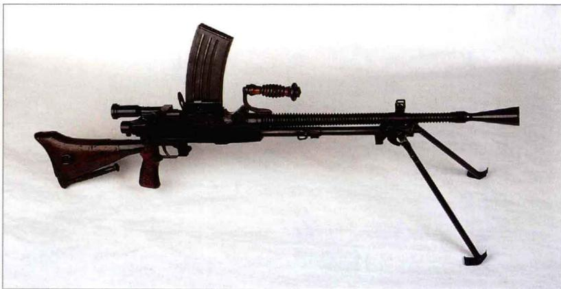
当日本军方决定采用 7.7 毫米无底缘枪弹而不是 6.5 毫米枪弹时，便开始研制发射这种枪弹的 99 式机枪。为缩短研制时间，该枪以 96 式为基础并做了重大改进。7.7 毫米枪弹不需要润滑油，抛壳机构在快速抛壳前先缓慢移动，这解决了所有的弹壳破裂问题；可快速更换的枪管使用起来更方便；最大限度地降低了制造公差。在外观方面，多处借鉴了捷克 vz26 步枪的设计。
