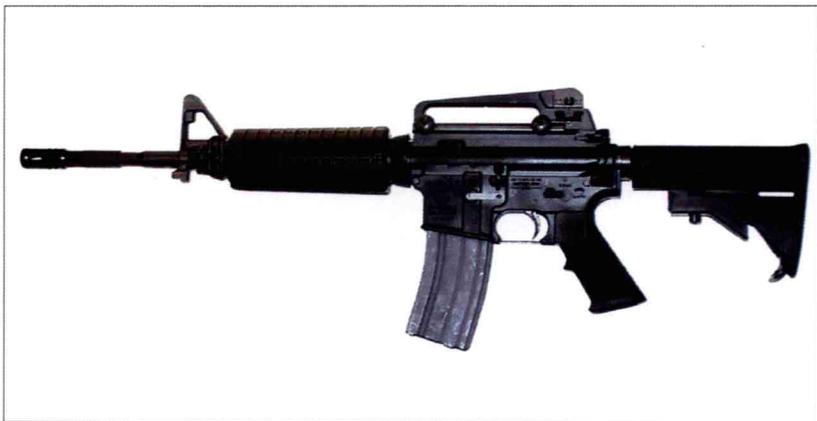
该枪是一款真正的卡宾枪，是采用了伸缩式枪托的 M16A2 短枪管型，可将其看作介于标准步枪和超短突击队员 (Commando) 之间的中间型号。其大部分机械部件与 M16A2 通用，可使用 M16 和北约 STANAG 4179 弹匣。除被美国军队采用外，该枪还装备加拿大陆军 (称为 C8)，很多中南美洲国家的军队也使用它。图示为采用轨适配器系统 (RAS) 的 M4。
