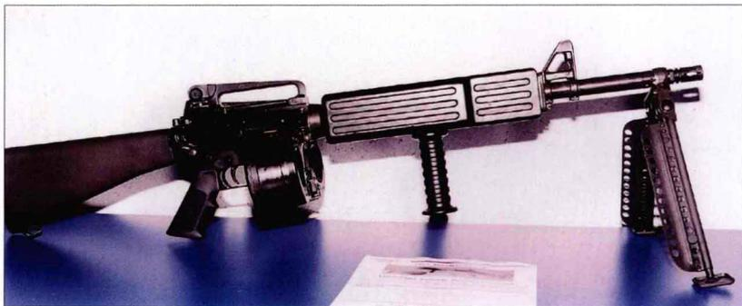
多年来有无数次这样的尝试：生产一款班用火力支援武器，其枪机比标准 M15 系列步枪小，并配以更重的枪管和两脚架；柯尔特自动步枪（柯尔特 750）是最近的尝试之一。该枪借鉴 M16 系列的枪机和自动方式设计，但不支持单发，只能连发射击。重型枪管由硕大的方形护手保护，枪口下方安装 M60 式或类似的两脚架。该枪可使用与 M16 兼容的 30 发弹匣，也可使用 100 发 C-Mag 弹盘（如图所示）。
