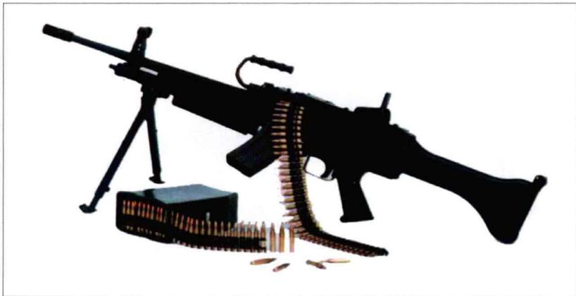
K3 是一款轻型的导气式全自动机枪，似乎从 FN 米尼米吸取了不少设计灵感：使用类似的弹链或弹匣供弹系统，可安装两脚架以用作班用自动武器使用，也可安装三脚架以提供持续的火力支援。照门可以调整射角和风偏修正，准星可调整射角。枪管上有提把，在军事行动中可快速更换以提供持续的火力。由于枪管带有准星，因此每支枪管可分别调整。枪机由气体活塞驱动，并采用回转式设计。
