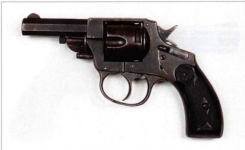
该枪是19世纪90年代至1945年期间德国 Friedrich Pickert 生产的诸多廉价转轮手枪中的一款。虽然价格低廉、构造简单，但用料讲究，曾大量生产并投入使用。分为有击锤型和无击锤型（实际上有隐藏的击锤），枪管长短不同，有发射 0.22 英寸 RF 枪弹、5.5 毫米 Velo-Dog 枪弹、6.35 毫米 ACP 枪弹、7.65 毫米 ACP 枪弹、0.320 英寸枪弹、7.5 毫米瑞士制式枪弹、7.62 毫米纳甘枪弹和 0.38 英寸枪弹的型号。转轮依据口径不同可装 5、7 或 8 发枪弹，有些型号没有退壳杆，必须拔出轴杆将转轮卸下进行退壳。
