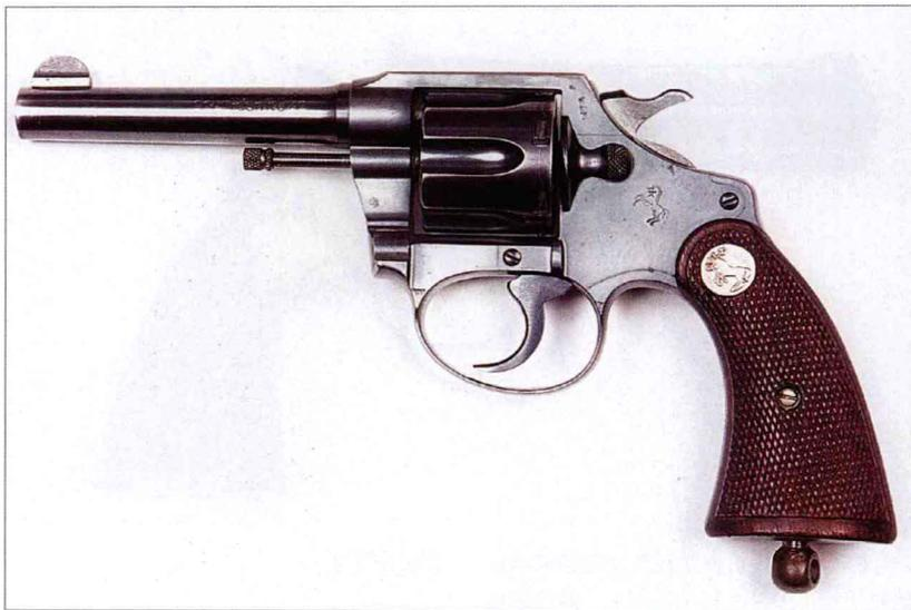
该枪为 New Pocket (新型袖珍手枪) 的改进版, 新增了独特的 Positive Safety (绝对安全)。序列号是连续的, 编号为 30000 以上的手枪都有 Positive Safety 部件。这些手枪可发射 0.32 英寸柯尔特转轮手枪长弹和 0.38 英寸史密斯-韦森转轮手枪长弹。这些转轮手枪的弹巢有微小差别, 旨在发挥各种枪弹的最佳性能, 也可安全地使用这两种枪弹。
