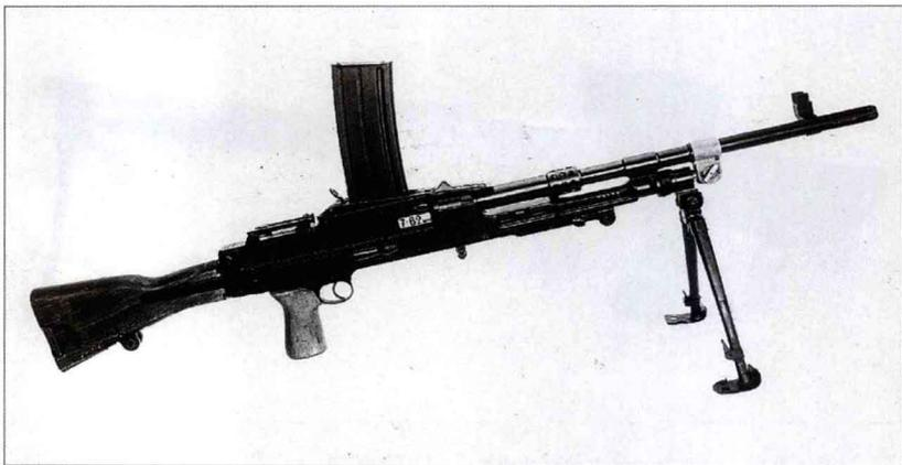
布伦机枪是英国根据捷克斯洛伐克的 vz26 机枪改装而成的。布伦机枪使用 0.303 英寸无底缘英国制式枪弹，而捷克 vz26 机枪使用无底缘 7.92 毫米毛瑟枪弹；它使用独特的弧形弹匣，还对内部构造做了一些不明显的细微改进。该枪性能可靠，精度高，射速慢，可能是二战期间最好的轻机枪。后来改造成了 7.62 毫米北约口径，现在仍在印度使用。该枪有几种型号，它们的区别在于瞄具、枪管长度、两脚架和制造工艺的细腻程度，但操作原理都相同。图示为 7.62 毫米口径的 L4 系列布伦机枪。
