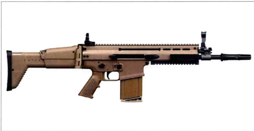
FN SCAR(特种部队战斗突击步枪)有两种型号: SCAR-L(轻型)和SCAR-H(重型),其中前者发射5.56毫米北约制式枪弹,属于MK 16 MOD 0,后者使用7.62毫米北约制式枪弹,属于MK 17 MOD 0。SCAR系列按照人类工程学设计,有大量部件,旨在减少训练时间和保养负担。这两种型号都可在前托上安装MK 13 MOD 0增强型榴弹发射器模块,并装备折叠式枪托和折叠式机械瞄具。各面安装了多个Mil-Std 1913(皮卡汀尼)导轨,浮动式枪管提高了射击精度。
