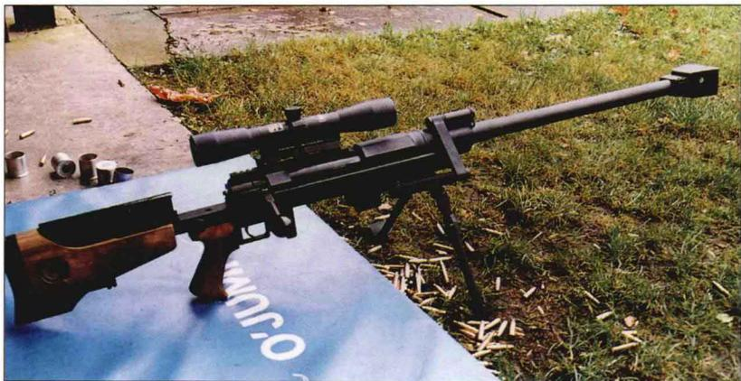
PGM 公司以生产运动步枪而闻名于世，20 世纪 80 年代末，该公司研制了一系列狙击步枪，被法国和其他欧洲国家的警察部队广泛使用。“赫式忒”步枪是 Intervention 狙击步枪的放大型，它采用传统的枪机回转后拉式。木制枪托和腮垫在搬运时可以拆下，下面有一只撑架，机匣下安装了两脚架和手枪握把。枪口制退器可很大程度上减少后坐力，也可将其更换为消声器。该枪装备法国陆军，在比利时称为 FN EHRSTAL。
