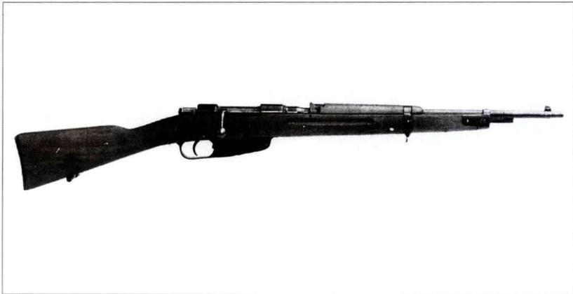
一战的经验表明，意大利 6.5 毫米枪弹威力不足，北非和阿比西尼亚的战斗经验进一步证明了这一点，因此制造的 M1938 步枪和卡宾枪采用新型 7.5 毫米枪弹。然而，意大利于 1940 年参战时，决定让这些新武器退役并用于装备民兵，以简化战场的弹药供应。1944 年改造了少量卡宾枪，以发射德国 7.92 毫米毛瑟枪弹。这些改进枪的枪膛上方有“7.92S 标识”，但尽量不要使用这些改装后的武器。
