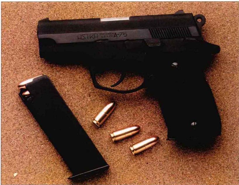
该枪可以说是 A-70 手枪的双动型，结构紧凑而结实，可发射两种大威力枪弹。最初装备警察和军队，后来在民用市场销售也大获成功。1994 年发布了铝制套筒座型号，并准备于 1995 年生产使用 0.45 英寸 CAP 枪弹的型号，但不久阿斯特拉公司便倒闭了。
