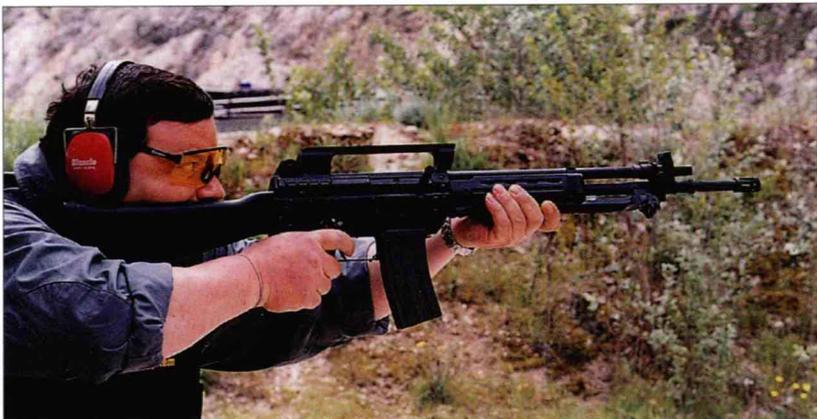
该枪是伯莱塔公司研制的第一款 5.56 毫米口径步枪，采用导气式工作原理和双突笋枪栓。该枪装备意大利特种部队并出口到其他一些国家，但未能占据较大的市场份额，且使用中暴露出了一些小缺陷，如机匣强度不够。它有一些变型枪：除采用实心枪托的标准型外，还有长枪管折叠枪托型和短枪管折叠枪托型。该枪的枪口经过改进可用作枪榴弹发射装置，只要向上扳动铰接在导气箍上的活栓就可装填并发射枪榴弹，这也切断了气体流向活塞筒的通道，确保发射枪弹产生的所有火药燃气用于发射枪榴弹。
