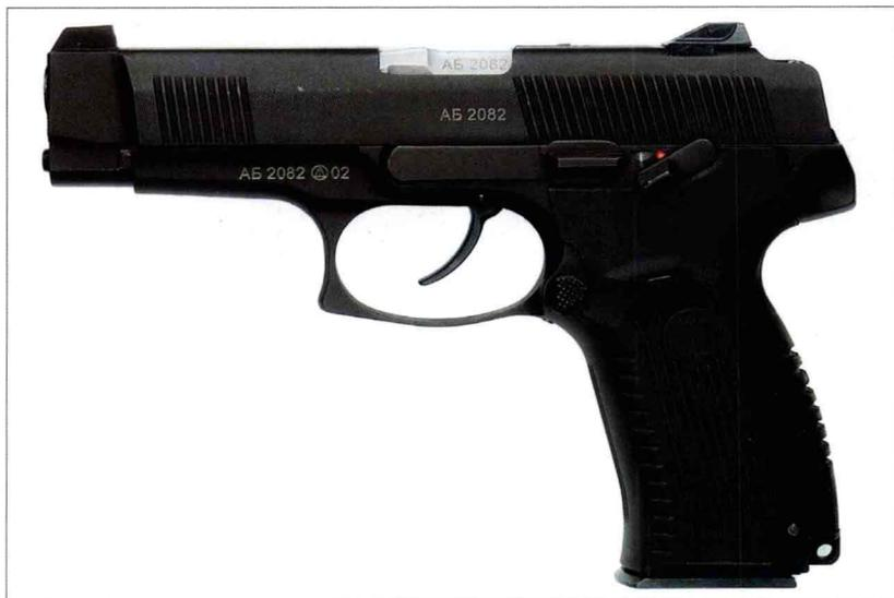
雅利金“格拉奇”由伊热夫斯克兵工厂生产，被俄罗斯陆军选择用于替代长期服役的马卡洛夫手枪。其套筒座和套筒为钢制，握把用聚合物材料包裹。手动保险杆适合左右手使用，设置为保险状态时将阻止阻铁、击锤和套筒运动。退壳杆同时用作枪弹上膛指示器。士兵可根据自己的左右手使用习惯相应地翻转弹匣扣。该枪发射高性能7H21穿甲弹。其变型枪包括民用MP-446和MP-446P（“维京”），后者供执法人员使用。
