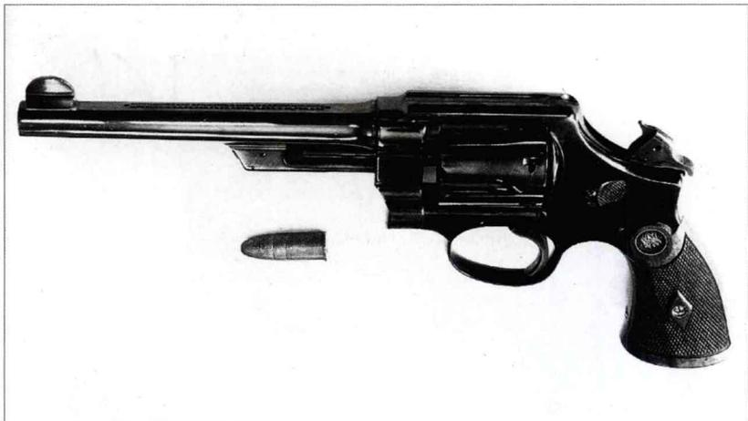
该枪是当时史密斯-韦森系列的主导产品，因为枪管下方有三重转轮锁而称为“三重锁”。共生产了大约20000支，其中超过13000支发射0.44英寸史密斯-韦森枪弹，少量发射0.45英寸柯尔特枪弹、0.44英寸史密斯-韦森苏制枪弹、0.450英寸Eley枪弹和0.44-40英寸温彻斯特转轮枪弹。1915年~1917年间为英国陆军生产了5000支，发射0.455英寸温普利枪弹。
