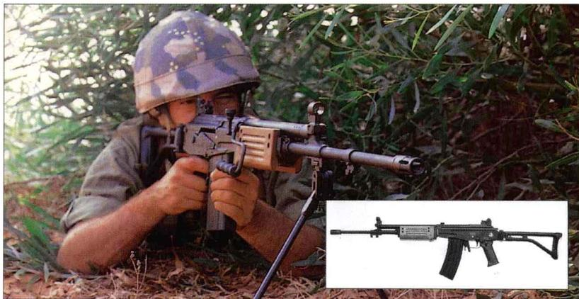
该枪是以色列对几乎每款步枪都进行仔细研究后的产物。它最终选择了一款卡拉什尼科夫回转式枪机系统的改进型；事实上，最初的伽利尔步枪很大程度上是根据芬兰的M62步枪设计的，而M62本身也是AK-47的仿制品。最初口径为5.56毫米，后来也生产了7.62×51毫米型，但这种型号不如5.56毫米口径型那样深受欢迎。该枪被以色列防卫部队装备使用，还被多个中美洲、南美洲和非洲国家的军队采用。
