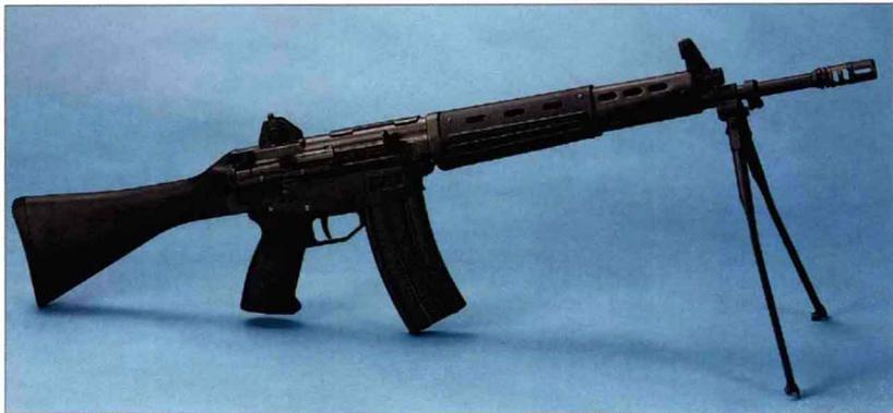
该枪由日本防卫厅设计，并作为日本标准制式步枪逐渐取代 64 式自动步枪。它采用导气式工作原理，闭锁方式为枪机回转式；独特的导气系统确保作用于导气活塞的初冲量较小，以降低后坐力并提高武器的寿命。该枪有固定枪托型和折叠枪托型，二者都装有两脚架。该枪的另一个独特之处是采用独立的三发点射装置，这样如果该装置出现问题，也不会影响单发射击和连发射击。
