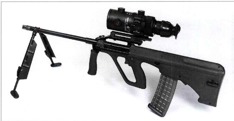
该枪基本与斯太尔-曼利夏 AUG 自动步枪相同，但采用重型枪管并安装两脚架，作为轻机枪使用。枪管的膛线缠距为 178 毫米、228 毫米或 305 毫米，膛口装置在连发射击时消焰以及减轻后坐力和枪口上跳。该枪有两种型号：HBAR 和 HBAR/T，前者与 AUG 步枪一样有提把和嵌入式光学瞄准具，后者有瞄准具座，可安装各种望远镜或夜视仪。HBAR 和 HBAR/T 两种型号都可根据需要进一步改装成开膛待击，枪托中新增了一个击锤组件，枪机组件中新增了待击尾块。对现有的武器也可进行这种改装。开膛待击不会影响射击特征。
