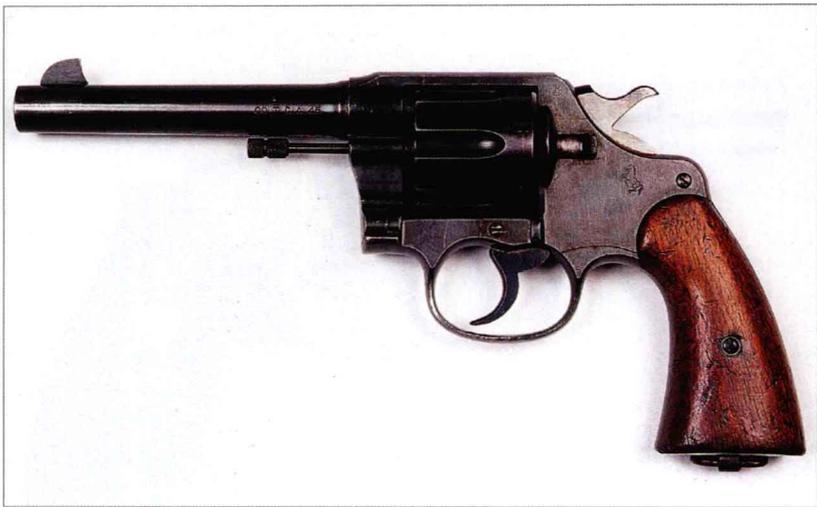
1917年，由于手枪短缺，美国军方要求柯尔特和史密斯-韦森生产转轮手枪以填补空缺，但要求这种转轮手枪能够发射柯尔特自动手枪使用的0.45英寸自动手枪弹。因此M1917成为新制式武器，它采用较短的转轮，以便使用两个三发弹夹将0.45英寸的无边缘ACP枪弹装入弹巢，并让退壳杆能够退出弹壳。该枪在二战期间一直在服役。
