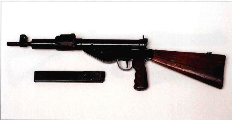
生产司登 Mark V 旨在提高武器质量，提供一种比 Mark II 更昂贵的冲锋枪。其结构并未改变，但采用木制枪托和木制握把，枪口形状与 No.4 制式步枪相同，以便安装标准刺刀。该枪表面经瓷漆处理，早期型号的枪托底板由黄铜制成，并有可装入清洁工具的活门，但后期型号的枪托底板由钢片制成，也没有这样的活门。然而，该枪最大的缺陷是弹匣，且一直没有改进，因此与以前的型号相比，Mark V 的可靠性并没有多大改善。
