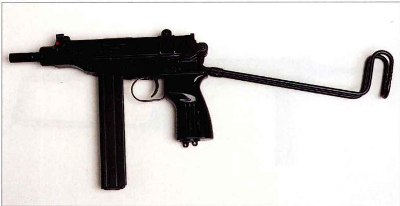
该枪最初是为装甲车辆内人员设计的一款单兵自卫武器，与其说是一款冲锋枪，不如说是一款轻型自动手枪。该枪枪身上方装备金属条枪托；手枪式握把内的降速机构使射击速度可达800~900发/分，很快可将弹匣中的枪弹打完。盒式弹匣的容弹量为10或20发。最初的型号为61型，发射0.32英寸CAP枪弹，这也是最容易见到的型号。这种型号于20世纪70年代中期停产，但现在仍可供出口。为提高销量，该枪支现有发射9×18毫米马可洛夫手枪弹、0.38英寸ACP枪弹和9×19毫米巴拉贝鲁姆手枪弹的型号，其中最后一种型号的尺寸稍微加大了。可安装各种战术附件，如反射式瞄准镜和战术灯。
