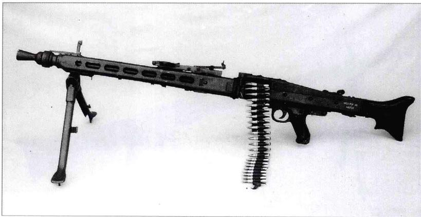
MG34 虽然性能很好，但构造过于复杂、造价昂贵，因此德国陆军于 1941 年要求设计一款具备 MG34 的各种优点但更容易批量生产的枪支。毛瑟公司邀请锻造专家参与重新设计 MG34 的工作，最终的成果就是 MG42。该枪采用新型闭锁机构，可快速更换枪管，防尘性能极佳。20 世纪 50 年代，由于找不到能同 MG1 及后来的 MG3 媲美的武器，德国陆军决定将 MG42 重新投入生产并使用至今。有些被奥地利和意大利军方采用，称为 MG42/59；南斯拉夫获得许可生产该枪，称为 Sarac。伊朗、意大利和西班牙在不同时期获得许可生产过 MG42 及其变型枪；当前该枪仍被许可在希腊、巴基斯坦和土耳其生产。
