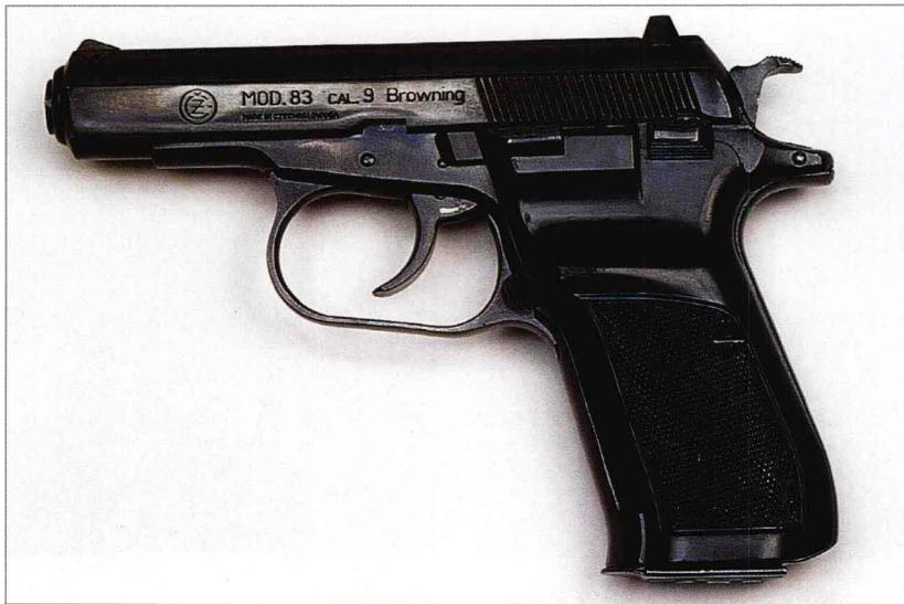
CZ83 为常规双动枪机后坐式紧凑型自动手枪，是捷克共和国的马卡洛夫型，在捷克军队中占有同样重要的地位。该枪做了一些改进，如自动击针保险系统，适合左右手操作的保险和弹匣扣，扳机护圈很大，可以戴手套操作。在 7.65 毫米和 9 毫米短口径的枪型中，膛线是常规的，但在使用 9 毫米马卡洛夫手枪弹的口径枪型中，膛线是多边形的，也就是枪管部分像一个四条边稍微鼓起的圆形。
