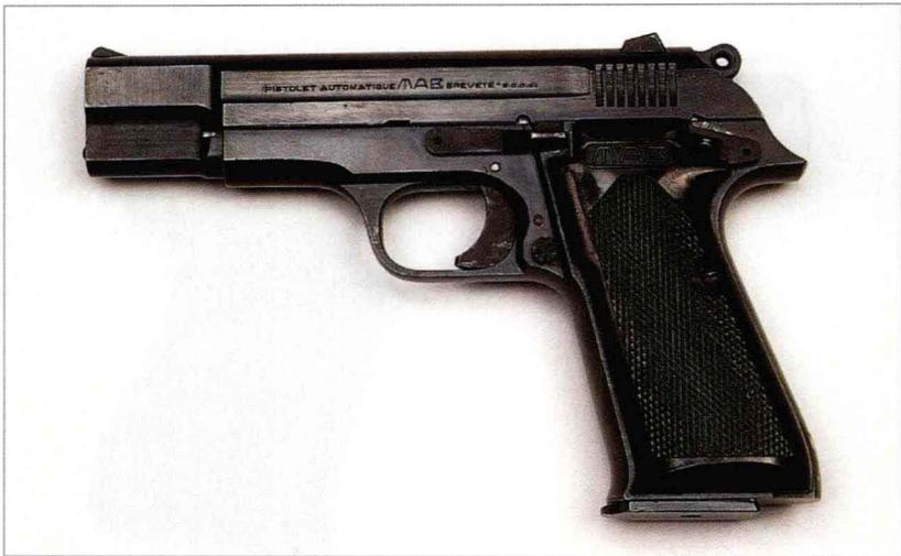
20世纪60年代法国军方采用的一种军用手枪，同时也供商业出售。特别之处是采用旋转枪管来闭锁枪管和套筒以便发射，复进时枪管回转以松开套筒。还生产了一种长枪管型训练手枪。
