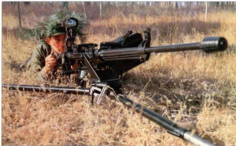
该枪首次出现于20世纪80年代末期，最初设计是用于防空目的，但也可用作陆地机枪使用。采用导气管式自动方式，这在相同口径的武器中很少见。导气管从机匣前端的枪管输出端和调节器直接将燃气作用到枪机体。闭锁机构为改进的 Kjellman 铰转板：两侧的铰转板由枪机体控制向外运动，并锁入机匣壁的凹槽内。该枪由弹链供弹，弹链来自枪身左侧的弹箱。标准配置包括光学高射瞄准镜以及较复杂的防空用三脚架。
