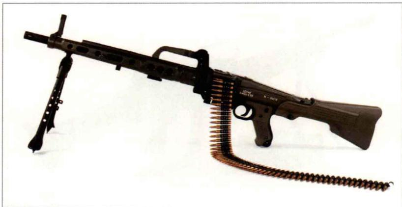
阿梅利机枪看上去就像德国MG42机枪的缩小型，但其延迟后坐系统实际上是从圣·巴巴拉 CETME 步枪改进而来的，与赫克勒-科赫步枪使用的延迟后坐系统极其相似。该枪使用 5.56×45 毫米北约制式枪弹，实际上是一款轻型突击机枪，因为它轻便、紧凑，携带方便，可用于冲锋作战的最后阶段。该枪的早期设计使用与 MG42 机枪相似的 T 型拉机柄，但生产样机采用的是更简单的拉机柄。该枪由西班牙军事装备技术研究中心设计，并由西班牙国营圣·巴巴拉兵工厂制造。它于 1982 年问世，并从 20 世纪 80 年代后期开始装备西班牙陆军。
