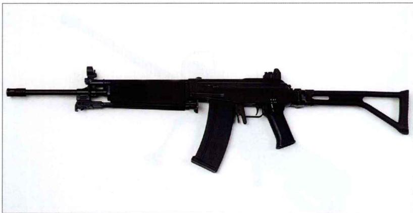
该枪是南非军队标准制式步枪，由以色列加利尔步枪稍加改进而来，改进之处包括：枪托和前护木采用合成材料而非钢材，以适应非洲常见的高温环境；加长了枪托，因为南非士兵的身高普遍高于以色列士兵。另外，其他部件也得到了加强，并装备可切割金属线的两脚架。还有卡宾型 R5 和紧凑型 R6，其中前者枪管长 332 毫米，后者枪管长 280 毫米。这 3 种武器都有半自动型，用于装备警察和准军事部队以及出口。
