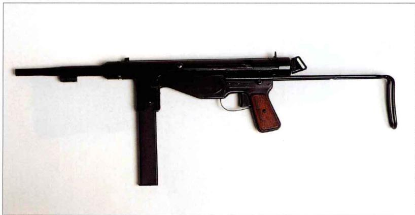
该枪为葡萄牙制式武器，由葡萄牙研发，以其他几种枪支为基础，综合了美国 M3 的枪托和发射原理以及德国 MP40 的枪机和基本结构。该枪结实可靠，和同时代的其他冲锋枪一样，可安装刺刀。它在非洲广泛使用，在各种起义者手中可发现其身影。由于被葡萄牙的殖民地帝汶岛使用，该枪还可能出现在远东地区。存在一种稍加改进的型号，标有 M63 图案，后来被 M1973 所取代，后者安装了带孔的枪管护筒。这些型号的基本结构几乎完全相同。
