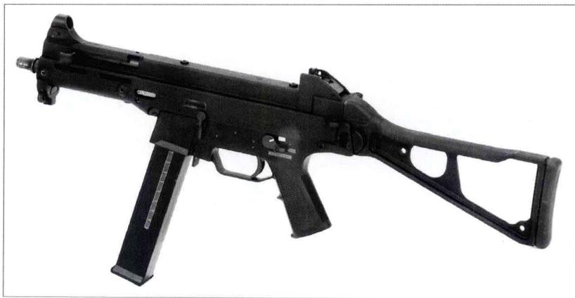
UMP(通用冲锋枪)最初由美国研发和制造,发射0.45英寸ACP手枪弹;德国也制造了该枪,但使用9×19毫米巴拉贝鲁姆手枪弹。该枪采用赫克勒-科赫G36步枪的机匣,并大量使用聚合材料。框架式枪托可折叠到机匣右侧,机匣上方有一个皮卡汀尼导轨,可安装各种反射式瞄准镜或光学瞄准镜;前托下方也有一条导轨,可安装前握把(如图所示)或其他战术配件。通过枪口上的螺纹可安装消声器。
