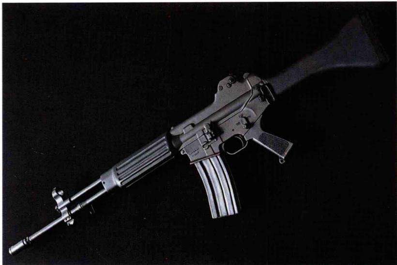
该枪采用导气式工作原理，可选择射击方式——单发射击、三发点射和连发射击，并采用折叠式塑料枪托。枪口装有制退器和可用作榴弹发射器的补偿器。三发点射装置很独特：如果没有完成三发点射，三发点射装置将不会复位，仅当完成两次点射后并再次扣动扳机时才进入单发射击模式。
