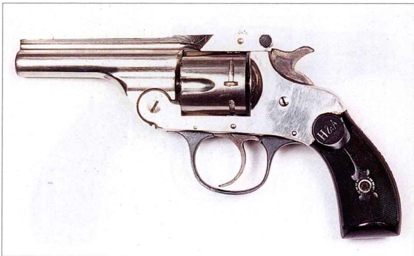
除确保枪管闭合的卡销和独特的扳机机构外,该枪与同时期的其他手枪无太大差别。击锤安装在古怪的轴承上,后拉并松开击锤时,击锤将撞击枪身而不是击针。扣动扳机将旋转轴承并释放击锤,这样击锤才能撞击击针。这就是其名称中包含“安全”的原因。该枪制作精良,设计完美,但数量不多,因为只生产了7年。
