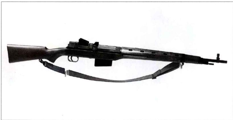
该枪由瑞典于1942年推出，自动方式为气吹式。直到20世纪70年代该枪才装备瑞典军队；1945年到20世纪60年代，该枪装备丹麦军队，其口径为7.92毫米。埃及于1954年购买了瑞典的生产线，并以名称Hakim生产该枪，其口径为7.92毫米。1959年~1960年，埃及对该枪进行了改进以发射7.62×39毫米前苏联制式枪弹，并以名称Rashid进行生产，但数量不多。
