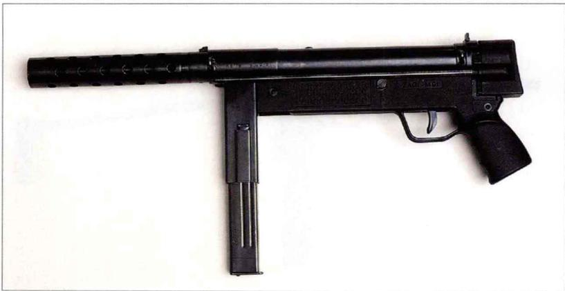
这是一款制作成本低廉的武器，充分显示了设计者独到的见解。机匣和枪管护筒的直径相同，且护筒上打了孔。弹匣槽很长，可作为前握把使用，而不会因弹匣额外受力而导致故障。下机匣表面凸出，可作为前握把使用。枪托用圆钢制成，沿机匣连接到护筒。枪托上有极其短小的托底板。设有推拉保险，但没有单发射击状态。
