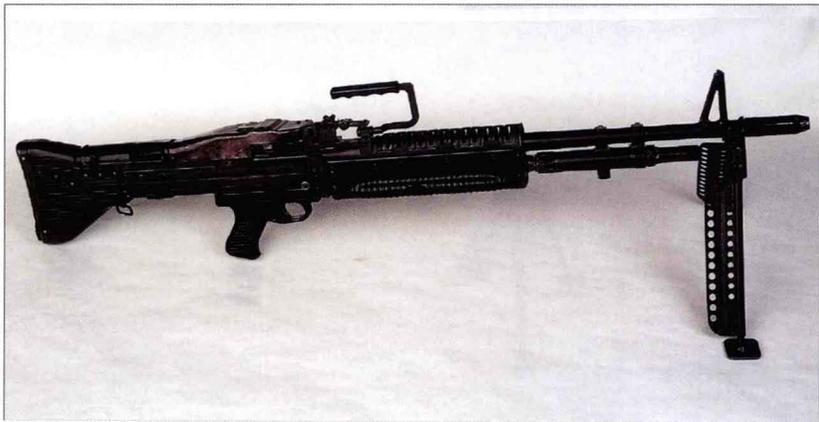
M60 及其改进型 M60E1 是美国陆军的标准班用通用机枪。最初的 M60 存在一些严重缺陷，最显著的是枪管更换方面。每支枪管都有汽缸和两脚架，却没有提把，因此不仅造价昂贵而笨重，且枪管发烫时更换起来也很危险。石棉手套是该枪的配置之一；两脚架随枪管一起更换，因此更换枪管时，机枪手不得不将机枪架在空中。M60E1 采用更简单的枪管，汽缸和两脚架都固定在枪身上，还有供更换枪管时使用的提把。两种型号的一个共同点是都使用硬合金枪管套筒，这延长了枪管的使用寿命。
