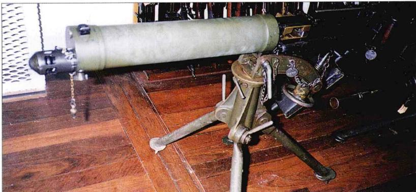
与众多其他国家一样，英国也是从马克沁机枪开始，然后寻求更轻便的机枪。维克斯提供了解决方案：使用高质量钢材和铝材以及更佳的应力分析技术以减轻机枪重量，并改进马克沁环套系统使其更紧凑。最终成果是维克斯机枪，它于1912年开始服役，直至1968年被淘汰也一直没做任何改进。该枪性能可靠，在一战期间创造了持续射击的记录。该枪还被用作标准同步航空机枪，装备最早的装甲车和坦克，并被英国皇家军队和英联邦军队采用，其中有些部队一直使用到20世纪70年代。该枪也有口径0.50英寸的型号，供空军和坦克使用；1915年，美国柯尔特公司制造了大量口径0.30英寸的该枪，供美国陆军使用。在1920年~1938年间，该枪还在商业市场销售，主要出售给南美洲国家。
