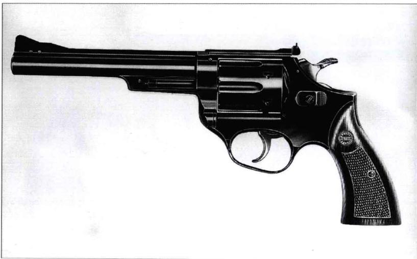
该枪为现代双动型转轮手枪，主要装备警察和用于商业销售。为遵循1968年制定的美国枪支限制法案，对早期卡迪克斯型做了改进，主要是采用导杆装置，使得只有在正确扣动扳机击锤时才会撞击击针。准星呈坡形，扳机护圈平滑顺手，而击锤更大。照门可调，可调节击锤簧力。还有一种枪管长152毫米的型号。该枪的制造商已倒闭。
