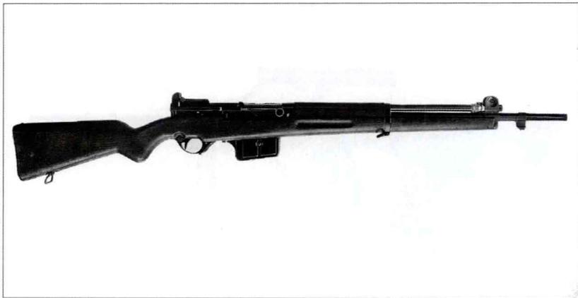
FN 1949 步枪的研发工作实际上从 20 世纪 30 年代就开始了，但因战争而搁浅，直到 1949 年才最终研制成功。该枪曾被比利时、埃及、阿根廷、卢森堡、委内瑞拉、巴西和哥伦比亚等国的军队采用，有口径多种，性能可靠，价格也比较昂贵。该枪的枪机偏转式闭锁机构采用导气式自动方式，后来更著名的 FAL 步枪也采用了这种闭锁机构。枪机打开时，可使用装弹夹完成装弹过程。该枪的设计者 D·赛维二战期间曾在英国恩菲尔德兵工厂工作，其最早型号的口径为 7.92 毫米，于 1946/1947 年由英军进行测试。
