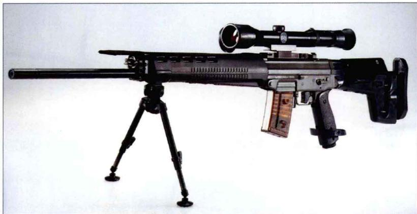
SSG 550 是在 SG 550 标准型的基础上改进而成的，它采用锤锻重型枪管，只能进行半自动射击。单连发扳机、枪托底部长度和贴腮板可调。根据需要也可调整手枪握把，以便安装扶手。装有两脚架，瞄准镜位置可调以适应射手面部贴近贴腮板时的瞄准动作。顶部可安装拖拉式透光板，以防枪管发热形成的热气流影响瞄准。该枪的设计充分考虑了狙击手的人机功效。
