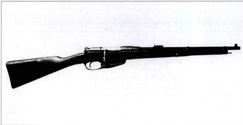
曼利夏和其他回转式枪机系统的主要差别在于其开创性弹夹装弹系统：拉开枪栓，将装有枪弹的弹夹插入弹匣。弹夹中的弹簧将枪弹上推，并由枪栓将其装入枪膛。最后一颗枪弹装入枪膛后，弹夹将通过底部的空洞掉落；但在某些设计中，当最后一颗枪弹发射且枪栓打开时，弹夹将向上弹出。弹夹是弹匣系统中一个不可或缺的部件，如果没有它，弹匣将毫无用处，而步枪将变成单发武器。
