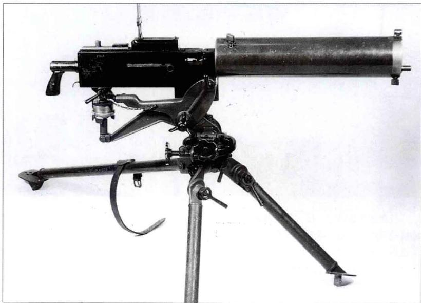
M1917 是勃朗宁原创的枪机后坐式军用机枪，后来的所有型号（BAR 除外）都以该枪为基础。作为 20 世纪初期被广泛接受的形式，它是一款水冷式重机枪，安装在三脚架上，可靠而经久耐用。该枪经受住了二战的考验，一直到 20 世纪 50 年代水冷式机枪被气冷式机枪所取代才退役。
