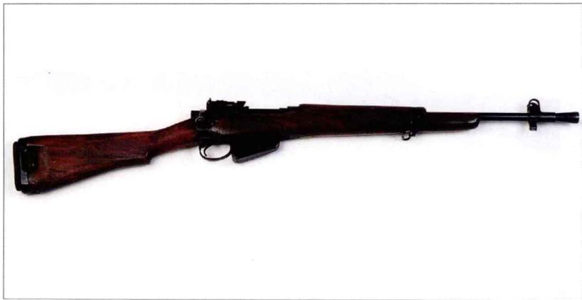
该枪是 No.4 步枪的缩短和轻量型，旨在适应丛林作战。该枪外形美观，但性能不像外形那样优秀：发射大威力枪弹且枪管较短，其后坐力很大，同时照门会不断偏离。设计者曾花费大量时间和精力解决这个问题，但效果不大，因此于 1947 年停产。该枪采用锋状刺刀，而不像 No.4 步枪那样采用尖形刺刀。
