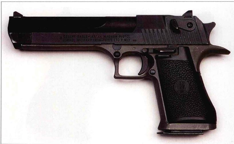
枪型较大、较重，可发射各种大威力枪弹，但最初采用的是0.357英寸马格努姆手枪弹。使用大威力枪弹时，要求枪膛闭锁良好。从固定枪管导气孔出来的火药燃烧气体首先推动活塞向后运动，活塞又驱动套筒后坐，从而使有3个突笋的枪机旋转，再使其闭锁。该枪的套筒座可能采用钢或合金制造，枪管长度各不相同。
