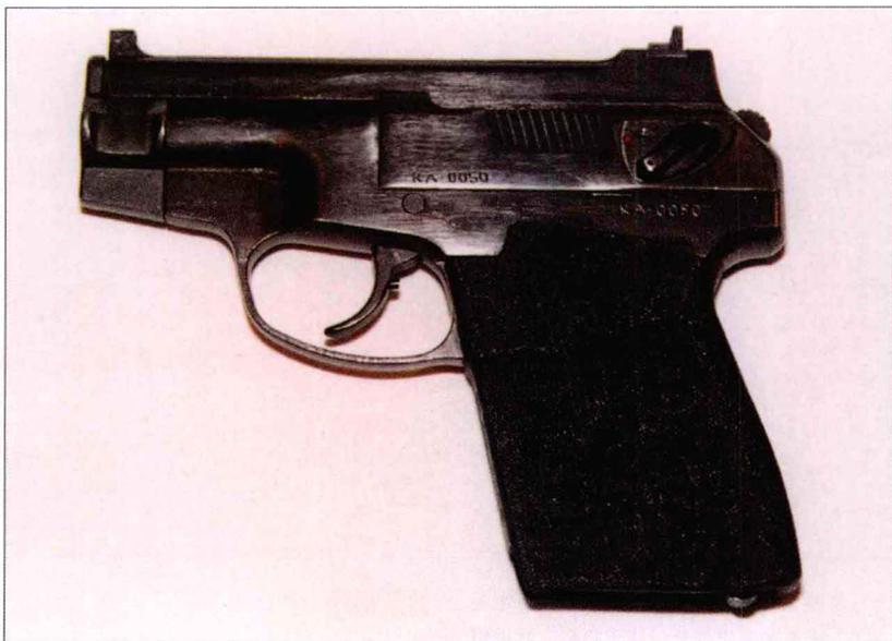
7.62 毫米 PSS 微声手枪也称 Vul，是一种近距离特种部队用手枪，它采用自由枪机式自动原理，并使用一种独特方法消除射击特征。并没有在枪口安装消声器，而是发射一种特制的 7.62 × 42 毫米枪弹。平头弹头与弹壳前缘相连，发射时枪弹中的活塞将弹头推入枪管，而活塞被弹壳的凹口卡住，这样所有的发射火焰和噪音都被限制在弹壳内。我们见到的大多数 PSS 手枪都有基本的涂饰，这表明它们的服役时间不长；另外，除套筒左侧的序列号外，没有任何枪支有其他铭文。
