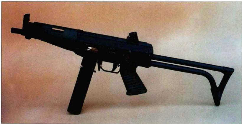
该枪是为智利军方制造的一款武器，也用于出口。设计基于西格 550 步枪，后者为智利特许生产。设计此枪旨在尽可能多地利用步枪的零部件，以节省制造成本。标准型号采用可折叠枪托；还有采用固定枪托的型号、带消声器的型号和 Mini-SAF (迷你 SAF)。Mini-SAF 是一种缩短了了的型号，没有枪托，但有固定的前握把。容弹量为 30 发的弹匣由半透明塑料制成，可通过肉眼观察弹匣内的子弹，还有基座和沟槽，可将多个弹匣连在一起。
