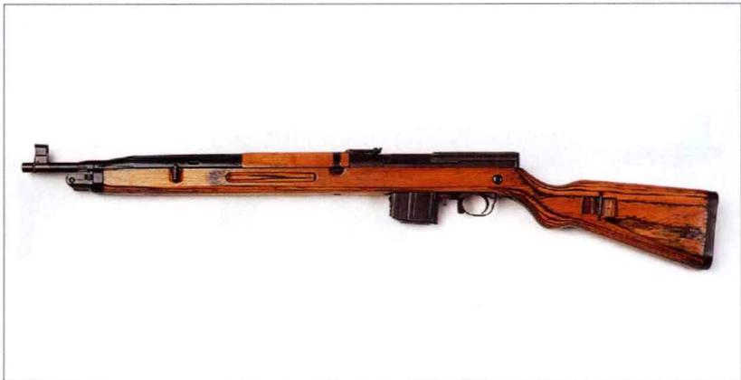
VZ52 是前捷克斯洛伐克自二战后到进入社会主义阵营国家这段短暂时间内研制的。该枪设计独特，采用导气式自动方式，套在枪管上的气塞套筒起活塞头的作用，气塞套筒与起活塞杆作用的连杆套筒相连，并发射特制枪弹。当前捷克斯洛伐克进入社会主义阵营时，该枪被改造成使用 7.62×39 毫米前苏联制式枪弹，称为 VZ.52/57 式并使用相应的铭文。这种型号的精度和可靠性不如发射 7.62×45 毫米枪弹的原型枪。值得注意的是，这两种型号的步枪都装有折叠枪刺。
