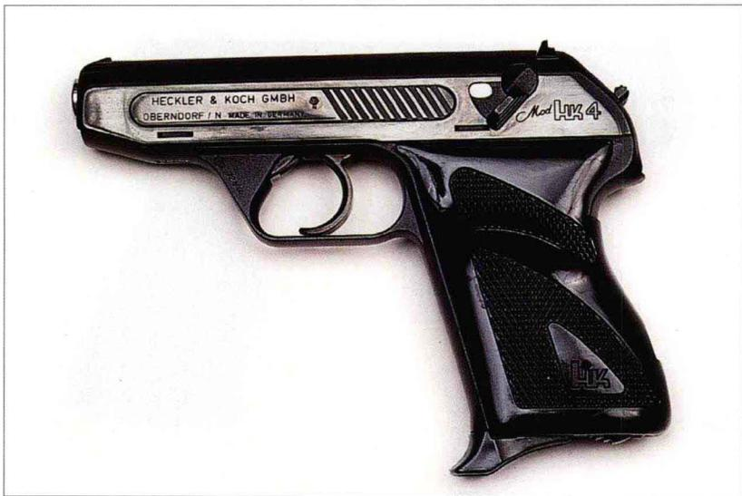
这是赫克勒 - 科赫公司生产的第一款后坐式手枪，基于二战前的毛瑟 HSc 手枪。该枪可更换 4 种不同规格的枪管，可相应发射 4 种子弹：9 毫米短弹、7.65 毫米（0.32 英寸 ACP）、6.35 毫米和 0.22 英寸边缘发火弹。随后的型号采用击针撞击方式。
