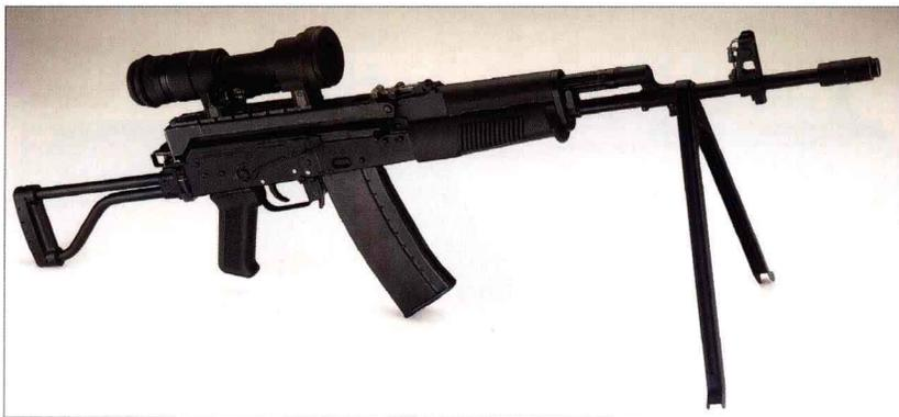
1998年，武器制造商ZM Lucnik SA开始生产坦塔突击步枪，其设计与俄罗斯AK-74突击步枪极其相似。坦塔突击步枪发射5.45×39毫米枪弹，但在1996年即将加入北约前夕，波兰决定改进坦塔步枪以发射5.56×45毫米北约制式枪弹。最终的成果为贝尔突击步枪，该枪仍基于一款AK-74变型枪的设计，但做了大量的改进，以提高其在出口市场的吸引力。与坦塔突击步枪一样，贝尔突击步枪也大量使用了铸模塑料部件，机匣上方有皮卡汀尼导轨，可安装各种瞄具。对快慢机机构进行了改进，在单发射击和连发射击模式的基础上增加了三发点射模式。另外，还可添加可选配件，如夹式两脚架以及安装在枪管下方的榴弹发射器。还有一种5.56毫米的迷你-贝尔型号，类似于AK-74SU。
