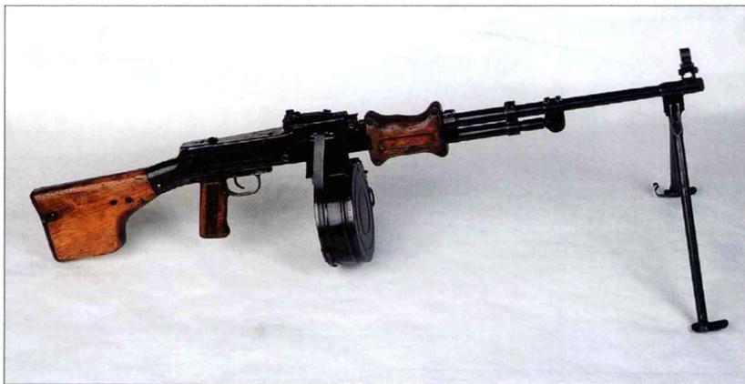
20 世纪 50 年代，采用弹链供弹的 RPD 开始用作 AK 步枪的补充班用武器使用，并作为前苏联军队配备的标准轻型机枪持续多年。它基于早期的 DP 和 DPM 机枪，并不断在改进。该枪采用导气式工作原理，对活塞系统做了重大改进，旨在提高稳定性以及在极度恶劣环境中提供足够的动力输送弹链。新设计放弃了 DP 的可更换枪管，因此必须对机枪手进行训练，使其不以超过 100 发 / 分的速度发射枪弹以免枪管过热。其他结构与 DP 类似，但按比例进行了缩小以发射口径更小的枪弹；同前辈 DP 一样，RPD 也只能进行连发射击。
