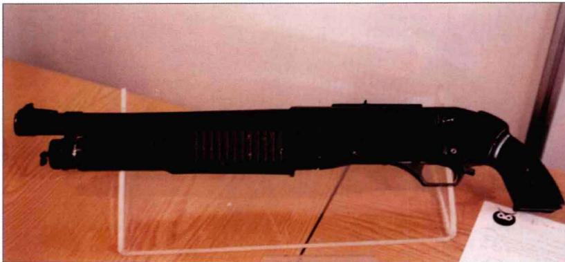
虽然被归入特种卡宾枪行列，但滑动（泵动）式 KS-23 及其军用型 KS-23M 是一款霰弹枪，用于对付最难对付的重型目标。其口径大约为 4 铅径，发射大型铅弹、金属球或特制实心子弹。KS-23 看起来像一款常规霰弹枪，但所有部件都比常规霰弹枪大，采用多凸耳闭锁枪机。军用型 KS-23M (如图所示) 绝对是一款特种部队武器，没有实心枪托，但有时配有可拆卸的骨架式枪托。这种枪大多数没有枪托，而只有手枪握把。KS-23M 可在枪口上安装榴弹发射器，还可安装发射攀登索和挂钩的装置。管状弹匣的容弹量为 3 发。当前，KS-23 和 KS-23M 在西方很少见，因此无法描述其铭文。
