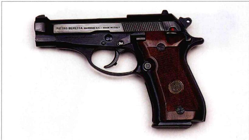
M84 手枪是伯莱塔公司采用后坐式后膛闭锁的现代手枪的代表，有多种变型型号。M81 与 M84 相同，采用双动式设计和双排弹匣且弹匣后面有一沟槽，便于从中观察余弹数，只是 81 型采用 7.65 毫米 AC P 手枪弹。81BB、82BB、83F、84BB、84F、85F、87BB 和 87BB/LB 都是 M84 的变型枪。BB 系列采用单排小弹匣，故握把较薄；设有枪膛指示器，并采用自动击针保险系统；F 系列具有 BB 系列的所有特点，且设有待击解脱杆，可让击锤释放而不待击装有枪弹的枪膛。87BB/LB 枪管更长（150 毫米）。FN 公司生产的 M84 称为勃朗宁 BDA380。
