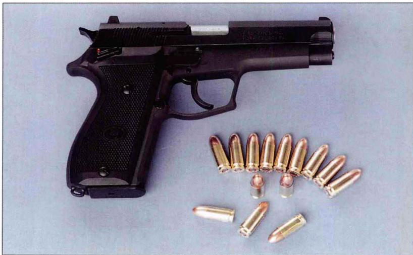
大宇 DP51 是一款自动手枪，使用 9×19 毫米巴拉贝鲁姆手枪弹，采用不常见的延迟后坐系统。枪膛内有多条环形槽，射击时，弹壳急剧膨胀，膛内巨大压力将弹壳推入槽中，从而阻止弹壳抽出及枪管尾端打开。当枪弹离开枪管后，弹壳恢复原来尺寸，枪管尾端打开。由于主要供军队和警察使用，因此双动式扳机设计得非常好，提供了合适的扳机扣力。
