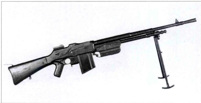
该枪是一款比利时国营赫斯塔尔公司改进的勃朗宁自动步枪。与大多数勃朗宁枪支一样，FN 持有该枪的生产许可证，可根据需要进行改造，这符合 20 世纪 20 年代欧洲的一贯做法。改造在极短时间内完成：安装可快速更换的枪管，加装手枪握把，改装拆卸系统以方便拆卸，并重新设计了导气装置。在 1939 年以前的一段时期，该枪被比利时、波兰、埃及和其他国家采用，其口径有 6.5 毫米瑞典毛瑟、7 毫米西班牙毛瑟、7.5 毫米比利时毛瑟和 7.92 × 57 毫米毛瑟。
