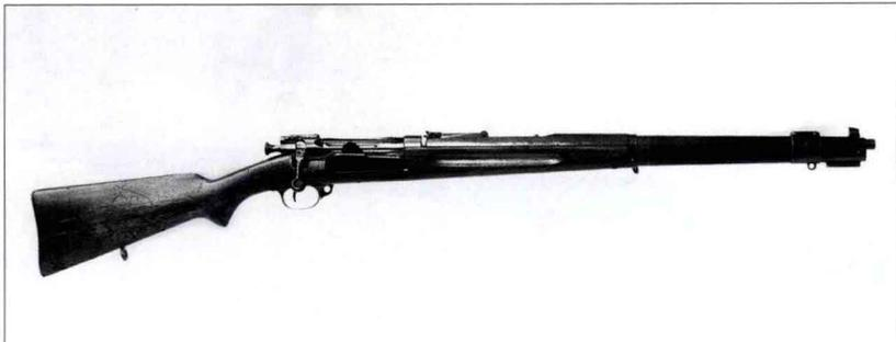
克拉格-约根森步枪由挪威研制，独特之处在于它的侧装填弹匣：将弹匣盖，装入枪弹，关上弹匣门，弹匣门给枪弹施加压力，使枪弹沿枪栓下方达到枪机运动槽左侧。该枪先后被丹麦、挪威、美国采用，但只有挪威一直使用，并于1930年研制了最后的型号。数千支克拉格-约根森步枪和卡宾枪在斯堪的纳维亚和美国销售一空，作为狩猎枪型使用，且这两个地区至今仍在使用。
