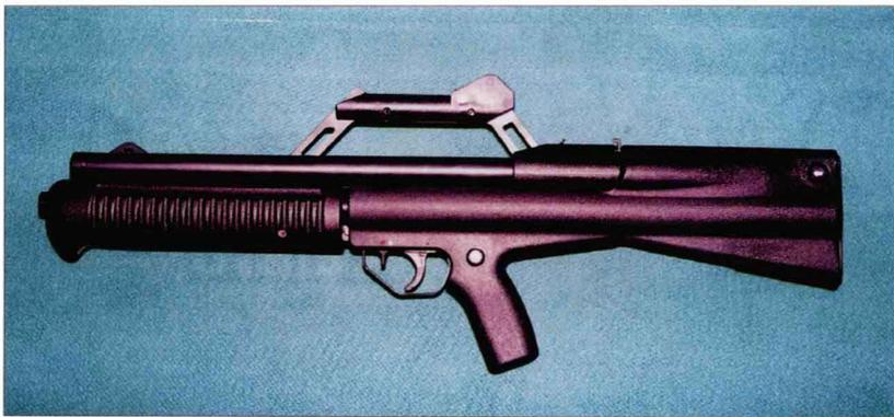
尼奥斯戴德是一款真正的滑动（泵动）枪机战斗霰弹枪。与其他霰弹枪相比，它更短、更紧凑、更简洁。该枪采用独特的枪机，通过前拉而不是后拉前托装填枪弹。两个管状弹匣分布在枪管两侧，每个弹匣装有6颗枪弹，因此可根据弹匣选择器的位置从任何一边供弹。加上枪膛中的一颗枪弹后，共有13颗枪弹可供发射。弹匣选择器、保险卡笋和前托卡笋可使用任何一只手操作，弹壳向下抛出。枪身外形平滑，由高强度聚合材料制成。装填和退弹简单、快捷，以常规方式扳开枪管后，便可对任何一个弹匣装弹或退弹。弹匣管上的开口让使用者能够知道枪弹剩余量。
