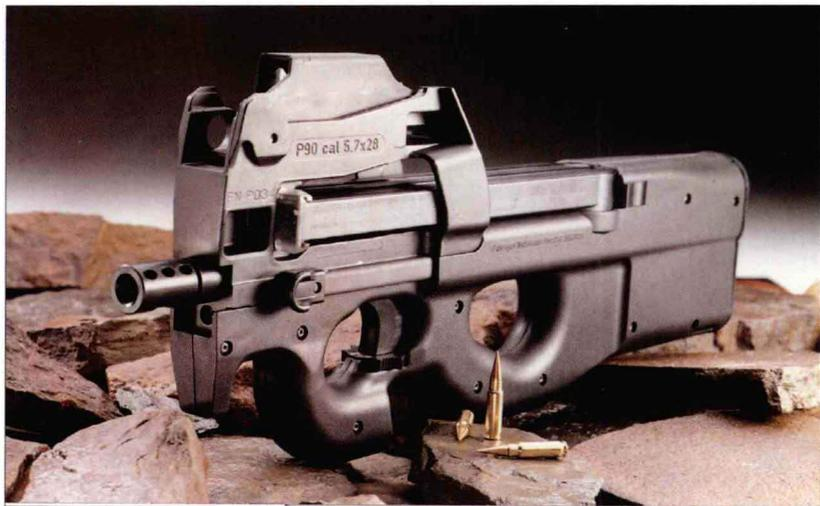
P90 是第一款发射的枪弹可穿透防弹衣的短距离作战武器，旨在满足需要装备比手枪和传统步枪更有效的袖珍武器的军人的需求。虽然外观独特，但采用枪机后坐式自动方式。其弹匣与众不同，位于枪身上方，枪弹呈 90° 排列。使用的弹头有很强的穿透力，弹壳通过空心握把向下抛出。FN 随后生产了这种口径的 FN5-7 自动手枪。
