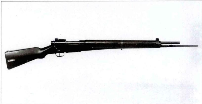
该枪虽然外形并不美观，制作粗糙，但威力强大，性能可靠，是法国陆军的制式步枪，发射1929年开始生产的7.5毫米枪弹。该枪还有枪托折叠式型号，用于装备伞兵部队和阿尔卑斯高原部队，但很少见。随后的型号（20世纪50年代起）加长了枪管并添加了同心环，以发射榴榴弹。应军队要求表面经磷酸盐处理，枪身呈棕色。
