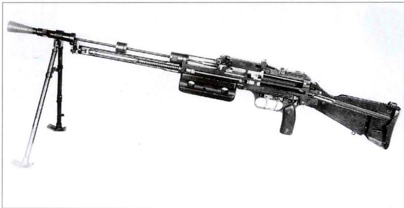
鉴于一战中使用的武器不能令人满意，法国迫切需要一种新型机枪，并抓住时机开始研制一种新型无底缘 7.5 毫米口径枪弹。经过一些改进后，这种结合非常成功，最终的成果为 M1924/29 轻机枪，该枪作为法国陆军的标准配备一直服役到 20 世纪 50 年代。1940 年，德军缴获很多这样的枪支并将其投入使用，因此经常能够看到有德语铭文的这种枪支。前法国殖民地独立时通过移交方式获得大量这样的枪支。图示为经过简化的训练型。
