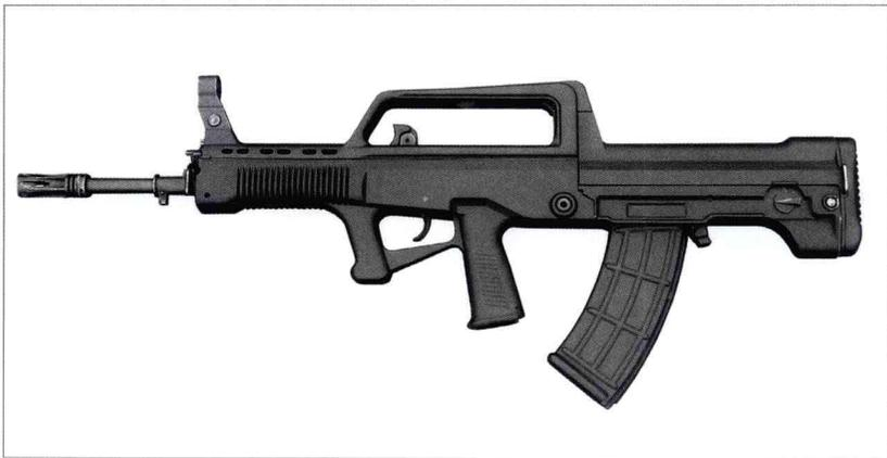
该枪于 1997 年的香港回归交接仪式上首次出现在公众视线中，采用无枪托设计，旨在缩短整枪长度的同时最大限度地增长枪管。该枪大部分由聚合材料制成，除诸如弹簧等小型部件外，只有枪管和自动机构是由金属制成的。与众多其他类似的武器一样，该枪也向右沿与使用者面颊平行的方向抛出弹壳，因此射击时用左肩顶住枪机不安全。它发射一种新研制的 5.8 毫米口径枪弹，这种枪弹与 5.56 毫米北约制式枪弹类似。97 式可能是供出口的型号，使用 5.56 毫米北约制式枪弹。
