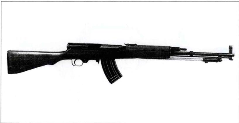
该枪完全为中国自主设计制造，集中了中国曾使用过的各种步枪的优点，虽然外形类似于 58 式卡宾枪，但内部机械基于 AK47 卡拉什尼科夫步枪。枪管下方有传统的折叠枪刺，其标准弹匣为 20 发盒式弹匣。该枪少量装备中国军队，并用于出口。
