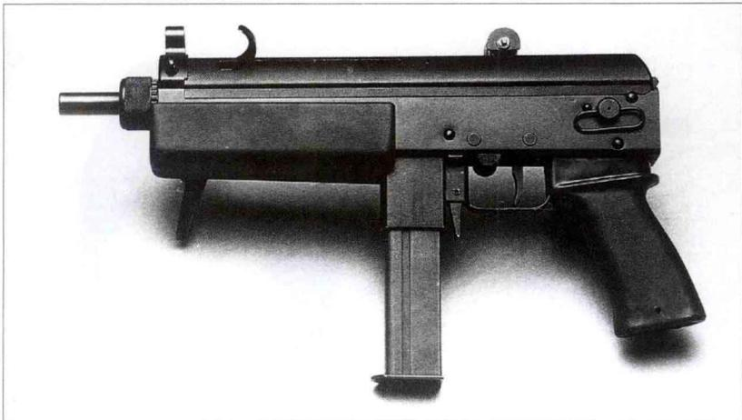
该枪于20世纪80年代末面市，是匈牙利军队和警察部队的标准装备。该枪采用常规枪机后坐式自动方式，主要由冲压件制造。该枪为开膛待击，枪机带有浮动式击针，实际发射由击锤完成。一个独特的特征是可卸下标准枪管，并换上较长的枪管，这样可将其改装成一款射程较远的卡宾枪。
