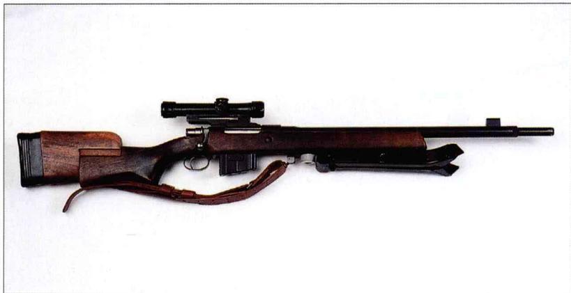
该枪为军用和警用狙击步枪，采用标准毛瑟式旋转后拉式枪机、内嵌式弹匣、重型机匣和枪管。后托有可调整的支架，枪口安装消烟器。装备孔式机械瞄具，但更常用的瞄准方法是使用瞄准镜。随枪附件通常包括背带和两脚架。
