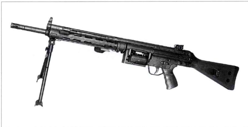
HK21 是一款通用机枪，可安装两脚架或三脚架，与 G3 步枪配合作战。它与步枪极其相似，但枪管更重且可快速更换，同时使用弹链供弹。然而，可拆除弹链供弹机构，换上弹匣适配器，并使用 G3 步枪弹匣。还可更换枪管、弹链供弹板和枪栓，以发射  $5.56 \times 45$  毫米或  $7.62 \times 39$  毫米枪弹，因此是一款通用武器。20 世纪 30 年代，葡萄牙及一些非洲和东南亚国家采用了该枪，其中的很多现在仍在使用。该枪后来被改进型 HK21A1 所取代，而后者又被最新的 HK21E 所取代。HK21E 添加了三发点射装置，还做了其他各种改进。
