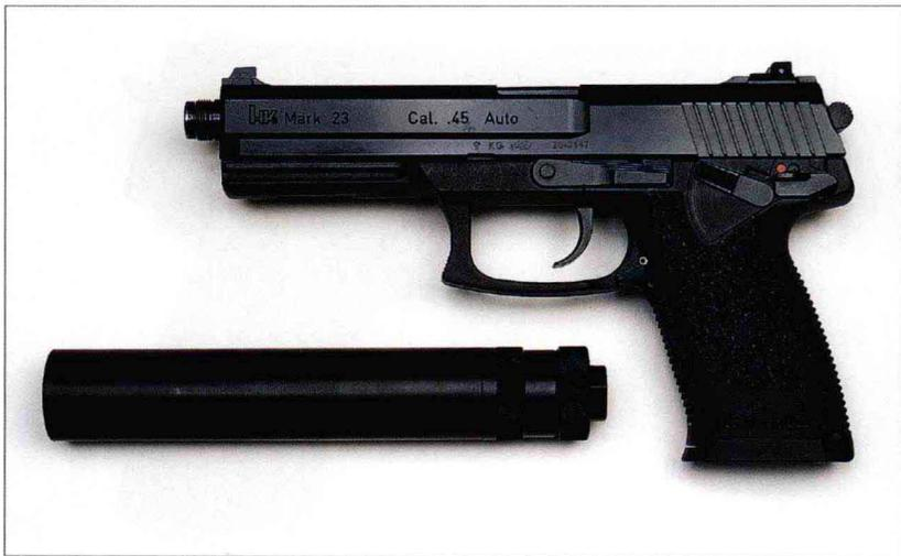
1990年，美国特种作战司令部（SOCOM）应要求研发一款0.45英寸口径的自动手枪，其精度必须比M1911A1高，并装备消声器和激光发射器。最终的成果是一款双动手枪，它采用击锤击发，并使用勃朗宁枪管下降式闭锁系统。另外，在缓冲簧中添加了后坐缓冲部件以降低后坐力，从而提高精准度。枪口从套筒中突出，并有螺纹以便安装消声器，据说这样可将噪音降低25分贝。还装备了套筒卡锁，以消除套筒后座和抛壳带来的噪音。套筒座前面有凹槽，可安装能够发射可见光或红外光的激光发射器。
