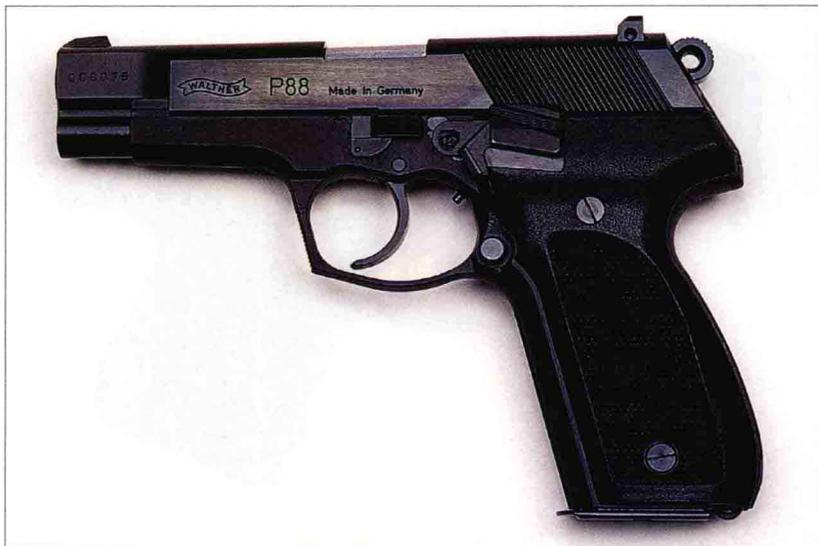
P88 自动手枪摒弃了 P38 及其后来的手枪采用的后膛闭锁的楔形待击系统，而采用勃朗宁手枪枪管闭锁机构原理，即采用凸耳和套筒内的凹槽实现开闭锁。这种系统造价更为低廉，也更易于生产。保险机构与 P5 手枪相同，即依靠不对正的击针，如果击锤意外释放，击针将与击锤上的凹槽对应。只有扣扳机到位，击针才会抬起并对准击锤打击面。
