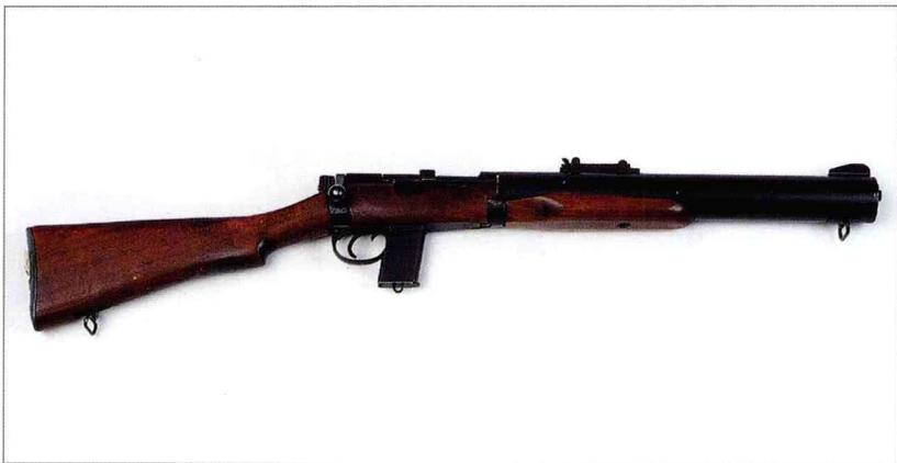
这是一款不同寻常的微声卡宾枪，它采用标准的李·恩菲尔德枪机系统，但发射美国 0.45 英寸 ACP 手枪弹。由于该枪的枪弹以亚音速飞行，且采用一体化消声器，因此可称得上是微声卡宾枪中的佼佼者。该枪共两种型号：固定枪托型和可折叠金属枪托型。折叠枪托型与斯太尔冲锋枪非常相似，因为它们都是斯太尔公司生产的。有各种现代仿制型，最初的德·里斯勒微声卡宾枪只有几百支留传下来。
