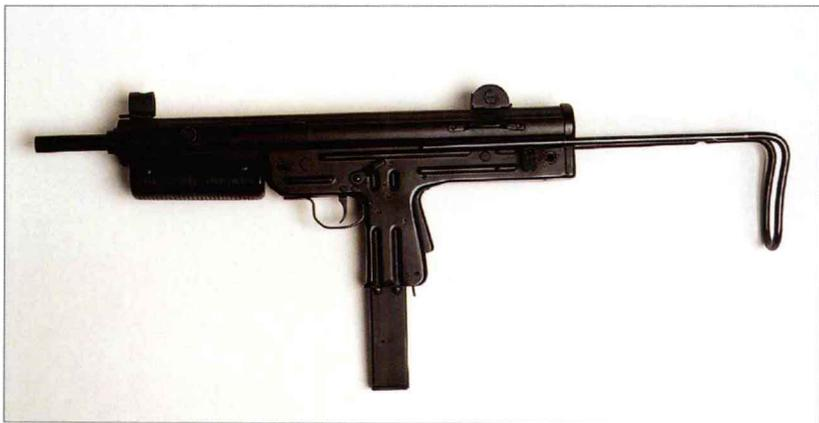
该枪为阿根廷的一种军用制式武器，最初称为 PA3 (DM)，表示 Pistoal Ametralladora 3 (Domingo Matheu 制造厂)。它在 20 世纪 70 年代初取代了 PA2 (DM)，后者是美国 M3A1 的仿制型号。该枪还有一种木制枪托型号。FMK 枪性能可靠，平衡性好，可单手轻松射击。
