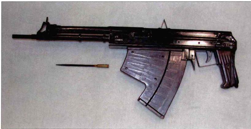
5.66 毫米 APS 水下突击步枪是一款与 SPP-1 水下手枪配套使用的武器，它也使用箭弹，但更大、更长。该枪采用导气式自动方式，配有快慢机和大容量可更换弹匣。它采用伸缩式金属条枪托，由于使用该步枪时射程较短，因此瞄具为不可调的简单机械瞄具。其有效射程取决于水深，水深 5 米和 40 米时，有效射程分别是 30 米和 11 米。
