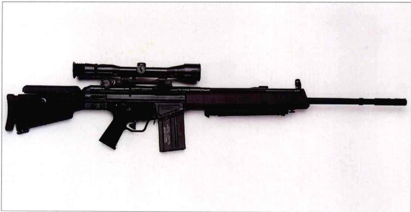
该枪是一款军用狙击步枪，实际上是一种质量更轻、价格更低的 PSG1。其枪管更轻，并经冷锻和淬火处理；扳机扳力被调整为 1.5 千克（3.3 磅），扳机套是可调整的，以方便控制。护木的导轨上通常装有两脚架，标准瞄具为 10 倍光学瞄准镜，射程可达 1200 米（3937 英尺）。瞄具座按北约标准设计，可安装任何北约制式日光瞄具或夜间瞄具。枪托可根据个人需要在不同方向上调节。
