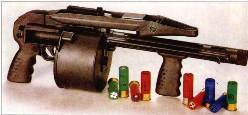
Protecta 12 铅径紧凑霰弹枪实际上是一款双动转轮手枪，因为其旋转弹匣实际上是 12 个弹巢，可通过用力扣动扳机进行调整。枪弹通过机匣右侧的进弹口进入旋转式枪膛，并自动抛出弹壳。枪弹上膛后，后拉枪管右侧的拉机柄可进入待击状态。该枪最初是一款护院武器，保险装置完备。它配有击锤卡笋，可防止打开手动保险后走火；除非刻意扣动扳机，否则不会发射。该枪配有可折叠枪托，而“牛头犬”型因为没有采用这种枪托，枪管长只有 171 毫米。
