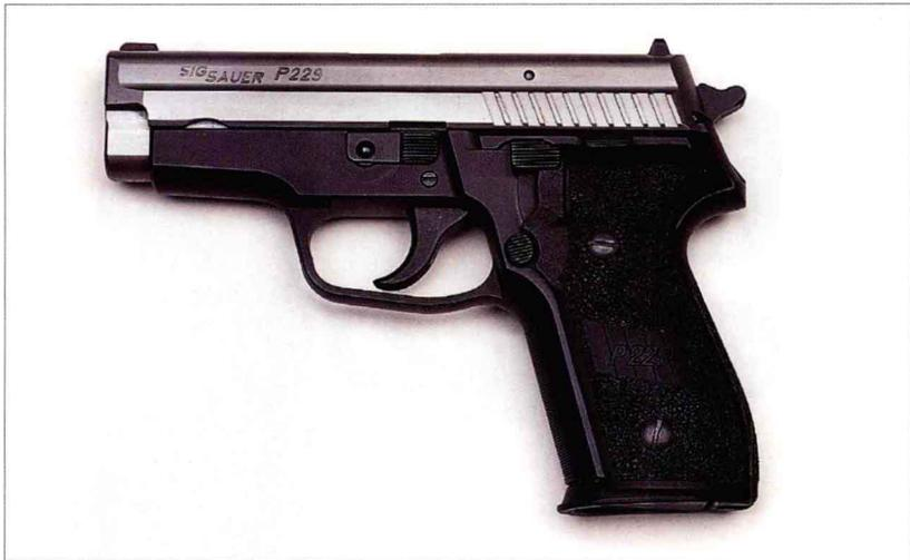
P229 在 P228 的基础上对套筒上的准星外形略作了改动，并发射 0.40 英寸史密斯-韦森手枪弹。P229 标准型采用钢制套筒和合金套筒座，变型枪 P229SL 采用不锈钢套筒，外部的改变主要在于套筒上部表面为弧状，而通常的西格手枪棱角分明。套筒座和控制器与其他西格手枪相同，令使用者感到熟悉，并确保其易操作性。个别型号采用合金套筒座和碳钢套筒或合金套筒座和不锈钢套筒，还有一种型号可发射 9×19 毫米巴拉贝鲁姆手枪弹。
