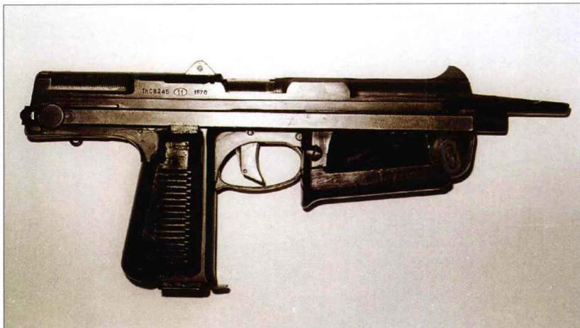
这是一款不同寻常的轻松冲锋枪，旨在用于近距离自卫。折叠式握把位于扳机前方，并装备可伸缩的双支柱金属枪托。枪机不是在机匣内移动，而是像手枪那样采用可移动套筒。套筒下半部分延伸到枪口下方，作为制退器使用，枪口燃气向上运动，以抵消自动发射时枪口上跳。在紧急情况下，可将枪口制退器顶住坚硬表面，从而单手将PM-63切换到待发状态。
