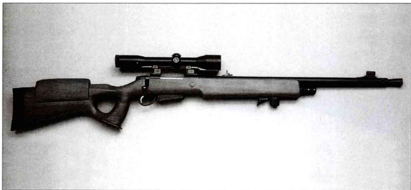
该枪采用传统毛瑟旋转后拉枪机和重型浮动式枪管。木制护木内隐藏着一根管子，管内包含减少振动的平衡稳定器，这设计旨在确保较高的射击精度。枪口有消焰器，两脚架位于平衡管下。该枪配备完全可调的机械瞄具，同时也配有北约标准瞄准镜座，可加装瞄准镜和电子光学瞄准镜。
