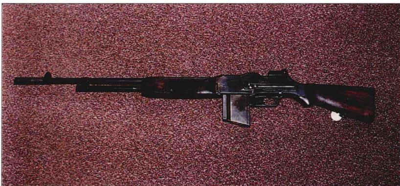
该枪是一款采用导气式自动方式和弹匣供弹的武器，与其他勃朗宁机枪截然不同。该枪是为一战设计的轻机枪，用作美国陆军的班用自动武器，并一直服役到朝鲜战争，最终于20世纪80年代被M249 SAW所取代。1940-1945年间，该枪大量装备英国国民自卫军。它采用固定枪管和容弹量有限的弹匣，并非真正的轻机枪，连续射击过长将导致前托出现大量烟雾。然而，又过于笨重，并非严格意义的自动步枪，只是因为没有更好的武器出现，它才一直得以被使用。该枪还被柯尔特公司在商业市场销售，在半自动状态可作为警用监控武器使用。后来的型号装备两脚架和提把。
