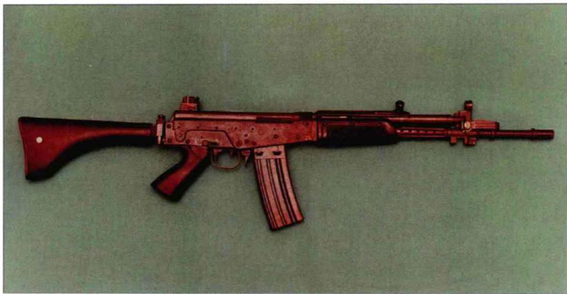
该枪于20世纪80年代初研制，主要面向阿根廷陆军，但因财政原因而导致生产缓慢，只有部分陆军部队装备了该枪。该枪的设计体现了本土化特色，采用通用活塞、枪机联动杆和回转式枪机。值得注意的是，拉机柄位于活塞筒上方、机匣前部，拉机柄实际上作用在导气活塞上，使得活塞和枪机联动杆成为一体。该枪的导气孔下方可能安装了两脚架，在这种情况下，特殊的前护木有凹槽，可将两脚架折叠到凹槽中。另外，该枪采用两种膛线，可发射M193枪弹和北约制式枪弹。
