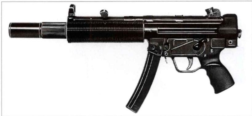
该枪是 MP5 枪族中带消声器的型号，其自动原理与标准 MP5 完全相同，但在更短的枪管上钻了 30 小孔，且套有一个大型消声器。消声器分两部分，第一部分环绕枪管，通过 30 个小孔吸收火药燃气，同时将枪弹的速度降低到音速之下。
