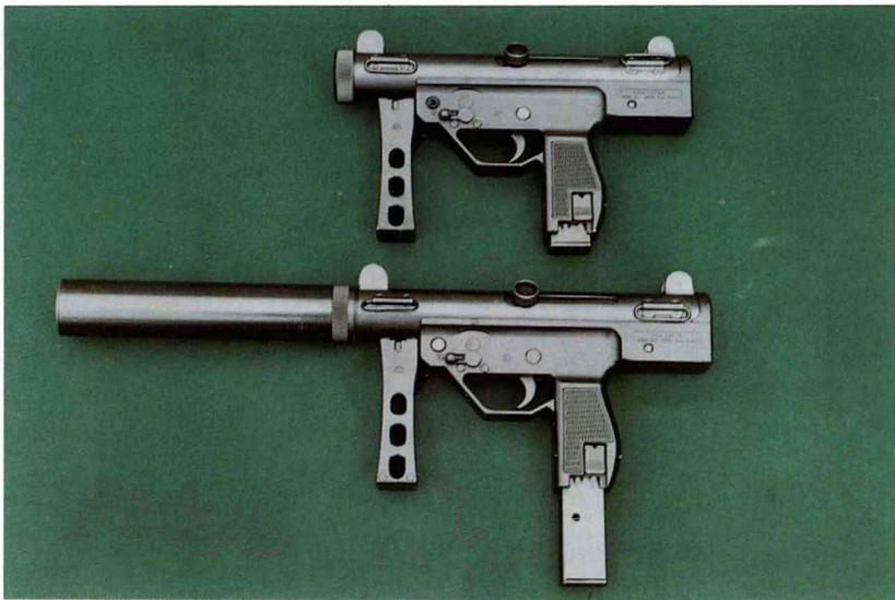
该枪最初面世时该枪称为 MGP-15，它是一款小型冲锋枪，用于装备特种部队。在生产期间改变了名称，以反映对其所做的一些细微改进，其中最重要的改进是增加了枪口螺帽，用于安装消声器。该枪装备了折叠式枪托，可折叠到枪机右侧，而枪托底板可用作前握把，如图所示。MGP-84 采用枪机后坐式自动方式，弹匣通过手枪握把插入，因此整个武器紧凑而携带方便。还存在一个更紧凑的型号——MGP-14 卡宾枪，还有一种称为突击手枪的型号。
