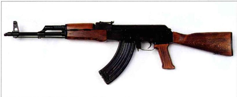
据估计，全球生产的 AK-47 式步枪超过 5000 万支。原型枪 AK-47 于 1947 年面世，此后阿尔巴尼亚、保加利亚、中国、印度、芬兰、原德意志民主共和国、匈牙利、伊拉克、哈萨克斯坦、朝鲜、波兰、罗马尼亚和前南斯拉夫都制造或仿制过该枪。AK-47 采用实心金属机匣，而更常见的 AKM 大量使用钢制冲压件，可通过机匣上位于弹匣槽上方的小凹陷识别该枪，而 AK-47 的凹陷更长。AKMS 采用折叠式金属枪托，只能通过铭文确定枪支的原产国，而在有些枪支上只有序列号。罗马尼亚生产的 AKM 通常有前握把，而其他国家也进行了细微的本地化改进，并改变了尺寸。表面抛光效果可能很精良，也可能很糟糕，但所有 AK-47/AKM 都性能可靠、坚固耐用。
