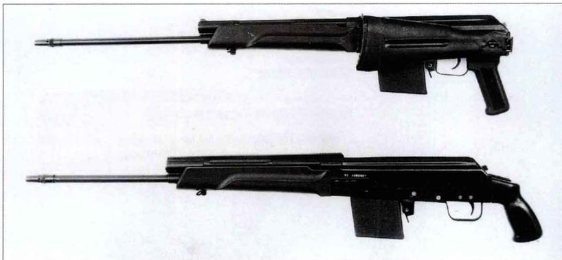
0.410 霰弹通常被视为狩猎枪弹，但在东欧和俄罗斯，这种枪弹常用于安全部队。发射圆形子弹时，有效射程可达100米。半自动 SAIGA-410 由俄罗斯 IZMASH 联合股份公司为安全部队和民用市场研发，它结合使用了卡拉什尼科夫导气式系统和 0.410 枪弹。该枪有三种型号：SAIGA-410 标准型、SAIGA-410C 中型和 SAIGA-410K 短型，它们的枪管长分别为 518 毫米、570 毫米和 330 毫米。SAIGA-410 标准型采用固定枪托，SAIGA-410C 中型配有可折叠枪托或只有手枪握把（如图所示），SAIGA-410K 短型配有折叠式枪托和手枪握把。在 SAIGA-410K 短型中，枪托折叠时保险将锁住扳机。
