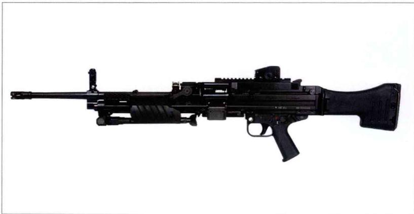
该枪最初名为 MG43，被前联邦德国国防军采用后改称 MG4，可将其视为二战期间的 MG42 的后续产品。这是一款使用弹链供弹的导气式轻机枪。安装可快速更换的枪管，更换发烫的枪管时，可握住枪管上的提把和折叠式枪托。不同于同时代的其他轻机枪，MG4 不能使用弹匣供弹。受弹机盖有一个皮卡汀尼导轨，可安装可调整的机械瞄具作为标准配置，起瞄准距离为 1000 米。但可将机械瞄具卸下，并安装光学瞄准镜或夜视设备。使用光学瞄准镜时，将机械准星向下折叠。
