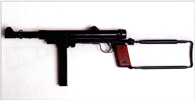
作为仍在服役的最古老的冲锋枪之一，卡尔·古斯塔夫是一款坚固耐用的武器，还可能继续服役很长时间。最初的型号没有弹匣槽，而使用弹鼓。1948年设计出盒式弹匣后，所有枪支都加上了弹匣槽。卡尔·古斯塔夫冲锋装备瑞典、爱尔兰和印度尼西亚军方，还授权在埃及生产，名为“塞得港”。存在一个稍做改进的型号，用内部消声器取代了常规枪管，被美国军方装备于在越南作战的特种部队。
