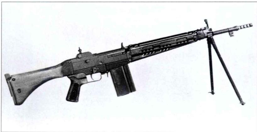
该自动步枪由日本自行研制，并由丰和机械有限公司生产。它采用导气式工作原理，闭锁方式为枪机偏移式。设计该枪时考虑了日本士兵身材较矮的特点，发射简化了装填程序的特种枪弹，并采用枪口制退器减少后坐力。必要时可通过适当调节气体调节器以发射北约全装药枪弹，该枪还可发射榴弹。
