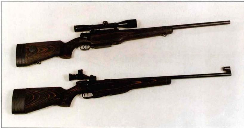
该枪是为挪威陆军和警察部队研制的狙击步枪，也在民用市场作为比赛和狩猎用枪。该枪采用毛瑟格韦尔 98 枪机，使用标准的三突笋枪栓。枪管异常沉重，通常配备 6×42 倍瞄准镜，还安装备用机械瞄具，但光学瞄准镜几乎是必须配备的。枪托由桦木制成，后托长度可调，且可安装贴腮板，该步枪还配备两脚架和消声器。
