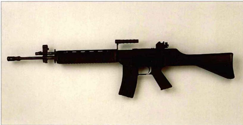
新加坡轻兵器工业有限公司是以获得柯尔特公司特许生产 M16 步枪起步的，随后该公司请英国斯特林公司为其设计了 SAR-80 自动步枪并投入生产。SR88 是其改进型，已成为新加坡军队的标准制式步枪，并销往其他远东地区。该枪的机理不同于 M16，采用导气式活塞驱动枪栓向后运动并旋转枪栓闭锁。活塞筒经镀铬处理以减少火药残渣和烧蚀，枪托、前护木、手枪握把都采用玻璃纤维增强尼龙制成，枪管下方可安装美国 M203 榴弹发射器。
