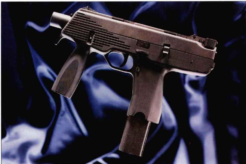
TMP(战术冲锋手枪)已经取代 MPi69 和 MPi81 成为标准斯太尔冲锋枪。机匣几乎全部由合成材料制成,可加装消声器。公司计划研制与 AUG 步枪相似的模块系统,以便只更换几个零件就可将 TMP 改装为其他口径(如 10 毫米)的武器,但没有成功。还有不带前握把、只能进行单发射击的型号,被称为 SPP(特种手枪)。2001 年,德国的布鲁加-托梅公司购买了该枪的生产权,该公司当前生产的是改进版 MP9。
