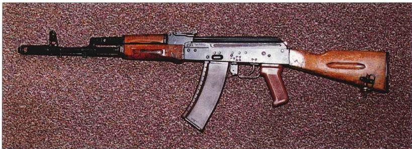
AK-74 是 AKM 的小口径型，其机匣、枪体及枪机系统与 AKM 相同。5.45 毫米枪弹与 7.62 × 39 毫米枪弹的长度几乎相同，只是口径更小，但这两种弹匣不能通用。该枪的一个显著特征是采用层压塑料和玻璃钢弹匣，进而对 AKM 的设计做了细微的改进。另一个特征是采用枪口制退器，以降低后坐力并减轻自动武器普遍存在的枪口上跳问题。该措施对降低后坐力和提高射击稳定性非常有效。AKS-74 型采用钢制折叠枪托，可折叠到机匣左侧。后来的 AK-74 采用非常紧凑的黑色塑料枪身，这种变型枪称为 AK-74M。
