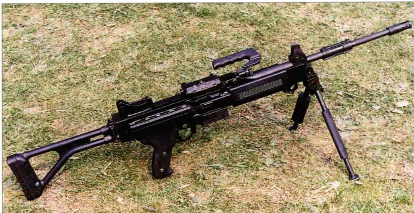
该枪是一款多用途武器，可使用标准弹链、弹盘或弹匣供弹，可安装在两脚架、三脚架或车辆架座上进行射击。使用标准枪管时发射 SS109 枪弹，还可更换枪管以发射美国 M193 枪弹。该枪采用导气式工作原理，枪机回转闭锁机构，枪机锁入枪管节套内并开膛待击。气体调节器有 3 个调整位置，分别对应于射速 650-800 发 / 分、射速 800-950 发 / 分以及关闭气源并发射榴弹。该枪可半自动或连发射击，通过卸下两脚架并装上前护木和短枪管可将其用作突击步枪使用。内格夫于 1988 年面世，并装备于以色列国防军。
