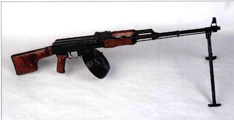
RPK 取代 RPD 成为前苏联步兵的标准班用自动武器，后来装备前华沙条约国家的军队，并散布到世界各地。它不过是在标准 AKM 突击步枪的基础上加重了枪管，并在后膛延伸部添加了强化肋条；该枪可使用 AK 弹匣，这使得战场补给变得相对容易。虽然膛室和枪膛都经过了镀铬处理，以尽可能降低磨损，但与同步枪一样，枪管是固定的，因此与弹链供弹机枪相比，其持续火力支援能力有限。
