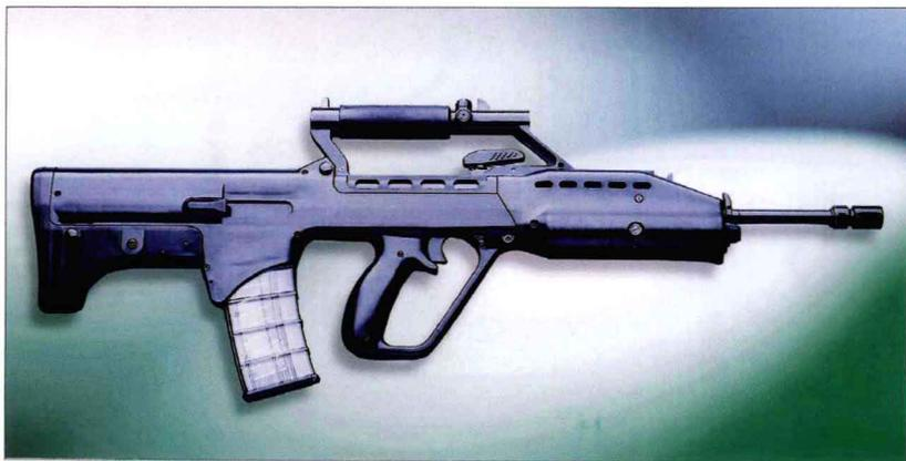
新加坡科技动力公司以前名为新加坡特许工业公司 (CIS)，它于 1995 年开始研制 SAR 21 5.56 毫米突击步枪，于 2002 年为本国的防卫部队生产该枪，并在出口市场上广泛宣传。该枪结合使用了斯通纳回转式枪机和紧凑型无枪托设计，弹匣安装在扳机机构后面以缩短整枪长度。几乎整款武器都使用光滑的高强度塑料包裹。基本型采用 M16 式 30 发弹匣，瞄准装置包括固定的 1.5 倍光学瞄准镜。另外，前护手中还有红点激光瞄准装置。P-Rail 型的机匣上方有皮卡汀尼导轨，可安装各种瞄具。另外，还有精确射手 (Sharp Shooter) 型号和 SAR 21 轻型机枪，其中前者装备 3 倍光学瞄准镜，而后者装备加重枪管和轻型两脚架。
