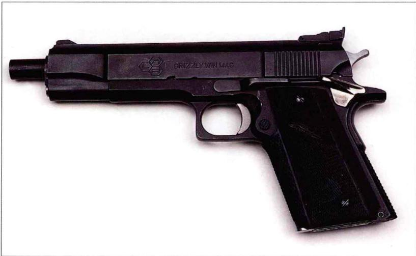
该枪外观上完全模仿柯尔特 M1911A1 的设计，主要区别在于加长的枪管、直角形扳机护圈和可微调的照门。该枪使用独特的枪弹，即缩口的 0.45 英寸 ACP 手枪弹壳装 0.357 英寸弹头。通过更换部件，可发射 0.357 英寸马格努姆手枪弹、0.45 英寸 ACP 手枪弹、0.44 英寸马格努姆手枪弹和各种 9 毫米手枪弹。可更换套筒和套筒座以使用 8 英寸和 10 英寸的枪管，还可缩短枪管以安装消退器。
