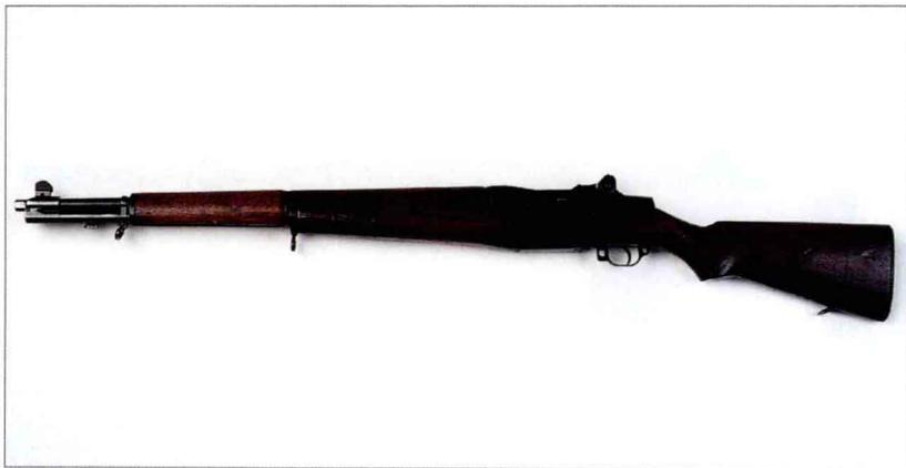
加兰德步枪是第一款大量装备部队的自动填装动步枪，因其稳定性和大威力而深受欢迎。如果说有什么缺点，那就是它采用弹夹装弹系统，这导致在不能射击间隙将弹仓装满枪弹——在弹夹未空前不能更换。另外，发射最后一颗枪弹后，空弹夹将弹出，如果落在坚硬的地面上极易损坏，这种缺陷将更明显。但毕竟是小缺陷，该枪共生产了600万支，1945年后出口到了很多国家，该枪还将继续服役多年。
