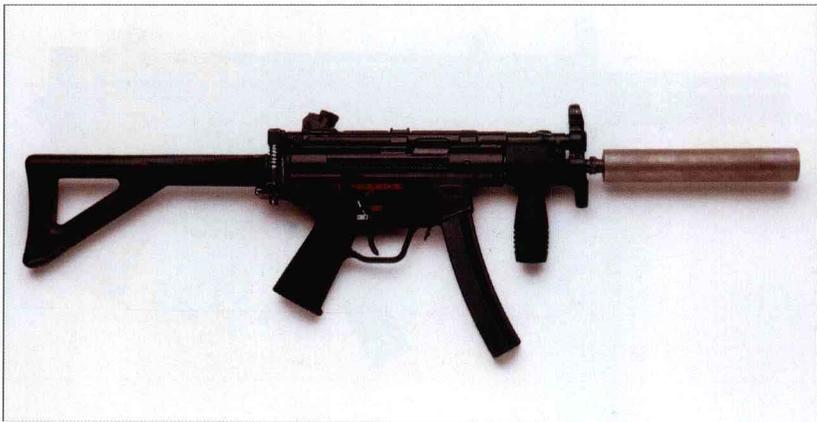
该枪由赫克勒-科赫在美国的子公司设计，供给需要极其紧凑武器的空勤或车载武装人员使用。该枪事实上是在 MP5K 上安装折叠枪托，且膛口经过改造以便安装消声器。该枪还安装激光指示器。如果不需要枪托，可轻松地将其卸下，并在机匣尾部装上枪托盖。快慢机采用标准配置，但如果需要可安装两或三发点射部件。
