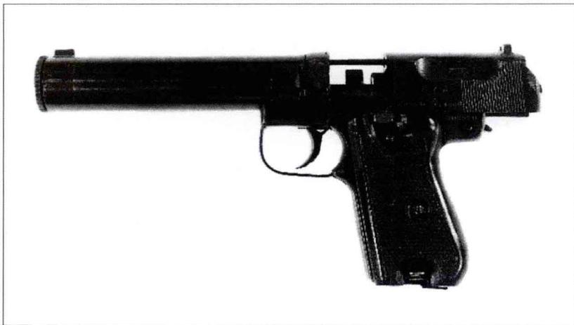
该枪是64式的改进型，消声装置相对不那么笨重，让该枪能轻松装入枪套，同时保证了平衡性。该枪没有后膛锁定装置，只能使用通常的后坐式操作。该枪使用的7.62毫米低威力（64式）手枪弹，图示中套筒处于打开位置。
