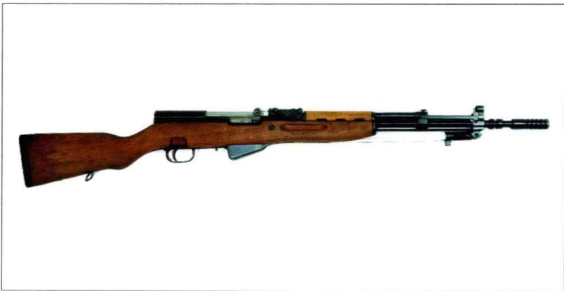
20世纪50年代，前南斯拉夫从前苏联引进了西蒙诺夫SVS步枪，其称为M59。但经过一段时间的使用，决定对其进行改造以满足本国的需要。枪管经过加长，可安装22毫米口径的枪榴弹发射器，改造了气缸与枪管之间的连接，并采用全新的瞄准具，包括夜视瞄准镜和榴弹瞄准镜。缩短了前护木，但保留了铰接刺刀。这种型号称为M59/66。前南斯拉夫解体前该枪曾大量出口。
