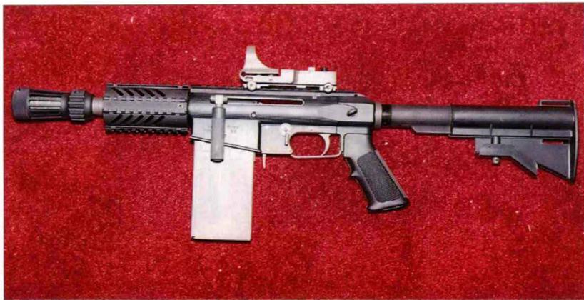
虽然步枪和夹式霰弹枪组合的效果不错，但操控起来比较复杂，因此 C-MORE 轻型霰弹枪系统 (LSS) 将霰弹枪部件设计地更简单、更轻便。除挂到 M16 系列步枪下 (如图所示) 外，LSS 还可作为独立的轻型武器，并安装 M16 系列伸缩式枪托和扳机机构等标准部件。无论是哪种形式，LSS 都采用手动枪机，并使用容弹量为 2 或 3 发的盒式弹匣，但也可使用容量更大的弹匣。由于其枪管较短，因此必须安装相当大的消焰器。
