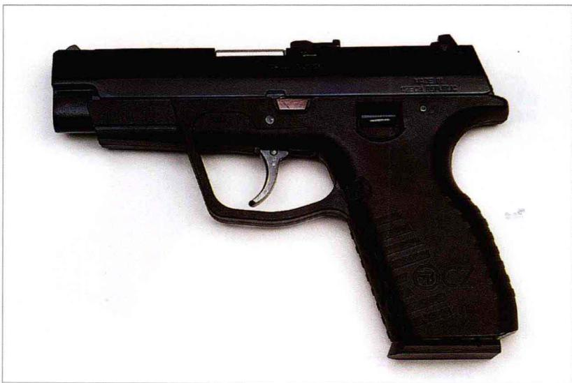
这种略显敦实的手枪于1995年问世，首次在CZ手枪上使用了合成材料。套筒和套筒座分别采用钢和工程塑料，枪把更窄，握拿起来更舒适。该枪为自动待击式，只有扣动扳机才能释放击针，并设有自动击针保险。套筒上方抛壳口后部有一突起以方便一只手操作。将手枪放在硬物上并向握把方向按突起，可使套筒向后以便装填第一发弹。枪机采用普通的勃朗宁凸耳设计，用以将枪膛上部和抛壳口锁住。可安装激光指示器。M101和M100非常相似，只是弹匣容量较小：7发9毫米手枪弹或6发0.40英寸手枪弹。
