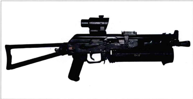
Bison-2 以一款经过重大改进的 AK-74 步枪为基础而设计，保留了机匣和折叠式金属枪托设计，但使用大容量螺旋式弹匣取代了双排弹匣。它采用枪机后坐式自动方式，快慢机控制火力的方式与步枪相同：向上为保险，中间为连发射击，向下为自动装弹射击。鸟笼型消焰器可拆卸，并换上消声器。枪身左侧安装标准的俄罗斯瞄准架。后来的 Bison-2-01 改进了枪托，采用折叠到机匣上方的设计。有两种射击模式：只能自动装弹射击和可选择射击方式。当前有三种不同口径的型号，后面列出的是 Bison-2 的参数。
