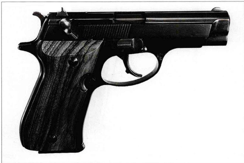
该枪可以称为比利时的伯莱塔 84。为了开拓警用枪市场，FN 公司欲开发一种枪机后坐式手枪，于是借鉴伯莱塔手枪成功的设计经验并改变局部外观推出了该枪。它和伯莱塔 84 最显著的区别在于握把采用工程塑料，并在上面印有花押字“FN”。在该种尺寸的手枪中，它开创了使用双排和高容量弹匣的先河。
