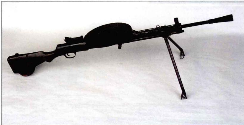
经过两年试用后，DP 机枪于 1928 年开始装备前苏联军队成为标准步兵班用机枪。该枪在前华沙条约国家一直服役到 20 世纪 50 年代，并散布在世界各地的爱好者手中。它只能连发射击，并使用老式 7.62 毫米有底缘枪弹。其扁平弹盘容易受损，枪管下的活塞复进簧在枪管下长期受热后很可能失去弹性；两脚架也过于脆弱，经常折断。所有这些缺陷在该枪于 1941 年首次接受战争考验时暴露无遗，这促使前苏联开始研发 DPM。
