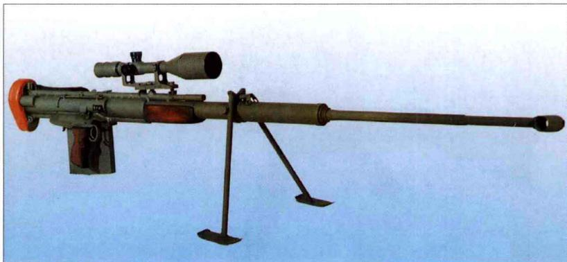
杰帕德 M2 步枪外形和 M1 类似，但它是一款采用长后坐系统的半自动步枪。枪管在加强套筒和机匣内后坐，通过旋转枪机在枪管尾端闭锁。射击时，枪管和枪栓在完成大约 6 英寸的后坐行程后，枪栓开锁并停止，而枪管向前运动并完成抛壳。枪管停止运动后，它压下枪栓解脱按钮让枪栓向前运动，从而完成推弹上膛动作。该枪的弹匣位于手枪握把左侧，因此无法用左手射击。两脚架装于枪管加强套筒上，并配装瞄准镜。
