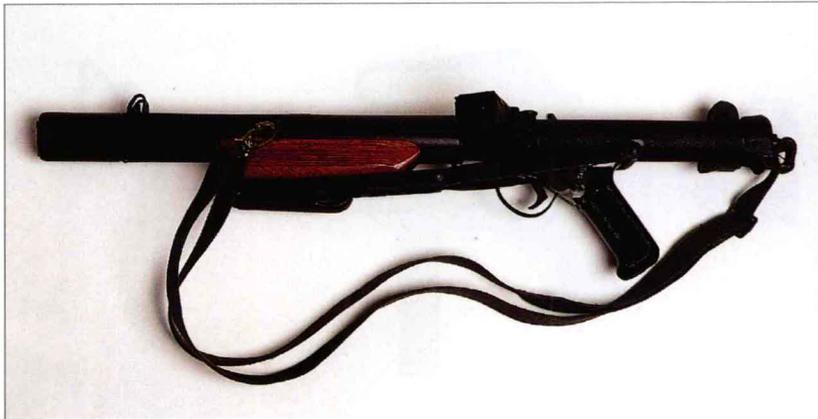
斯特林取代司登后，亟需生产司登 Mark6 微声枪的替代产品，为此以司登微声枪为基础并经技术改进，将斯特林 L2 进行了重新设计，并命名为 L34 型。其结构与 L2 相同，但枪管上增加了 72 个排气孔，以降低弹头的速度。排出的气体进入包裹在枪管外面的金属膨胀腔内，然后从膨胀腔渗漏到圆柱形消声器内。消声器前端为螺旋状扩散装置，弹头在中央穿过时形成涡流，并进一步降低气体流速，从而降低爆炸声。为降低气压，枪机质量必须比标准枪小。
