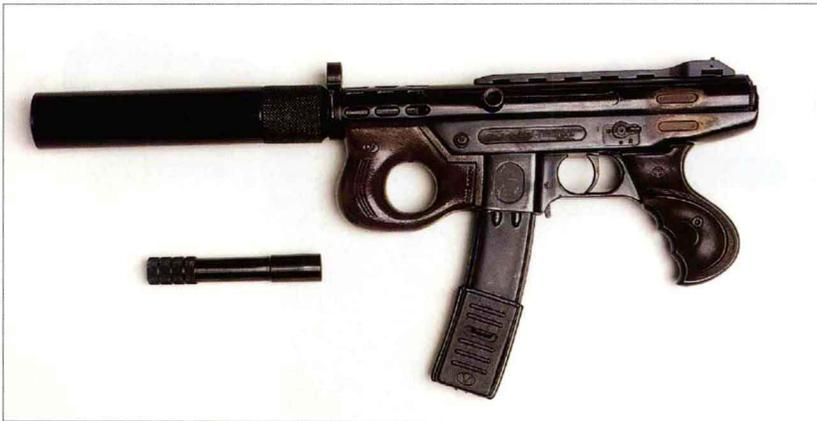
阿格拉姆 2000 是一种本地制造的轻型冲锋枪，主要通过金属锻压和塑料成型制造。枪口刻有螺纹，可安装保护套筒，也可卸下套筒，换装消声器。该枪没有配备抵肩枪托，瞄准装置由片状准星和翻转式照门构成，照门有 50 米和 150 米两个位置，因此在实际使用中的精确性值得怀疑。该枪的另一种型号是阿格拉姆 2002，但没有前置的手枪式握把。
