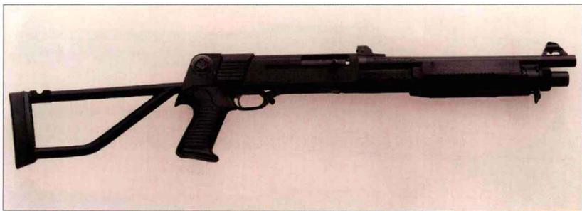
伯奈利 M3 可变式战术霰弹枪有两种操作方式。发射常规威力枪弹时，枪机为半自动；转动弹簧环可将枪机变为手动滑动式，这种模式用于发射非致命性低威力枪弹。M3 可变式采用固定枪托，而 M3T 采用折叠式枪托以缩短携带时长度。另外，M3T 的弹匣容弹量更高，为 6 或 7 发，还有 1 发枪弹已上膛；而 M3 可变式的弹匣容弹量为 5 发，还有 1 发枪弹已上膛。
