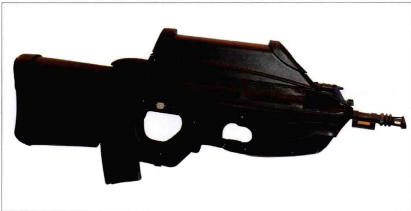
该枪是一款采用模块化设计的无枪托突击步枪，采用导气式自动方式的回转式枪机由硕大的聚合材料外壳包裹，同时可用于执行特殊战斗任务。可将前护手卸下，以便在枪管下方安装40毫米的榴弹发射器；瞄准设备也可拆卸，以便安装热成像或夜视瞄准装置。另外，还可安装刺刀。该枪的一个独特之处是通过位于机匣右侧的管道向前抛壳，这使其成为一款适合左右手使用的步枪。瞄准装置后部有一个口盖，可将其打开以检查枪弹是否上膛。该枪使用北约标准M16弹匣。
