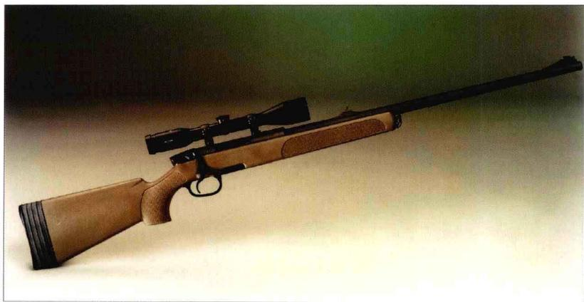
该枪为1969年为奥地利陆军研制的一款狙击步枪，随后被投入到民用市场，并被很多军队和警察部队采用。经过细微的改进（如枪栓更重，枪栓把手更大），推出了短枪管型和可安装消声器的特种“警用型”，但都使用基本的转栓式机构，枪栓上的凸耳将扣住弹匣后方的机匣中的凹槽内。弹匣现为舍恩努尔型，但有几年采用了可卸下的10发盒式弹匣。SSG-69是希腊的EBO公司在获得许可的情况下生产的，采用木制或合成材料枪体，称为Kefefs。
