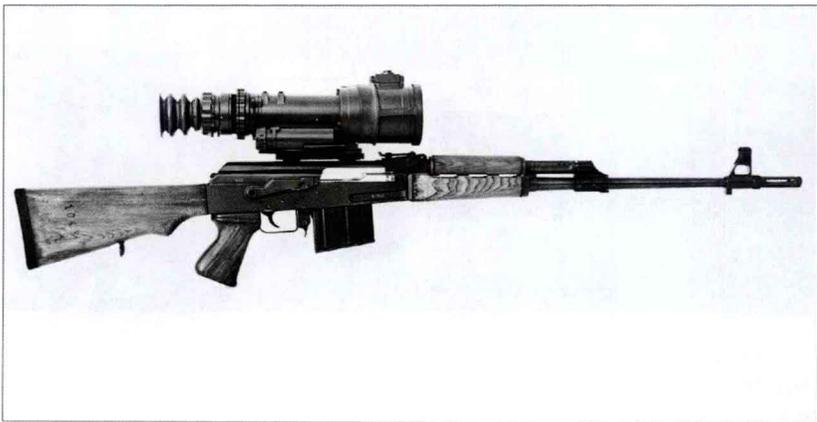
该枪采用 AK-47 的轧钢枪机，但发射威力大得多的枪弹，枪管经过加长加重，成为一款出色的狙击步枪。瞄准镜底座几乎可安装任何光学或电子光学瞄准装置。该枪是前南斯拉夫军队的制式步枪，同时用于出口，但出口型号发射 7.62×51 毫米北约制式枪弹。长长的消焰器末端有间歇式螺纹，可安装消声器。还可安装卡拉什尼科夫式刺刀。
