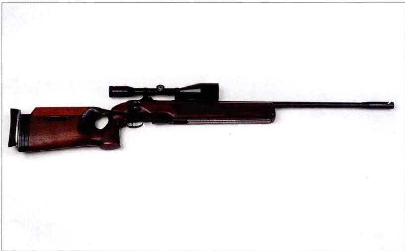
该枪采用与众不同的枪机系统：转动拉机柄时，拉机柄前方的凸起在凸轮的作用下向外运动，并卡进机匣的凹槽中，导致枪栓无法转动。进入待击状态后，扳机被推向前，只需轻轻触碰就可射击。该枪被设计成比赛用枪和执法用狙击枪，没有机械瞄具，必须装备瞄准镜。除 7.62 毫米口径枪弹外，该枪还可使用 5.56 × 45 毫米和 7.5 × 55 毫米军用枪弹和 0.3 英寸马格努姆枪弹。
