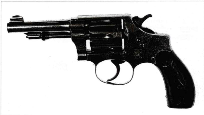
0.32 英寸手动退壳型是史密斯-韦森公司首款采用侧旋式转轮的转轮手枪，有三种型号，图示为第二种型号，它采纳了警方和军方的改进建议，如现在大家熟悉的转轮门和前置退壳杆。第三种型号增加了安全击锤阻铁，并改进了扳机机构。该枪深受欢迎，广泛用于警察部队和家庭防卫，三种型号的总产量超过 300000 支。
