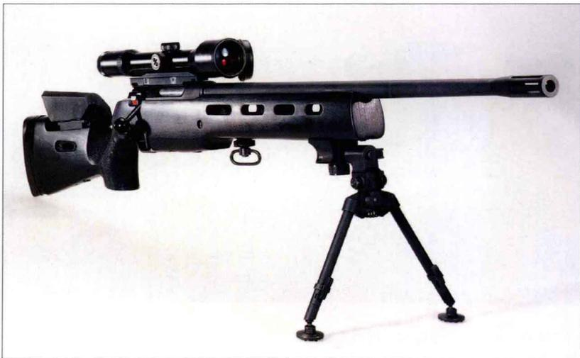
该枪是由一款非常成功的比赛步枪改造而来的军用和警用狙击枪。它采用模块化设计，枪管和机匣通过螺纹连接，扳机和弹匣系统作为一个整体装于机匣内。该枪采用胶合木枪托，枪托内有很多通孔以免重枪管受热变形。枪栓有六个卡笋卡进枪管。下护木下方有一个导轨，可安装两脚架和枪背带。无机械瞄具，通常配装用于安装亨索尔瞄准镜的瞄准镜座，但也可能采用北约标准 STANAG 瞄准镜座。
