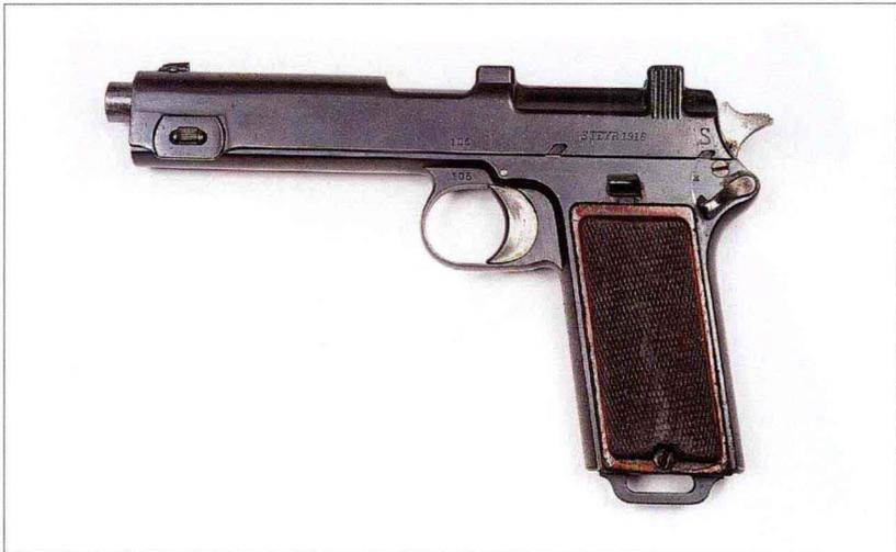
该枪是史上最出色、可靠的手枪之一，它发射奥匈帝国特有的一种枪弹。该枪最初使用弹条装弹系统，这种系统在可卸式弹匣面世前就已废弃不用。1938年，奥地利被第三帝国吞并，该制式手枪也随之改进枪管以发射9×19毫米巴拉贝鲁姆手枪弹，并在套筒左侧标有“P-08”以示与原枪区别。9毫米斯太尔手枪弹目前仍在生产。
