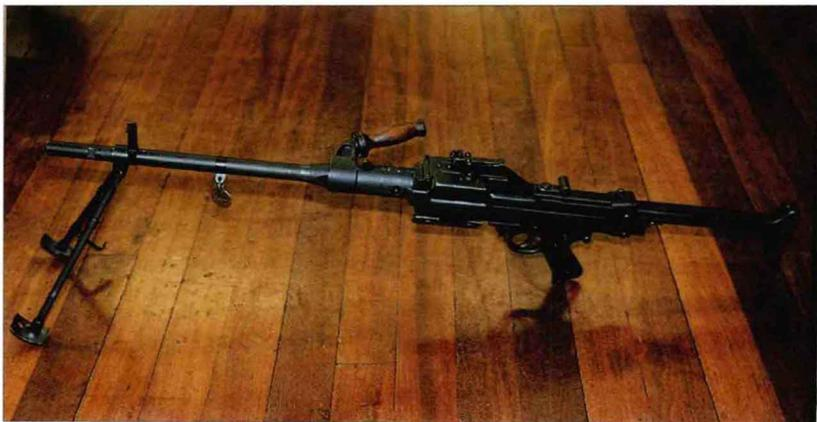
该枪也称 AAT-52、MAS-52 或 F1，是法国陆军配备的标准通用机枪。该枪采用枪机延迟后坐自动方式，并采用类似于 FA-MAS 步枪的组合枪机，其中前面较轻的部分用来克服枪机闭锁前较重枪尾的惯性。枪膛内有凹槽以便通过膛压轻松完成抛壳，但结果是抛壳声音极大。尽管如此，该枪性能可靠、有效，被多个前法国殖民地采用。其枪托可缩进机匣内，且没有护木，这使得在枪管发烫时难以调整机枪的位置。
