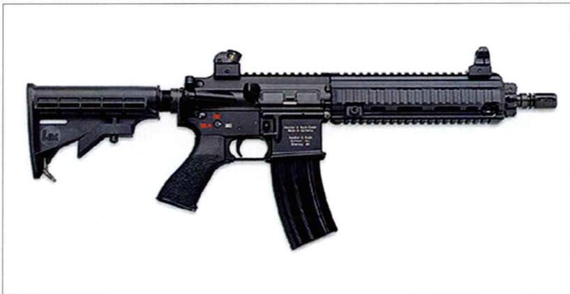
HK 416 的研制目的在于提供一款性能比长期服役的 M16 突击步枪更优越的武器。它采用短行程导气式自动方式，而不像 M16 系列那样使用直接气体驱动系统。该枪对 M16 的基本设计做了重大改进，将一体化合金前托换成了由两部分组成的聚合材料前托，并采用浮动式枪管。装备可折叠的机械瞄具，因为标准配置是使用光学和夜视瞄准设备。另一种使用 7.62 毫米北约制式枪弹的型号 HK 417 还在研制过程中。
