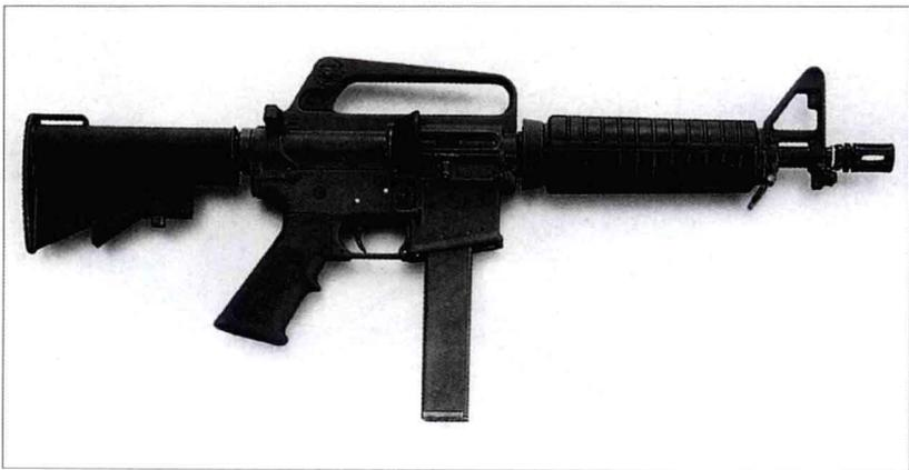
该枪的设计以著名M16步枪为基础而设计，因此对熟悉M16步枪的士兵来说，训练使用该枪的时间将短得多。枪托采用伸缩结构；外观方面，该枪与各种M16短型步枪的唯一差别在于它使用狭长的弹匣。需要指出的是，持枪者可选择使用连发或三发点射，快慢机标志将指出选择的射击模式。还有一种只能单发射击的型号，不能连发或三发点射。
