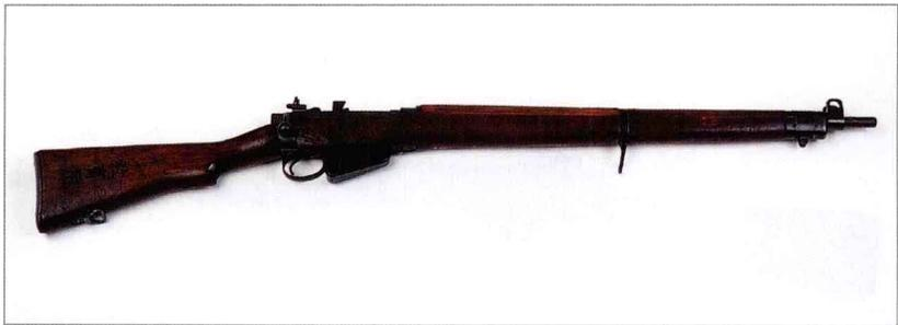
该枪的研制旨在取代 SMLE Mark III 步枪，它几乎与 SMLE Mark III 相同，但进行了简化以便战时更容易大规模生产。改进了枪口帽，将旧式枪刺换成了尖形刺刀，瞄具从半圆弧 U 形变成了觜孔式。
