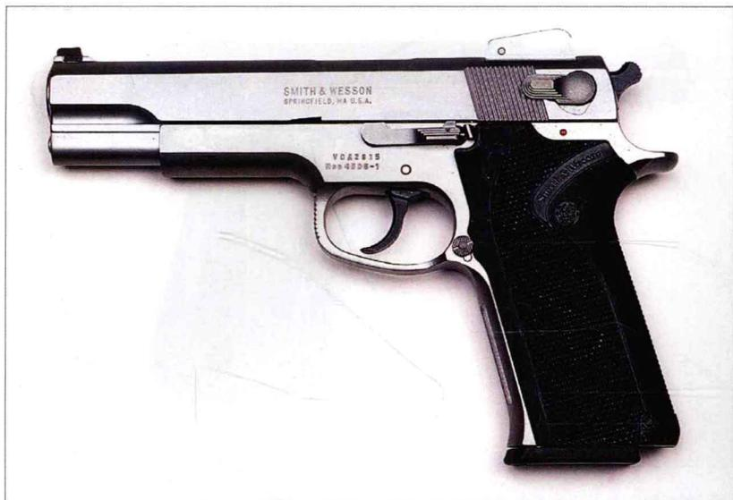
史密斯-韦森公司1988年生产的自动手枪系列是根据执法部门和军事专家的意见设计生产。该系列手枪采用双动式扳机和三大保险装置，固定枪管衬套可提高射击精度和方便拆卸，三点瞄准系统便于快速瞄准，斜式弹匣便于更换，扳机扣力也有很大改进。有各种口径和表面处理方式的型号。图示为M4506型，数字表示口径为0.45英寸，其套筒和套筒座为不锈钢。
