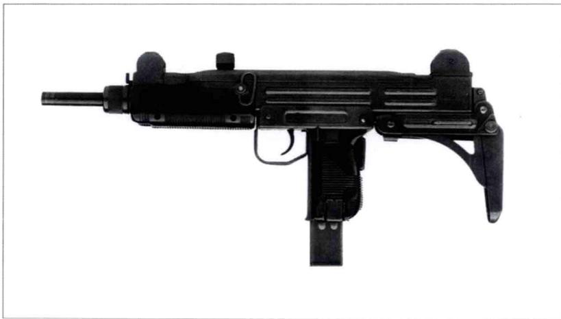
虽然以色列不再生产，但该枪仍是使用最广泛的现代冲锋枪，在世界各地随处可见，且并非总是在政府军人手中。比利时和南非曾得到许可生产乌齐冲锋枪，并被克罗地亚仿制。在克罗地亚，该枪被为ERO。乌齐冲锋枪采用的弹匣通过手枪式握把供弹，且枪机的前半部分与枪管重叠，以缩短全枪长度。它可以采用固定和折叠式枪托。其变型枪包括 Mini-Uzi (迷你乌齐) 和 Micro-Uzi (微型乌齐)，其中前者的尺寸缩小了很多，而后者是易于隐藏的微型型号。这两种型号都与标准型相似，自动方式也相同。
