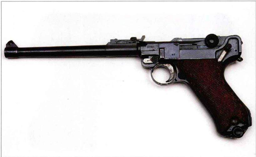
该枪在巴拉贝鲁姆 P'08 标准型的基础上配以长枪管和可调整照门，配发给支援部队的炮兵和骑兵，以取代其使用的卡宾枪。德国海军也有装备。“蜗牛”式弹匣性能不佳，现已很少与这种枪配用。炮兵和海军型号握把底部有镂空，用于安装木制枪托。图示为炮兵型。
