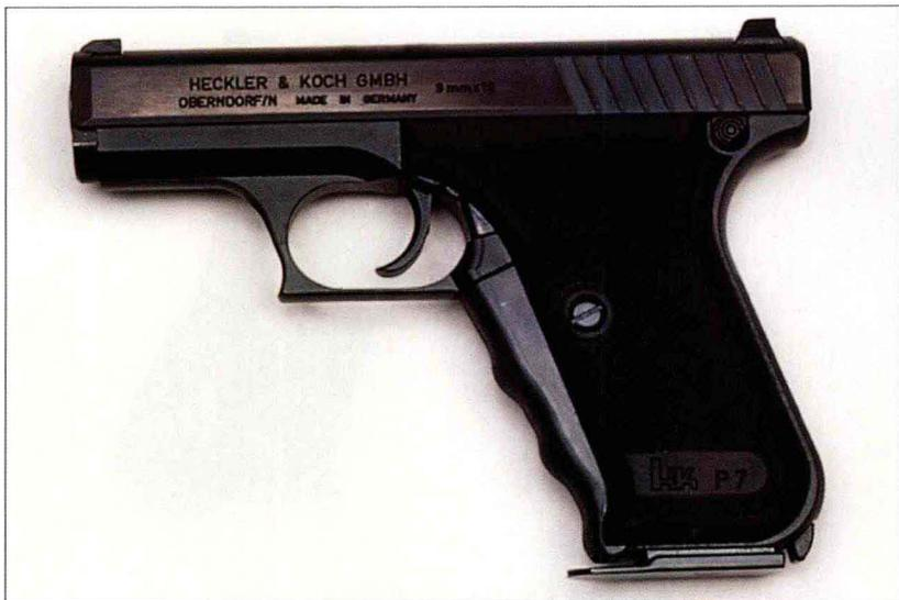
该枪专为满足德国警察的需要而设计，使用非常安全，射击前无须将枪置于射击状态。装备独特的握把保险，可将扳机与待击和发射机构咬合。射击时，只需手握握把并扣动扳机，手枪将待击并释放击针。当枪不慎掉落时，握把被松开，手枪即刻处于保险状态。该枪采用独特的气体活塞延迟系统，可在射击后减缓后膛的打开速度。
