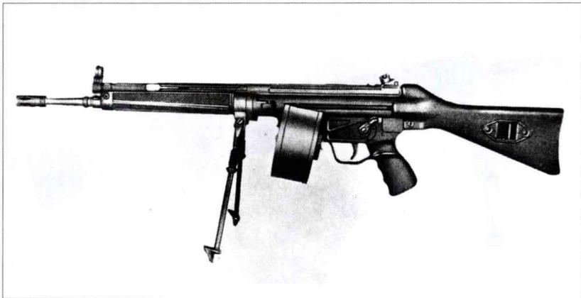
研发该枪旨在与充赫克勒 - 科赫 HK33 5.56 毫米步枪组合使用，它是最早的 5.56 毫米口径机枪之一。它与 HK33 步枪类似，但枪管更重，在提供火力持续射击时，可快速卸下并更换枪管。自动方式与 HK33 步枪相同，采用滚柱枪机延迟后坐系统；弹匣可与 HK33 步枪通用。HK13 是 5.56 毫米时代的早期产品，最初大部分销往东南亚国家。后来有一种改进型号 HK33E，其快慢机包含三发点射状态，还可更换弹匣槽和枪栓以使用弹链供弹。
