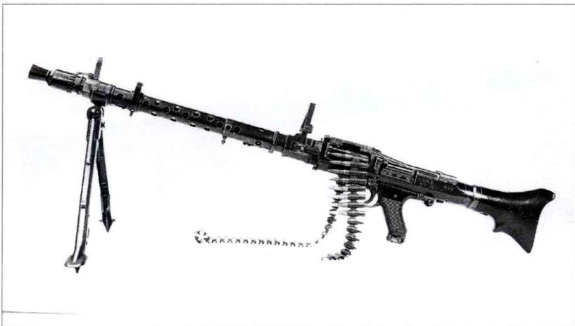
该枪最初称为索洛图恩 30 型，是瑞士于 20 世纪 20 年代研制的。索洛图恩 (Solothurn) 公司后来被莱茵金属公司收购，成为其研发和制造工厂，因为根据《凡尔塞条约》，这种生产在德国是不合法的。莱茵金属公司随后将 MG30 改造成了 MG34，并于 1936 年被德国陆军采用成为制式武器，直到被 MG42 取代。MG34 的一直生产到二战结束，该枪设计的卓越之处包括：只需按住机匣前端的卡销并旋转枪托便可将其拆下；直线型设计减轻了枪口在射击时的跳动；安装两脚架后可用作班用自动武器，而安装三脚架后可提供持续的火力支援。该枪开创了早期通用机枪设计的先河。
