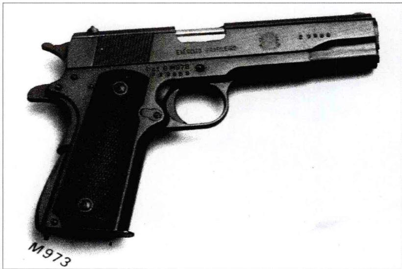
M973 最初实际上是以美国柯尔特 0.45 英寸 M1911A1 为原型生产的，后经改进使用 9×19 毫米巴拉贝鲁姆手枪弹，但仍称为 M973。1990 年再次进行改进，使用 0.38 英寸超级自动手枪弹，主要投放民用和海外市场，但有人认为它大量装备了警察和军队。这 3 种型号的大部分零件可互换。
