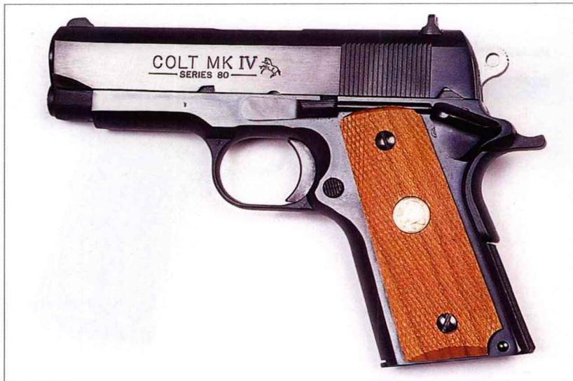
该枪为 0.45 英寸口径柯尔特 Mk IV 政府型手枪的紧凑型，其套筒缩短了 37.5 毫米，套筒座缩短了 10 毫米。标准型采用碳钢和不锈钢，而轻型采用铝合金，将枪重减少了 283 克，轻便小巧，便于隐藏，但仍可发射主流枪弹。
