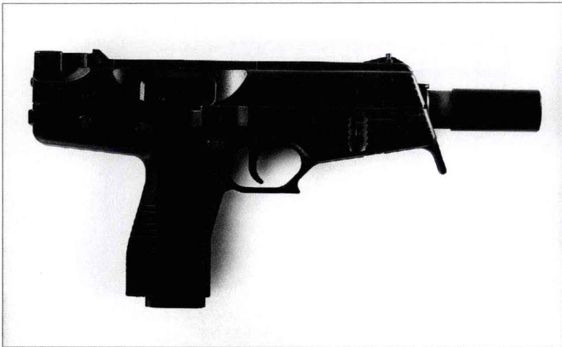
SPP(特种用途手枪)是TMP(战术冲锋手枪)的自动型,套筒座和套筒也使用合成材料制成,并采用延迟后坐式自动方式和枪管回转式闭锁机构。主要区别在于该枪无前握把,且暴露在套筒前面的枪管和护套更长。另一个突出特点是套筒座前面有向下延伸的短杆,双手射击时,不扣扳机的手可抓住它,以防射击时手指滑动。德国布鲁加·托梅(Brugger & Thomet)购买了该枪的生产权,因此枪身铭文目前标识该公司的名称。
