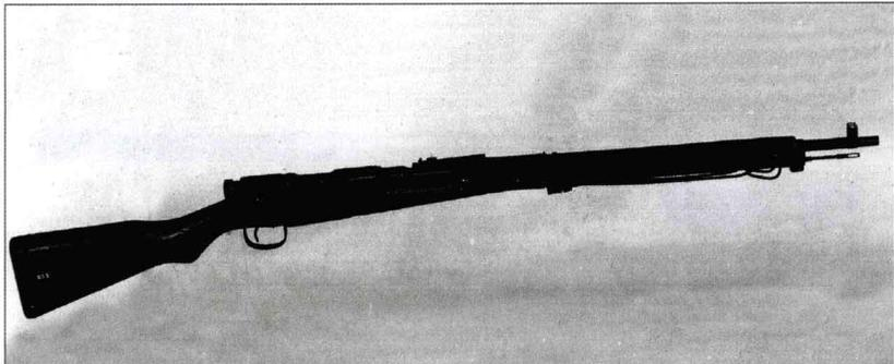
该枪最初是三八式步枪的改进型，发射7.7毫米枪弹，但过于笨重，最终改变了卡宾枪的设计思路，将设计改为短步枪。早期的型号制作精良，但二战后期的产品粗糙，保留下来的数量不多。“伞兵”型与该枪相似，但枪管和枪机之间通过间歇式螺纹或楔子连接，这样可将枪支拆成两部分。九九式的命名参照的是日本历法，即公元1939年。
