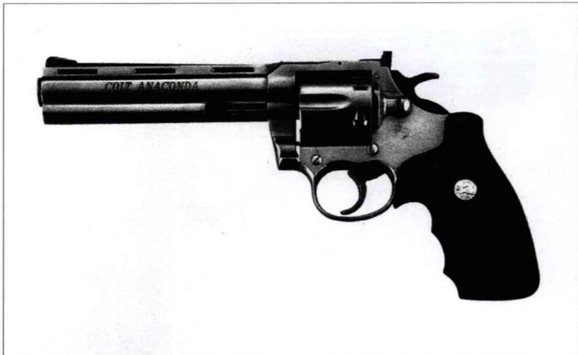
该枪为柯尔特家族中“个头”最大的双动型转轮手枪，采用全不锈钢设计，发射0.44英寸马格努姆转轮手枪弹。也有采用6英寸和8英寸枪管的型号，均发射0.45英寸柯尔特转轮手枪弹。
