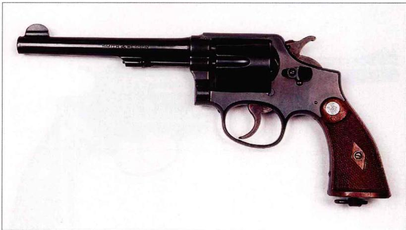
与 M1917 一样，该枪也是为满足英国军方在二战中的需求而设计的标准用枪。它与 M&P 的唯一区别在于使用的枪弹尺寸不同，它发射 0.38 英寸的 200 格令枪弹，也可使用 0.38 英寸史密斯-韦森标准枪弹和 0.38 英寸柯尔特新警用枪弹。该枪大约生产了 890000 支，早期型号使用 102、127 和 152 毫米（4、5 和 6 英寸）3 种不同的枪管。所有型号都经过烤蓝和抛光处理，采用防滑方格握把，并标有史密斯-韦森公司的雕饰图案。1942 年 4 月后，统一使用 127 毫米（5 英寸）枪管，采用磨砂烤蓝表面处理，握把为胡桃木制成。
