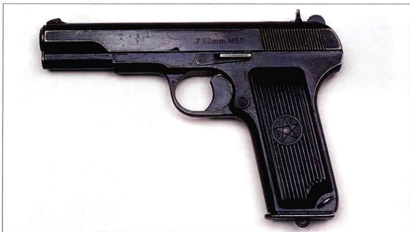
托卡列夫手枪 1930 年开始生产，采用勃朗宁下降式闭锁方式。其独特之处在于击锤、弹簧和其他部件包含在位于套筒座后部上方的一个可拆卸模块中。该枪的弹匣边缘切入套筒座内部，这样即使弹匣稍有变形也不会影响供弹。1933 年对该枪进行了改进，枪管周围都设有闭锁凸笋，而不只是在枪管上部有凸笋，这种改进更于快速生产，这就是 TT-33 型。该枪在二战期间没有大量投入使用，但后来它取代纳甘转轮手枪大量出口到很多前苏联等东方国家。中国、埃及、前南斯拉夫等国从 20 世纪 50 年代开始仿制，图示是前南斯拉夫 M57 型。
