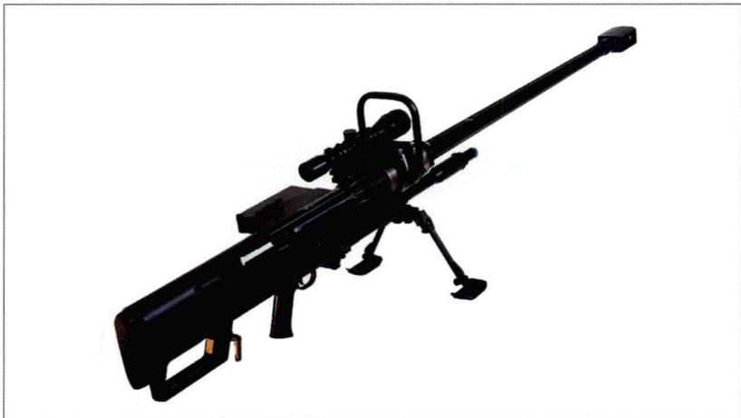
除尺寸外，NTW 20/14.5 反器材步枪有多个独特之处，其中之一是可发射两种不同口径的枪弹。它发射的较大的一种枪弹口径为  $20 \times 82$  毫米，这种枪弹通常被视为炮弹；另一种枪弹的口径为  $14.5 \times 114$  毫米，它是一种东方集团重机枪枪弹，使用 NTW 发射这种枪弹时，有效射程可达 1800 米。
