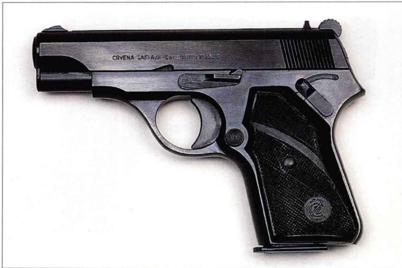
M70 式手枪以前称 CZ M10，它是 M47 式的缩小型，而后者是俄罗斯托卡列夫 T-33 的仿制品。对这种口径或发射 9 毫米短弹而言，无需闭锁后膛，该枪采用后坐式自动方式。套筒座上有手动保险，另外还有弹匣保险。该枪制作材料和抛光处理工艺都非常精良，在巴尔干半岛深受欢迎。
