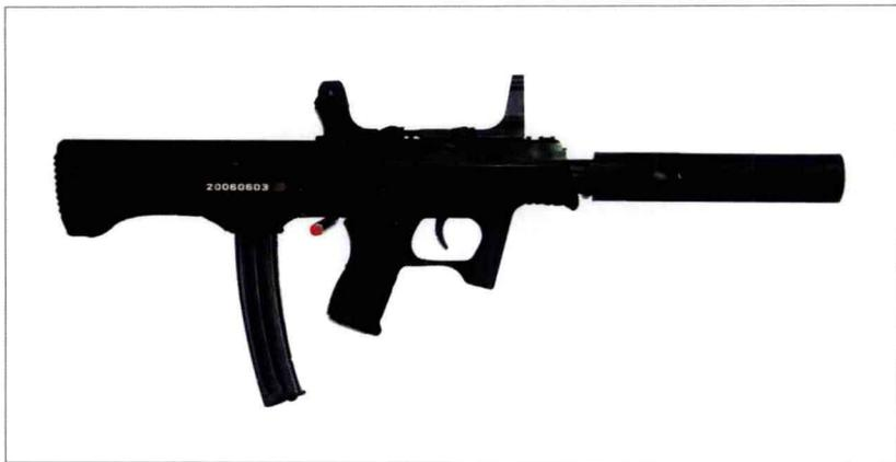
该枪采用无枪托设计，弹匣位于手枪握把后面以缩短武器的长度，通常还安装消声器。它采用枪机后坐式自动方式，有两种不同口径的型号。该枪采用模块化设计，下半部分包括手枪握把、扳机机构、前握把以及由合成材料制成的枪托。装备手枪握把保险，必须将其按入握把才能发射。顶部有瞄具导轨，可安装光学瞄具或夜视瞄准设备。
