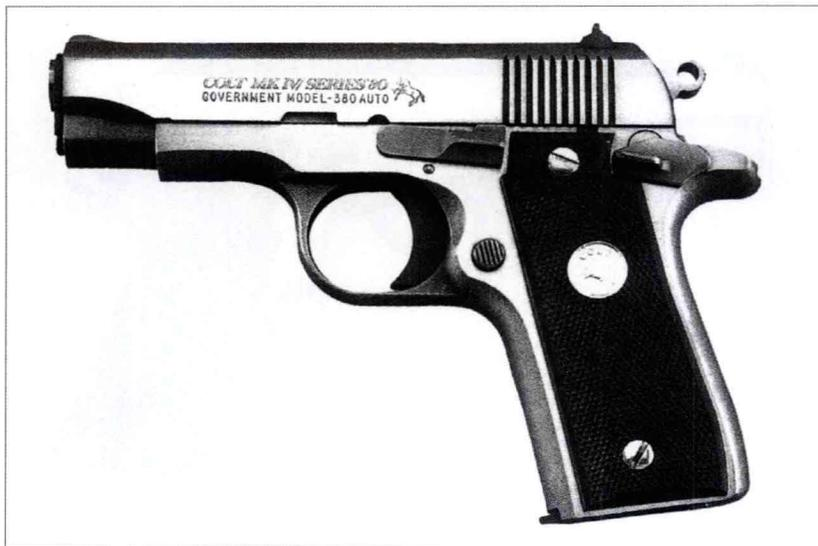
该枪由 0.45 英寸口径柯尔特 Mk IV 政府型演变而来，极大减小了套筒座、枪管和套筒的尺寸，但使用类似的枪机闭锁机构。该枪并没有使用与 M1911A1 相同的握把保险。0.380 英寸政府型的变型有很多种：套筒更短的 Mustang Plus II 型以及套筒和套筒座都更短的 0.380 英寸 Mustang。另外，还有采用铝合金套筒座的“袖珍型”系列，最重只有 418 克。
