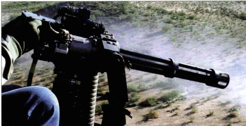
该枪是一款 6 枪管加特林型机枪，所有操作都是由机枪上的电动马达驱动完成的。绕中心轴旋转时，每根枪管都分别完成装弹、发射和抛壳动作，总射速高达 6000 发 / 分。该枪最初由通用电气公司于 1963 年制造，但几年前该公司停止了该枪的生产。现在，该枪的制造和设计由迪龙 - 埃罗公司负责，它对该枪的整体设计做了广泛改进，主要改进是内部构造，并将射速降低为 3000 发 / 分以提高可靠性。迪龙 - 埃罗要么改进现有的枪支，要么重新制造，并相应地修改枪身铭文。由于米尼冈 M134 需要电力，因此通常只能在车辆或飞机上使用。
