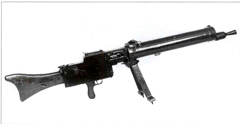
该枪的设计目的旨在给德国步兵提供比标准 MG' 08 机枪更便携的无底座机枪，它提供了轻型两脚架、肩托和手枪握把，并重新设计了机匣以降低重量。该枪仍采用布制弹链，但弹链特别短，可缠绕起来并装在盒子中，再挂在机枪侧面。位置固定时，该枪可使用 250 发标准弹链。该枪还有用于飞机上的型号，采用穿孔管套而不是水冷管套，并依靠气流冷却枪管。
