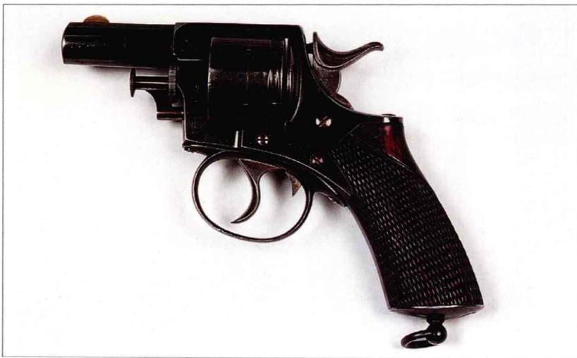
该枪为系列化的转轮手枪，而非单款手枪。由韦伯利设计，最初作为微型个人自卫武器，后被欧洲尤其是比利时制造商大量仿制。所有型号的外观都相同：双动式设计，握把粗大，枪管短粗，枪管外形多为椭圆形，但也有圆形和八角形的。口径通常为0.44英寸或0.45英寸，0.380英寸口径也较为多见。有些欧洲型号使用10.6毫米德国枪弹和类似的米制枪弹。
