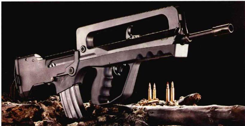
这款外观古怪的武器为法国制式步枪，也是第一款采用无托结构并进入军中服役的步枪。该枪的延迟后坐系统采用由两部分组成的枪栓；为避免抛壳困难，枪膛内开了一个槽，因此通过纵向痕迹很容易辨别该枪发射的枪弹。该枪操控性好，射击准确，还可挂榴弹发射器。另外，存在一种发射0.22英寸边缘发火弹的训练型，它看起来与制式武器十分相像。1994年，新的F2型采用大尺寸扳机护圈取代了原来小巧的扳机护圈，并采用北约标准弹匣槽，以便使用M16弹匣，如图中所示。值得注意的是，尽管所有的5.56毫米枪弹都可用于该枪，但仅当使用法国制式枪弹才能获得最佳性能。
