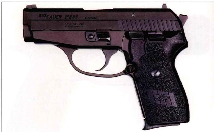
西格-绍尔 P239 枪族主要针对美国市场，包括三个口径各不相同的成员，它们分别发射 9×19 毫米巴拉贝鲁姆手枪弹、0.40 英寸史密斯-韦森手枪弹和 0.357 英寸西格手枪弹。除口径不同外，它们基本上与 P229 手枪相同，只是在套筒座左侧、扳机后方添加了待击解脱杆。枪弹上膛后，待击解脱杆可将击锤锁定在前面，随后只需扣动扳机便可射击。除此之外，P239 还比 P229 苗条。
