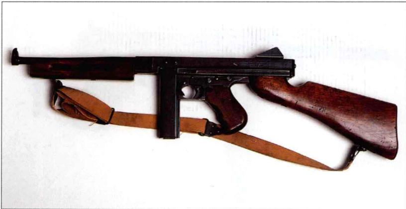
该枪是第一款冲锋枪，因为“冲锋枪”一词是由汤普森发明的，虽然该枪并非最早服役的冲锋枪。直到1921年才面世，远在伯格曼和伯莱塔之后。1928年的型号与1921年型号基本相同，但枪机做了细微的改进以降低射速。最初的汤普森冲锋枪采用“布里希”闭锁机构，生产起来过于复杂且成本较高，二战期间对其进行了重新设计，并生产了M1和M1A型号，但相对于其发射的枪弹而言，仍过于笨重。
