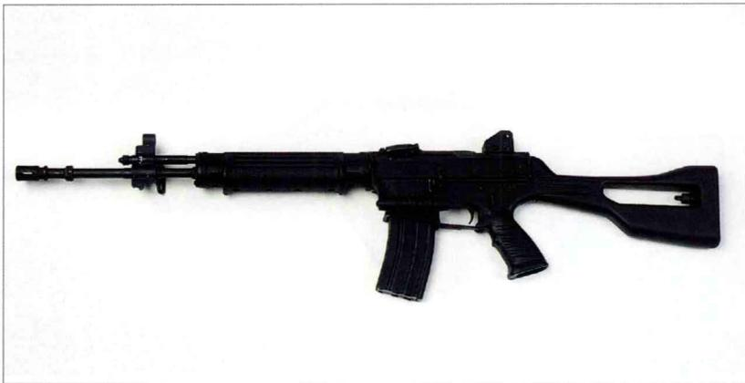
该枪是SR88的改进型，除外形结构有明显差别外，工作机理完全相同。下机匣用铝合金锻造而成，上机匣用优质钢板冲压而成，枪托、前护木、手枪握把都采用玻璃纤维增强尼龙，固定枪托挖去了一部分以降低重量和增加强度。枪管通过防松螺母和卡销固定在机匣上，可方便在战场上更换枪管。枪管用优质钢锤锻而成，枪膛镀铬。还有卡宾枪型，其枪管较短，供伞兵部队和其他需要紧凑步枪的军事单位使用。
