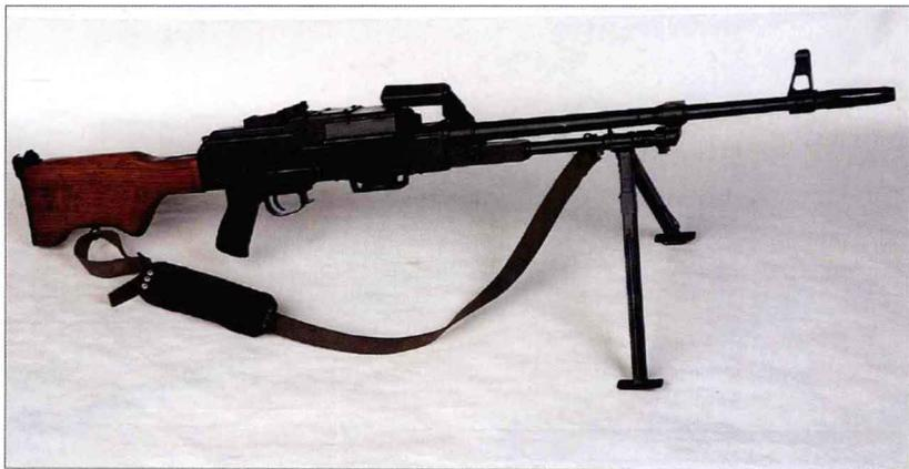
PK 是前苏联军队使用的第一款通用机枪，它取代了 RP46。该枪结合使用卡拉什尼科夫闭锁机构和新型供弹机构，轻便且制造精良。该枪有几种变型枪：PK 是基本的连用机枪；PKS 是采用三脚架的营属支援武器；PKT 为坦克用机枪，没有手枪握把和枪托。PKM 系列是后来开发的减轻型，当前波兰和保加利亚还在生产，但使用 7.62 毫米北约制式枪弹。图示为塞尔维亚生产的变型枪 M84。与前苏联设计的其他枪支一样，在所有前华沙条约国家都能发现 PK 枪族的身影。除在俄罗斯生产外，PK 机枪还被许可在保加利亚、中国（80 式）、哈萨克斯坦、波兰、塞尔维亚和罗马尼亚生产，从铭文可以获知枪支的原产国。
