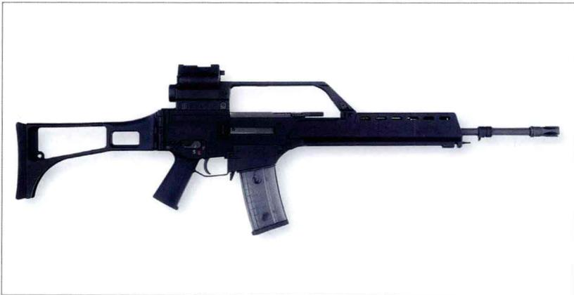
当 G11 计划失败时，德国陆军并无符合北约标准的 5.56 毫米口径步枪，经过迅速的对比实验，德国陆军最后选择 G-36 作为新的制式步枪。在这次设计中，赫克勒-科赫公司放弃了久经考验的回转式枪机闭锁延迟后坐系统，而采用导气式回旋枪机。该枪的整体设计仍采用传统布局，枪管下方有活塞筒、手枪握把、弹匣和管状可折叠枪托。抬高的瞄准具座位于机匣后方，可安装 3 倍光学瞄准镜，整体式提把贯穿瞄准镜座和机匣前端。设有采用瞄准线设计的照门瞄准孔，拉机柄位于提把下方，必要时可帮助枪机闭锁。
