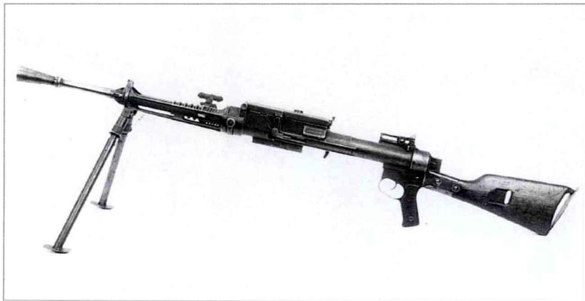
该枪是意大利在 20 世纪 30 年代制造的极其专业而独特的机枪，其独特之处在于供弹系统：弹匣是位于机匣右侧的盒子，可将其卸下并挂在前面，让副射手使用弹夹给弹匣装弹，再将弹匣复位，而移动枪栓将枪弹逐颗上膛。这种设计的优点是，弹匣和弹夹的制作都可非常精良，与钢制弹匣相比，卡弹的可能性更低。然而，如果弹匣出现问题，机枪便无法使用；另外，装弹过于缓慢，这极大地降低了实际射速。另一个独特之处是：虽然其枪管可快速更换，但没有提把，因此如何卸下发烫的枪管将是个有趣的过程。
