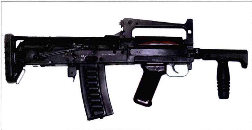
OTs-14 “暴风”是一款紧凑型无枪托突击步枪，是前苏联解体后为俄罗斯特种部队研制的枪型。它采用模块化设计，可在枪管下方安装榴弹发射器或消声器，还可根据不同的战术情况更换长度不同的枪管。在步枪顶部的提把/机械瞄具上或机匣左侧的标准俄罗斯瞄具支架上可安装光学瞄准镜或夜视装置。最初有四种口径的型号，但只有7.62毫米和9毫米型号被采用为制式步枪。
