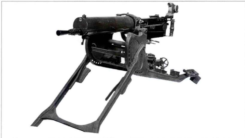
该枪是一款经典的马克沁枪管后坐式机枪，基本上与同时期的其他马克沁机枪一样：笨重并采用水冷方式，但MG' 08安装在独特的四脚底座上，底座可折叠以便移动机枪。该枪使用肘节式闭锁机构：枪管和节套同时后坐，直到节套上的闭锁突笋与机匣壁上的突笋扣合，枪机闭锁，复进簧使节套向前运动以装填枪弹并射击。MG' 08是一款性能优良的武器，一战表明只要有冷却水和充足的枪弹，它可连续射击数小时。该枪一直是德军的标准重型机枪，一直持续到20世纪30年代中期；还有很多一直服役到1945年。
