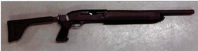
该枪是一款导气式半自动霰弹枪并采用独特的工作原理，因其取得的巨大成功而被美国特种部队用于中美洲的禁毒行动，因此俗称“丛林枪械”。M9200A1 是民用型的 M9200 的军用型，对机械系统做了改进，可在不调整机械系统的情况下发射各种枪弹，从最重的枪弹到非致命性枪弹。该枪可能使用固定枪托和折叠式枪托，有些枪型没有枪托而只有手枪握把。
