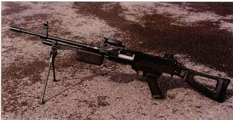
该枪击发后，火药燃气驱动活塞向后运动，活塞上的突柱进入闭锁块上的凸轮槽，使闭锁块偏转，接着向后运动抛出空弹壳。在此期间，闭锁块顶部的突柱带动受弹机盖上的拨弹臂，将弹链输到半节；复进时，弹链再运动半节，闭锁块将枪弹送入枪膛。最后，活塞驱动闭锁块偏转进入机匣壁上的闭锁卡槽，然后活塞撞击击针击发枪弹。枪管可快速更换，外壁上有凹槽，既可减轻重量，又可增大散热面。还配套开发了一系列部件，可用于改装 SS77 以发射 5.56 × 45 毫米枪弹。最近开发了口径为 5.56 毫米的产品，称为“迷你 SS”。
