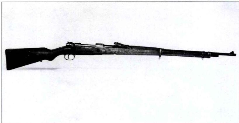
毛瑟公司为很多国家生产过众多军用步枪，但绝大多数都是该枪的变型枪。这款优秀的毛瑟步枪在德国陆军服役了半个世纪，它射击准确、性能可靠、坚固耐用、制造精良，还将服役多年。格韦尔 98 是在毛瑟基本步枪基础上改进而来的，枪栓下方添加了第三个闭锁突笋，将枪机锁定在弹匣后方的机匣内。拉机柄向右倾斜，操控起来比较麻烦，1904 年为适应自行车部队的需要采用下翻式枪栓，但不常见。
