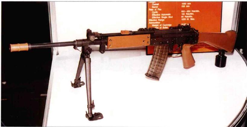
该机枪是由 INSAS (印度轻武器系统) 突击步枪改造而成的轻机枪, 加重了枪管。它采用导气式工作原理和枪机回转式闭锁机构, 可单发射击和连发射击。其枪管比步枪重并经镀铬处理, 膛线与步枪不同以改善远距离射击时的弹道性能, 有效射程可达 1000 米。枪口符合北约 22 毫米制式标准, 可发射榴弹, 还可安装刺刀。二战期间, 印度生产的布伦机枪和维克斯-伯希尔机枪安装了两脚架。INSAS 轻机枪已批准称为印度陆军的制式武器。
