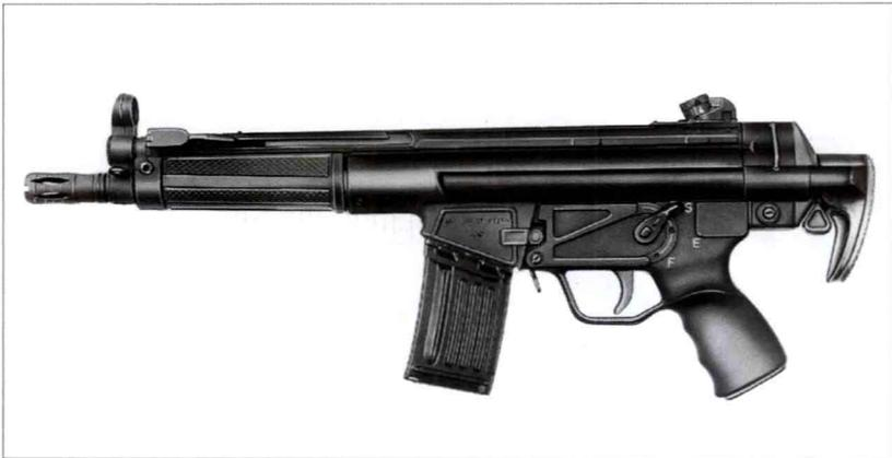
该枪常被视为冲锋枪，但鉴于它发射步枪弹，因此将其归为短突击步枪更合适。为尽可能紧凑并发射 5.56 × 45 毫米枪弹，该枪除像其他赫克勒-科赫枪支那样使用滚柱后坐式闭锁机构外，还采用伸缩式枪托，枪管只有 211 毫米，因此必须安装高效的消焰器。这款武器被大量生产，装备世界各地众多的特种部队和警察部队。
