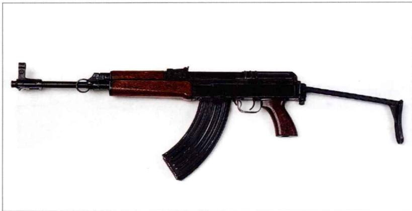
尽管该枪外形类似于卡拉什尼科夫步枪，但实际上两者完全不同。该枪采用标准的捷克设计，但发射标准同前苏联制式枪弹。采用导气式设计，枪机和枪匣采用与瓦尔特 P38 手枪类似的垂直锁定。活塞气压推动枪机框后退并抬高卡销，进而打开枪栓。该枪有两种型号：VZ58p 采用固定枪托，而 VZ58v 采用金属折叠枪杆，二者枪口都装有消焰器，枪管下方有两脚架。
