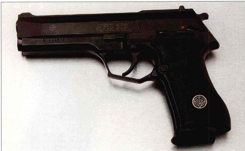
该系列有两种型号：SP1 和 SP2，其中前者发射 9×19 毫米巴拉贝鲁姆手枪弹，SP2 配用 0.40 英寸史密斯-韦森手枪弹。两型号都采用与瓦尔特 P38 和伯莱塔 92 一样的下降式闭锁方式；采用钢制套筒和合金套筒座，设有全自动击针保险及手动保险。SP2 有许多可更换部件，包括枪管、复进簧和弹匣，从而使其可发射 9×19 毫米巴拉贝鲁姆手枪弹。
