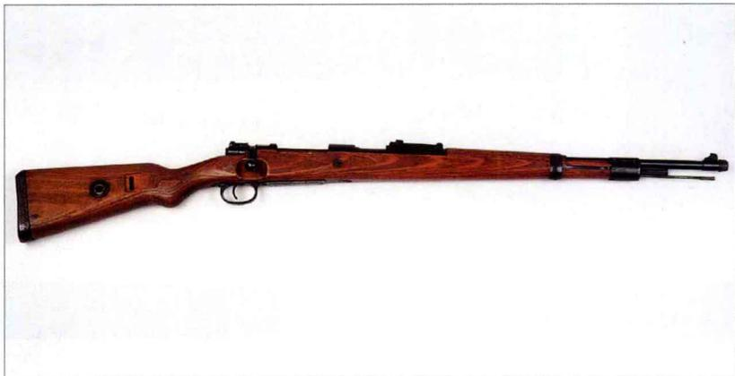
该枪是格韦尔 98 步枪的缩短型，在二战期间研制，缩短了长度，且为方便抓握采用嵌入在木制枪托中的旋转枪栓，因此立即得到了重视。1942 年~1945 年间生产的步枪质量通常不佳，如采用薄金属片制造枪管卡箍和扳机护圈，而枪托和护木采用胶合木材料。但由于枪栓、枪管和枪机的质量并没有下降，因此射击精度依然很高。在 10 年间，该枪大约生产了 115 万支，因此在未来的一段时间内仍将存在。
