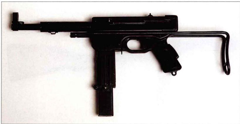
该枪取代了玛斯 38 冲锋枪，所发射的枪弹更实用。该枪设计非常紧凑，其弹匣槽和弹匣都可向前折叠到枪管下方，使得携行更加方便。在法国军队，该枪在一定程度上被法马斯 5.56 毫米步枪所取代，但仍在预备役部队、警察和其他准军事力量中广泛使用。在法国的前殖民地也可见到该枪的踪影。
