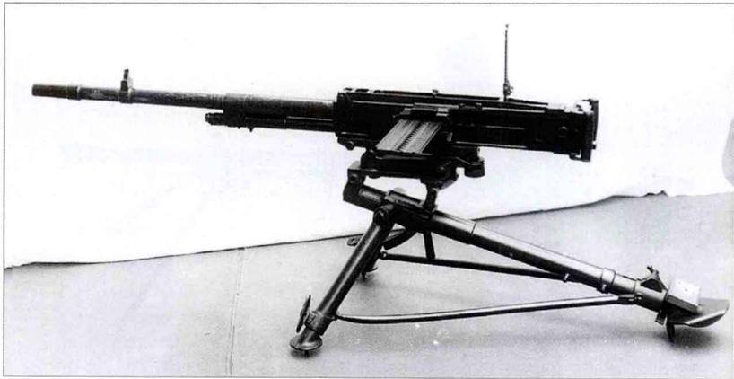
该枪是意大利军方在 1937 年~1945 年配备的制式重型机枪。它有一些独特之处，枪弹在上膛前必须先抹油润滑，以防射击后弹壳粘在枪膛上，这种情况在其他机枪上也出现过。布雷达机枪使用金属弹条供弹，机枪从金属弹条取下枪弹、发射并将空弹壳放回弹条，再填装下一颗枪弹。采用这种设计的原因不详，这看似不错，但疲惫的机枪手在重新装填前，必须先卸下弹条中的所有弹壳。尽管如此，该枪还是凭借其可靠的性能而深受欢迎。
