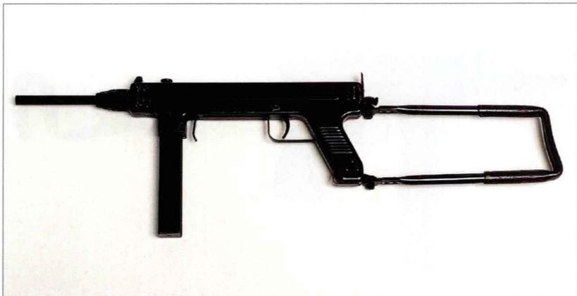
该枪的独特之处在于其蛤壳式机匣，由两片冲压件在后端链接而成。如果卸下枪管的连接螺母和枪管，将可像打开书本一样打开机匣，从而露出里面的零部件。拉机柄实际上是位于机匣上方的一块铁片，两边有翼片，可抓住这两个翼片并后拉。1946年曾装备丹麦军方，并出售给一些南美国家和泰国。1950型与之相似，但拉机柄呈圆钮状，位于机匣上方。
