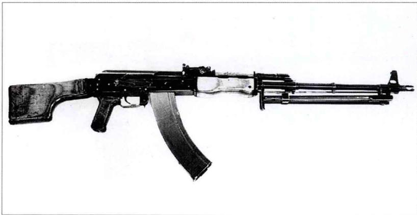
RPK-74 之于 AK-74 步枪犹如 RPK 之于 AK-47 步枪，换句话说，它是口径为 5.45 毫米版本的重型枪管班用自动武器。前苏联决定采用 5.45 毫米枪弹后，生产使用这种枪弹的轻自动武器便是迟早的事，但直到 1980 年西方世界才得知该武器的详细情况。可能前苏联在研发能够连续发射 5000 发枪弹的小口径机枪时似乎也遇到了问题。该枪有 4 种型号：RPK-74 为基本型；RPKS-74 使用折叠枪托；RPK-N3 在机匣左侧加装可安装电子夜视装置的底座；RPKS-N3 在可折叠枪托型上安装电子夜视装置底座。
