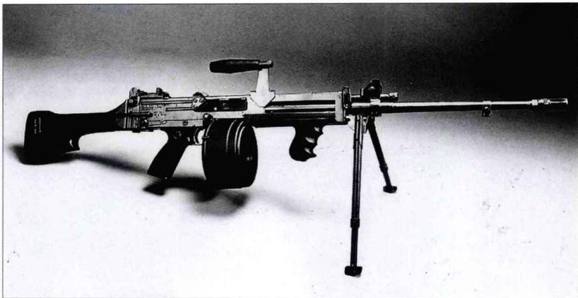
阿尔蒂马克斯机枪由新加坡特许工业公司研制，与 SAR-80 5.36 毫米步枪配合使用。不幸的是，新加坡特许工业公司没有抓住时机，在 FN 米尼米面世后一段时间才推出阿尔蒂马克斯机枪，结果是原本可能选择阿尔蒂马克斯的几个武装部队已承诺购买米尼米。阿尔蒂马克斯是一款非常优秀的武器，射击时尤其舒适，因为它使用了长行程枪机和缓冲系统，将后坐力降到了极低的水平。该枪可使用弹盘或弹匣供弹，并使用现在非常普遍的枪机框以及由气体活塞驱动的回转枪机。该枪现装备新加坡武装部队，并在有些军队中获得了很高的评价。它的身影还曾出现在 20 世纪 90 年代的波斯尼亚内战中。
