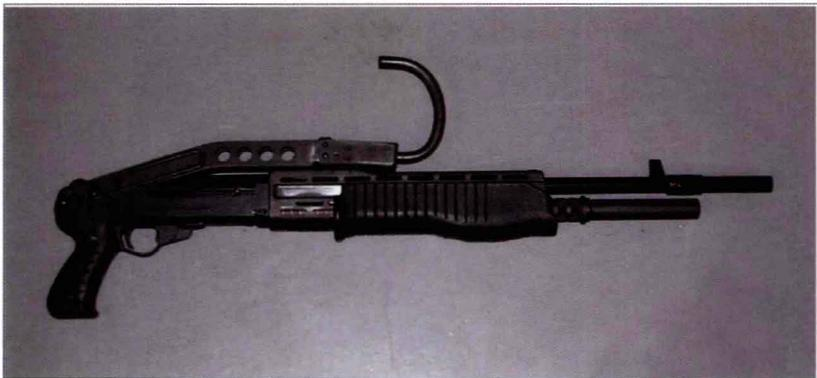
弗兰基特种用途自动霰弹枪 (SPAS) 12 式是使用最广泛的霰弹枪之一, 其用途极广。根据前护木的位置, 该枪可采用半自动或滑动 (泵动) 式射击方式以发射各种枪弹。该枪坚固耐用, 大量使用坚硬的灰色聚合材料和耐用的表面涂饰。其独特之处是可使用折叠式枪托, 这种枪托尾部有一个大钩, 将其钩住前臂可透过车窗实施单手射击, 但这样做的射击精度值得怀疑。SPAS 12 还可使用实心塑料枪托。
