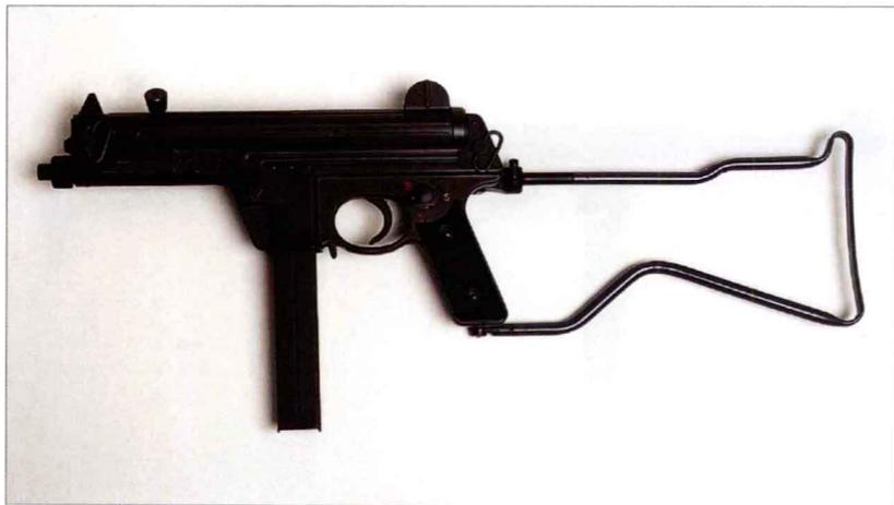
MPK 和 MPL 是二战后生产的枪型，它们实际上是同一种武器，只是一个枪管长 (L)，一个枪管短 (K)。MPL 的枪管长 260 毫米，全枪长为 749 毫米。尽管性能优良、表现卓越，但该枪并没有被任何军队采用，只是在 20 世纪 60 年代被德国的一些海军部门和其他欧洲国家的警察部门使用过。后来研发出了装有消声器的型号，但显然也没有吸引多少客户。
