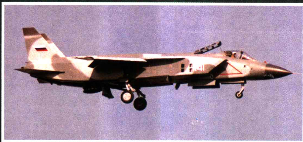
雅克-141“自由式”是世界上第一架超音速“短距起飞/垂直降落”战斗机，图中，一架雅克-141正在悬停，它的升力发动机的进气口打开着，同时喷管的方向转向地面。
