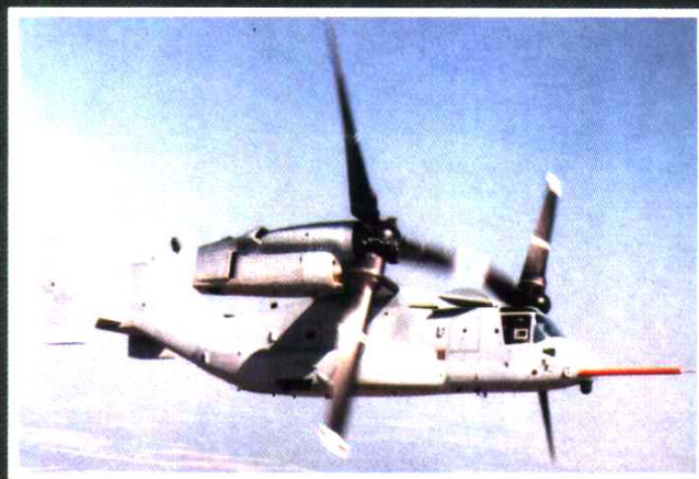
V-22“鱼鹰”向前飞行时，旋翼成了大直径的螺旋桨。
