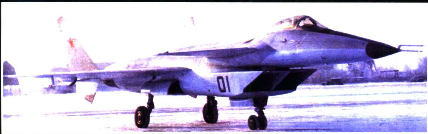
为了不被敌方防空雷达区发现，米高扬设计局的多功能战术战斗机——MFI1.44 穿了一件“等离子外套”。
