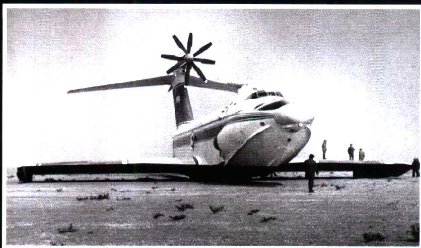
A-90 中型海军运输地效飞行器，地效飞行器起飞时由专门的喷气发动机提供升力，平飞时则使用涡轮螺旋桨发动机。
