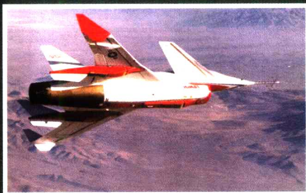
1/2尺寸的高机动航空技术（HiMAT）验证机由Rockwell公司制造，专门用于探索未来无人战机的机动能力极限。
