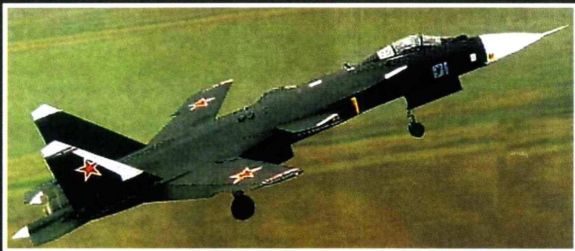
与西方第四代战斗机的设计哲学相对应的是俄罗斯苏霍伊设计局S-37前掠翼概念机。
