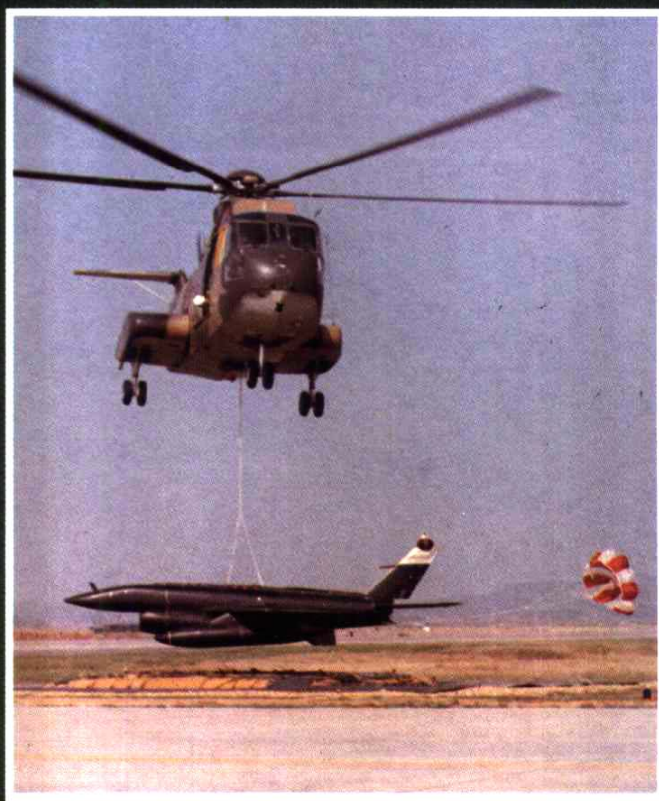
美国空军的CH-3直升机正在回收一架刚执行完对北越侦察任务的Firebee无人飞机。
