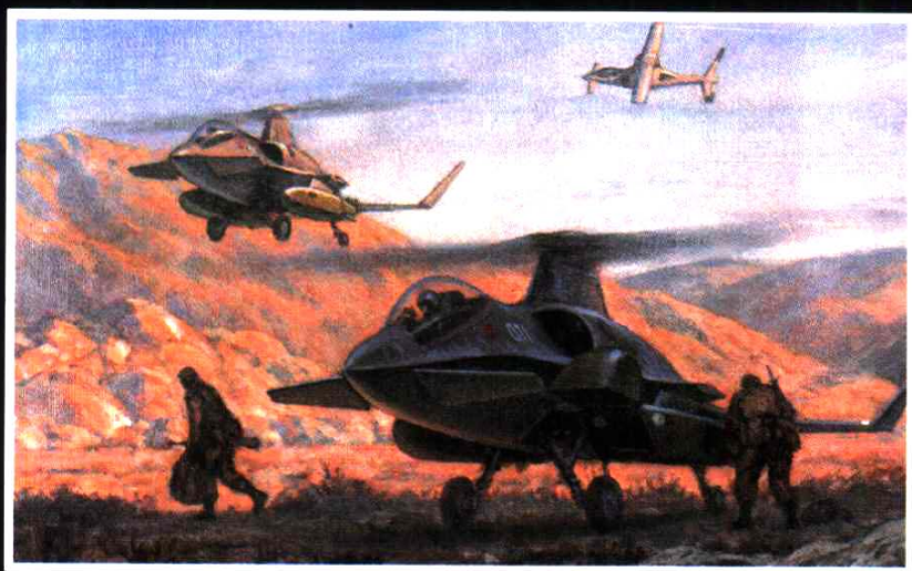
波音公司开发的“鸭翼加旋翼”概念结合了垂直起降的能力和固定翼飞机高速飞行的特点。
