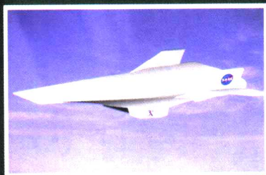
这是由波音幽灵工厂研发的Hyper-X的模型，它使用超音速冲压喷射发动机。
