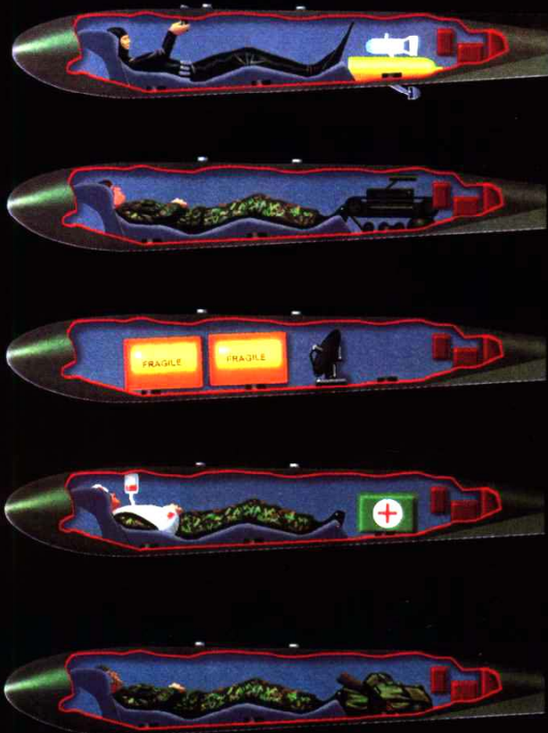
EXINT舱的主要用途：特种部队潜入敌后、装备前送、医疗救护和地面人员运送。
