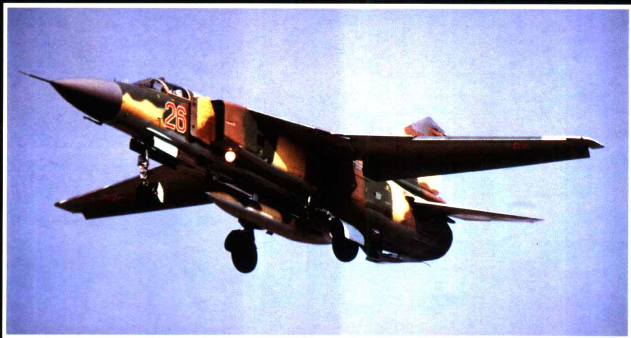
与F-111同时代的米格-23，是苏联开发的大量可变掠翼飞机的第一种。
