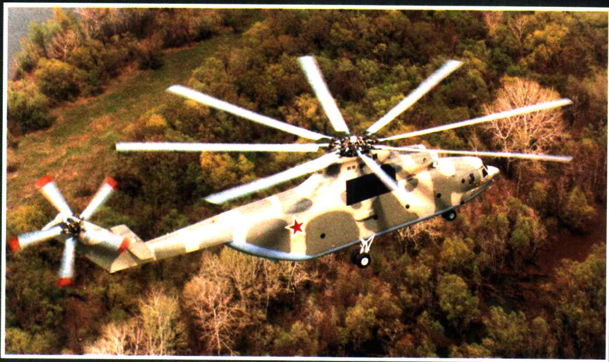
俄罗斯的米-26直升机是世界上在飞的最大直升机，旋翼直径长105英尺。
