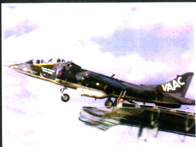
英国国防部研究局正在利用一架双座的“鹞”T.4飞机为“联合打击战斗机”计划进行短距起飞/垂直降落的试飞。
