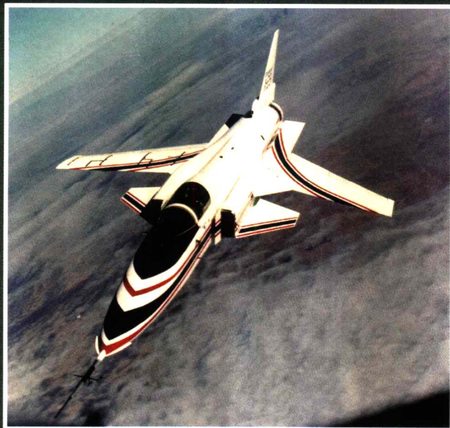
由格鲁曼公司研制，用于验证前掠翼概念在机动和低速操纵方面性能的X-29A是NASA最成功的研究飞机之一。
