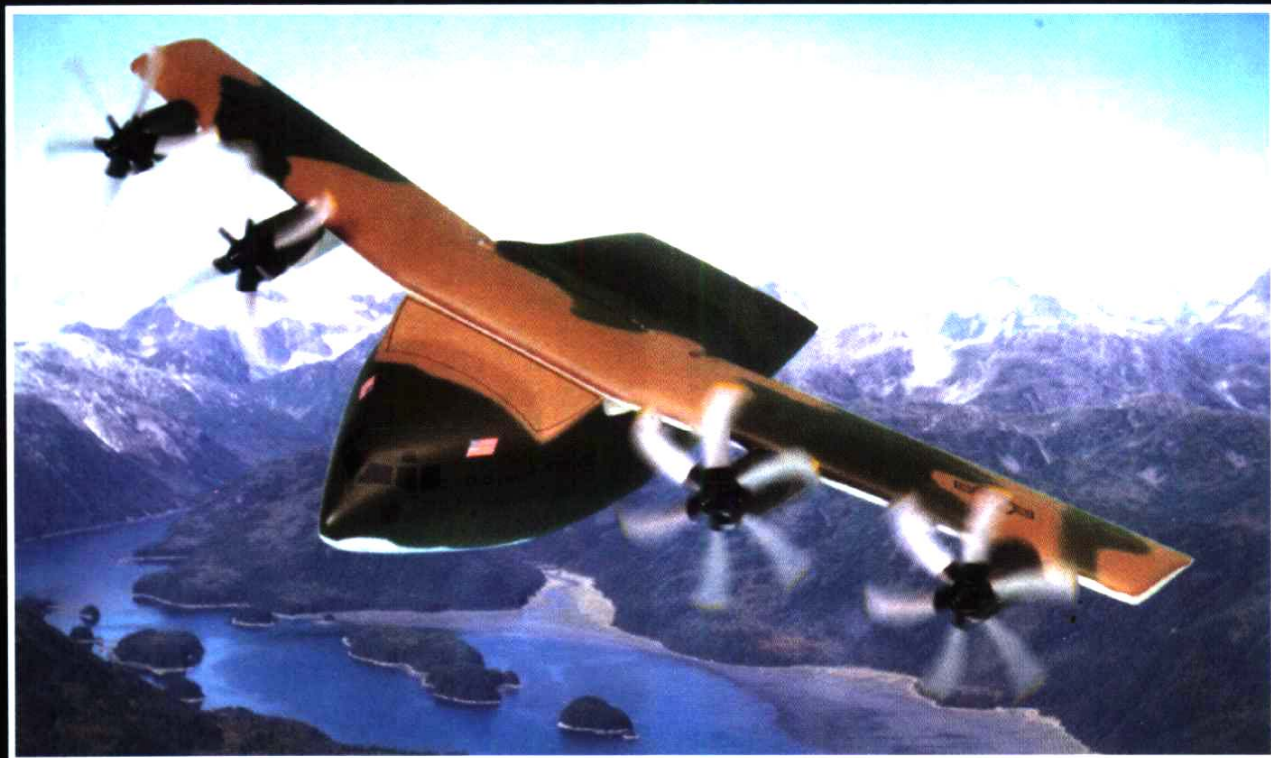
波音公司提出了一个超短距起降的“无尾翼先进战区运输机”(NOTAIL ATT)概念,即“超级蛙”倾转旋翼机。
