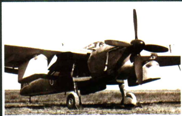
二战期间，英国海军的Barracuda鱼雷轰炸机的机翼挂有两个载人救援舱。
