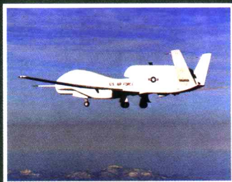
“全球鹰”，即将加入美国空军的先进无人侦察机，翼展116英尺，连续飞行时间达40小时。
