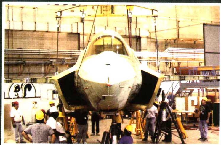
正在帕尔姆代尔组装的X-35联合打击战斗机的原型机，旁边是著名的“臭鼬”标识。
