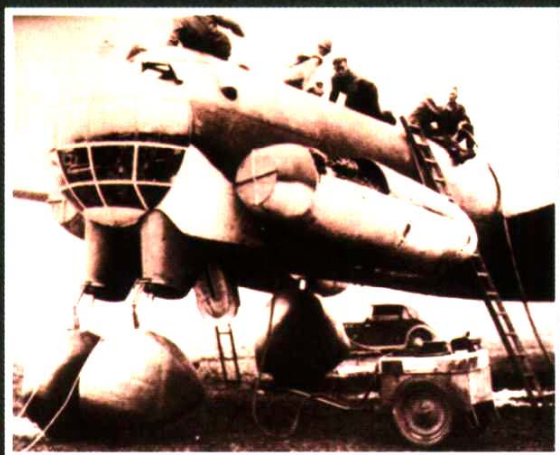
德国在二战末期研制的前掠翼Junkers 287后来在苏联进行了试飞。
