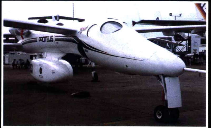
挂载着通讯设备的HALO类飞机已成为10英里高空的高效益专门化通讯平台。
