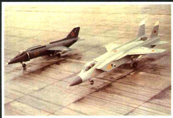
俄罗斯雅科夫列夫设计局曾经设计过不少成功的短距起降飞机，包括图中的雅克-38（左）和雅克-141。
