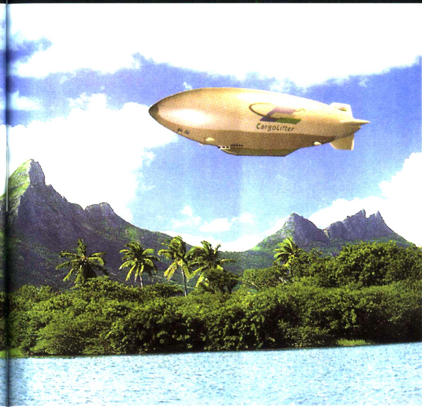
载重量高达160吨的CL160飞艇是一种理想的军用运输工具，德国和美国将生产这种飞艇。
