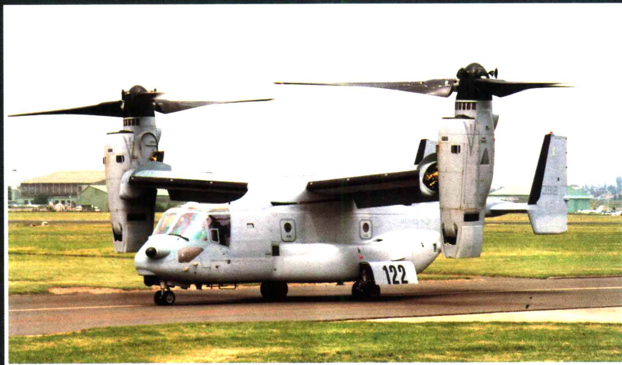
装备两台涡轮发动机的V-22“鱼鹰”是贝尔公司50年前开始研究这一概念以来第一架实用的倾转旋翼机。
